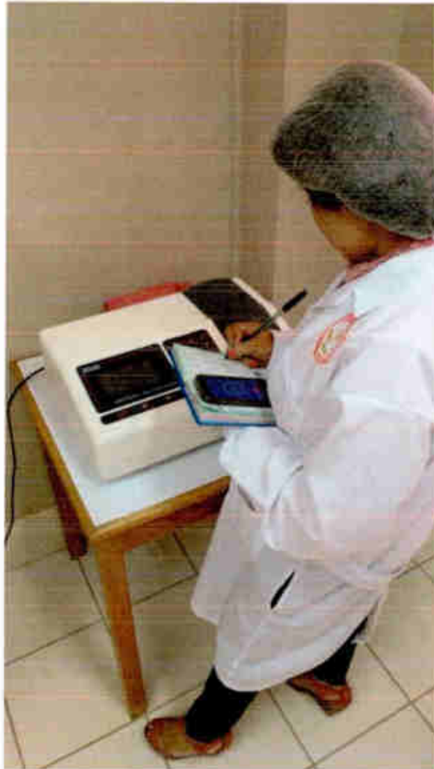
Figura 2. Lectura de la absorbancia de las muestras en el espectrofotómetro.
