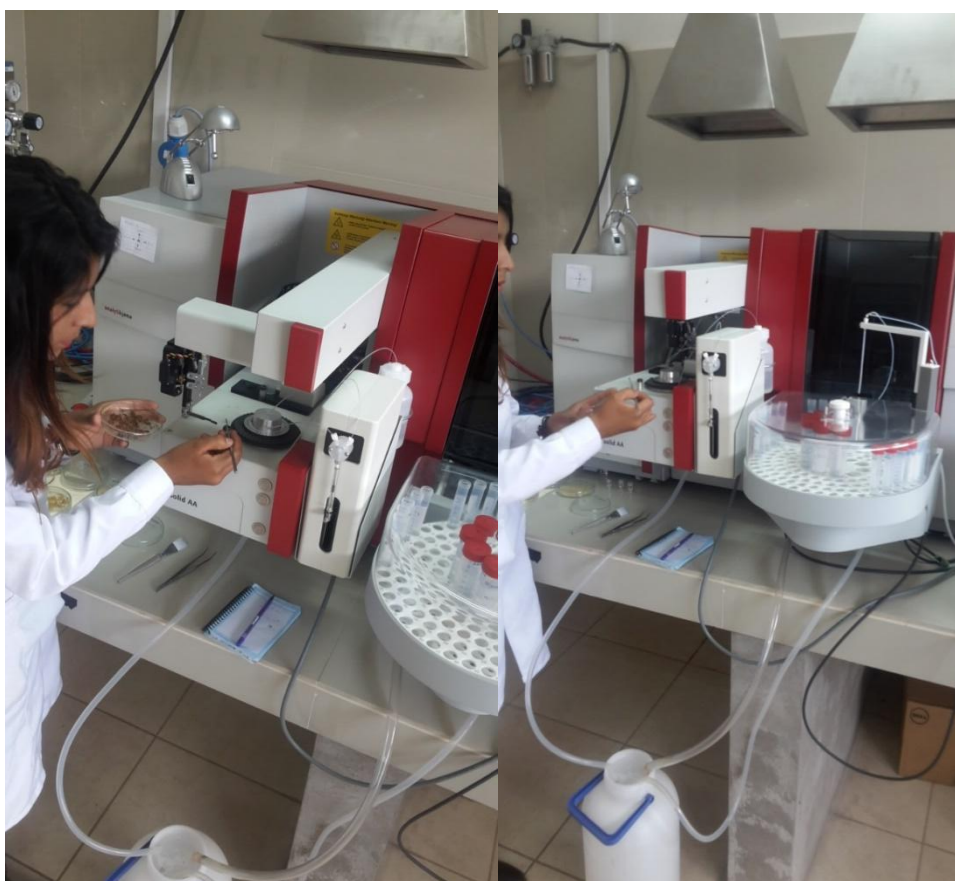
FOTO 15: ACONDICIONADO Y ALIMENTACIÓN DE LA MUESTRA AL ESPECTROFOTÓMETRO DE ABSORCIÓN ATÓMICA.
