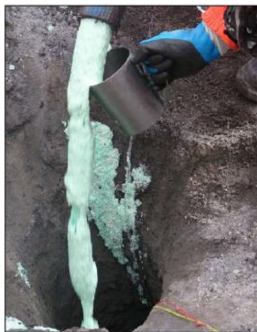
Fotografía 3-15 y Fotografía 3-16: Toma de muestra explosiva (Fortis Extra 65/35) en vaso volumétrico. Fuente: Asistencia Técnica (ORICA) “Las Bambas”.
