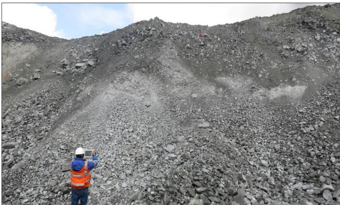
Fotografía 3-23: Toma de muestras en frente de carguío con el equipo “Porta Metrics”. Fuente: Asistencia Técnica (ORICA) “Las Bmabas”.
