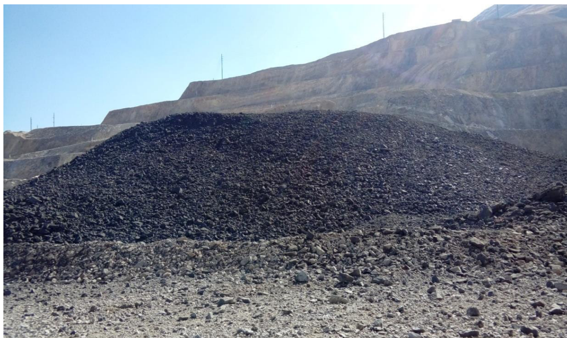
Fotografía A-35: Resultados Fragmentación de rocas con emulsión gasificada.
