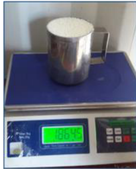
Fotografía 2-11 y Fotografía 2-12: Densidad de la mezcla explosiva “Fortis Mex 60 (HA 64)”. Fuente: Asistencia Técnica (ORICA) “Las Bambas”.
