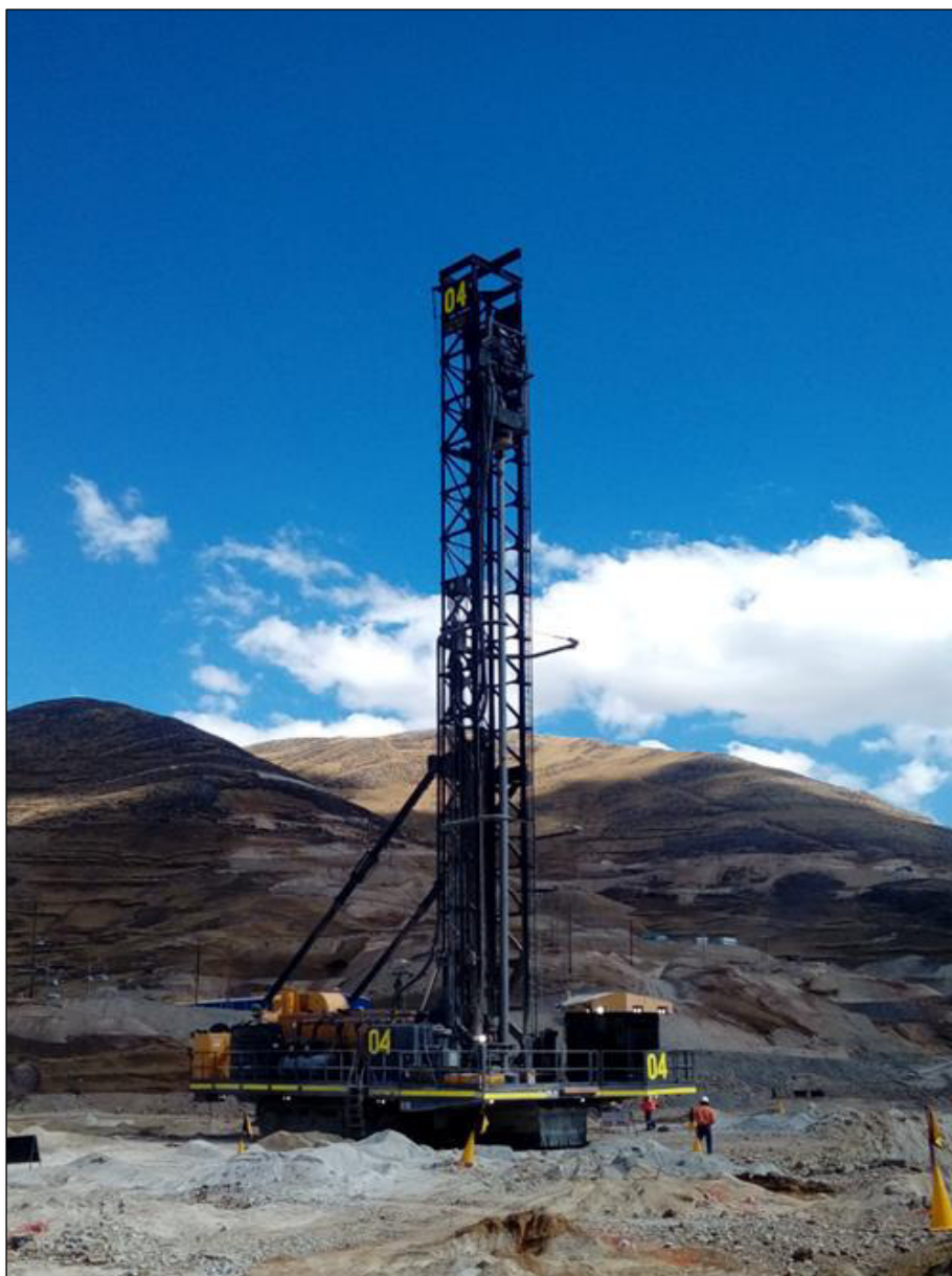
Fotografía 2-3: Perforadora P&H 250 XP.
