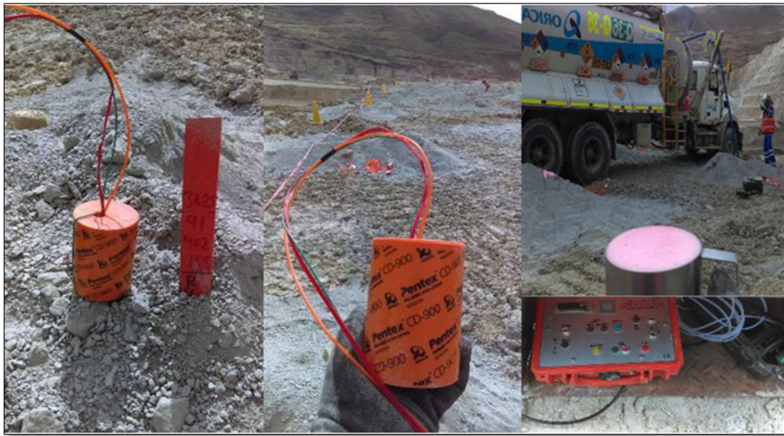
Fotografía 3-21: Instalación de cable resistivo (verde) junto al booster y líneas descendentes. Fuente: Asistencia Técnica (ORICA) “Las Bambas”
