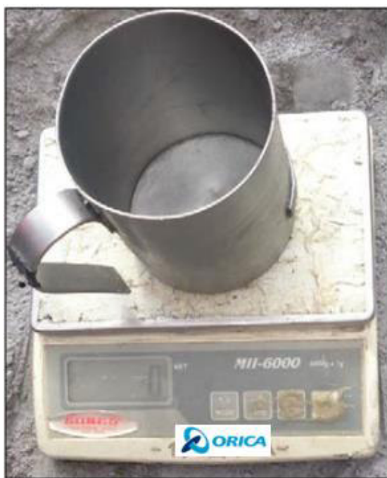
Fotografía 3-15 y Fotografía 3-16: Toma de muestra explosiva (Fortis Extra 65/35) en vaso volumétrico. Fuente: Asistencia Técnica (ORICA) “Las Bambas”.
