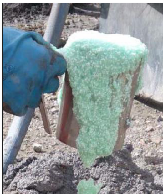
Fotografía 3-17 y Fotografía 3-18: Limpieza del material explosivo que queda fuera del depósito y pesado. Fuente: Asistencia Técnica (ORICA) “Las Bambas”.
