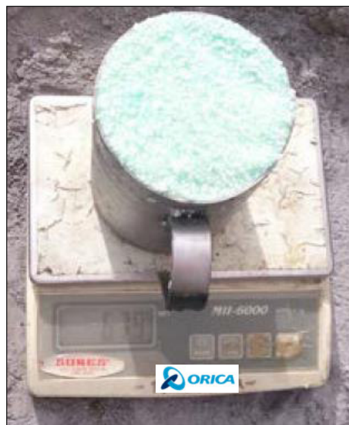
Fotografía 3-17 y Fotografía 3-18: Limpieza del material explosivo que queda fuera del depósito y pesado. Fuente: Asistencia Técnica (ORICA) “Las Bambas”.
