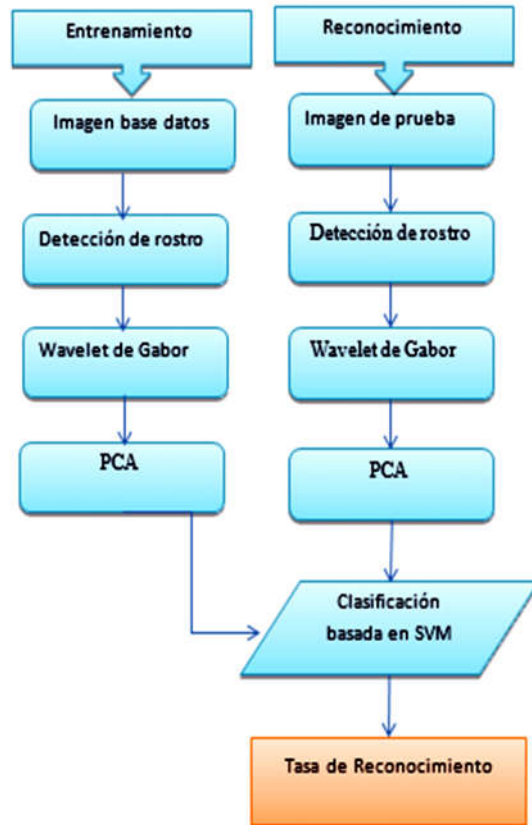
Fig. 4 Diagrama de procesos de reconocimiento de rostros propuesto.
