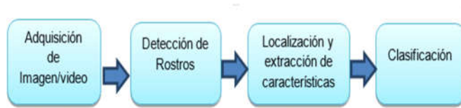
Fig. 3. Diagrama de bloques de un esquema general para el reconocimiento de rostros.
