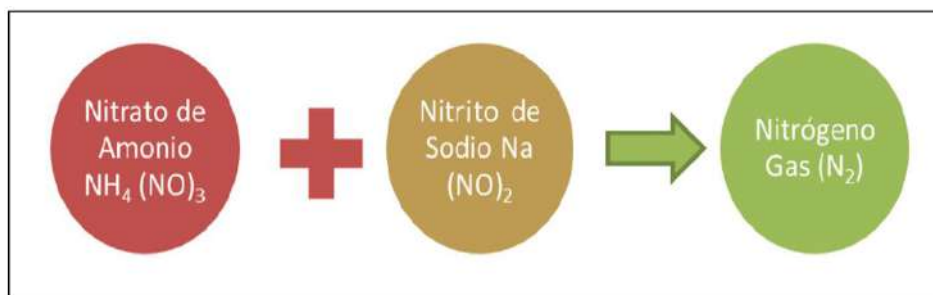
Figura 11. Sensibilización química por la generación de burbujas de nitrógeno.
