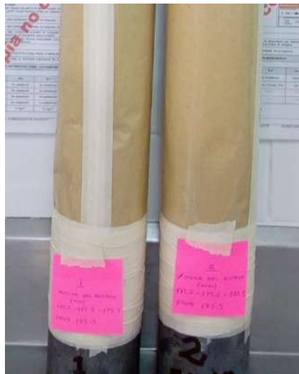
Figura 29. Preparación de las muestras para la prueba de macrohess
