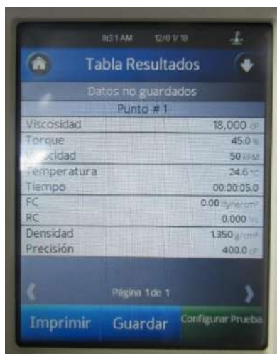
Figura 25. Medición de los parámetros de la emulsión
