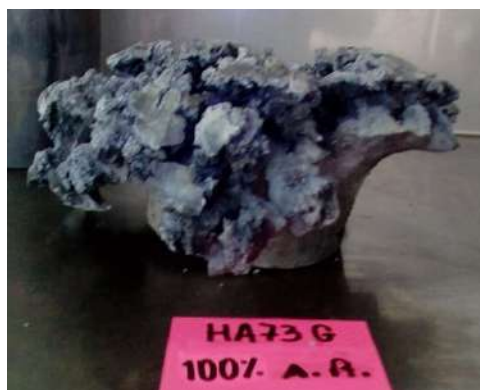
Figura 32. Prueba de macrohess con Heavy ANFO 73 con aceite residual gasificado. Fuente: Elaboración propia.
