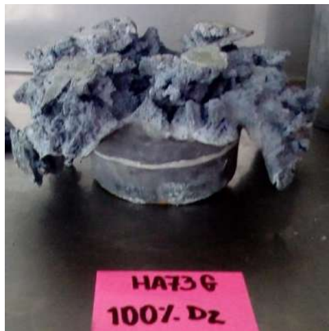
Figura 31. Prueba de macrohess con Heavy ANFO 73 con diésel gasificado. Fuente: Elaboración propia.
