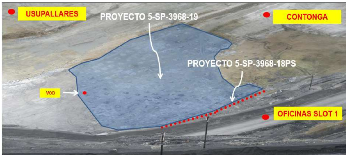
Figura 38. Voladura en fase 5 con Heavy ANFO 73 con petróleo gasificado.
