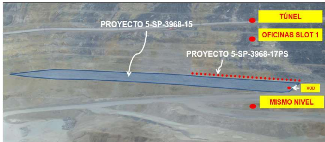
Figura 34. Voladura en fase 5 con Heavy ANFO 73 con petróleo gasificado Fuente: Asistencia técnica FAMESA EXPLOSIVOS SAC
