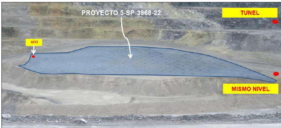
Figura 44. Voladura en fase 5 con Heavy ANFO 73 con aceite residual gasificado Fuente: Asistencia técnica Famesa Explosivos SAC.
