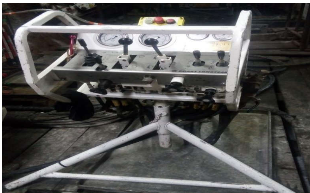
Figura 11. Componentes de la perforadora – panel de mando.
