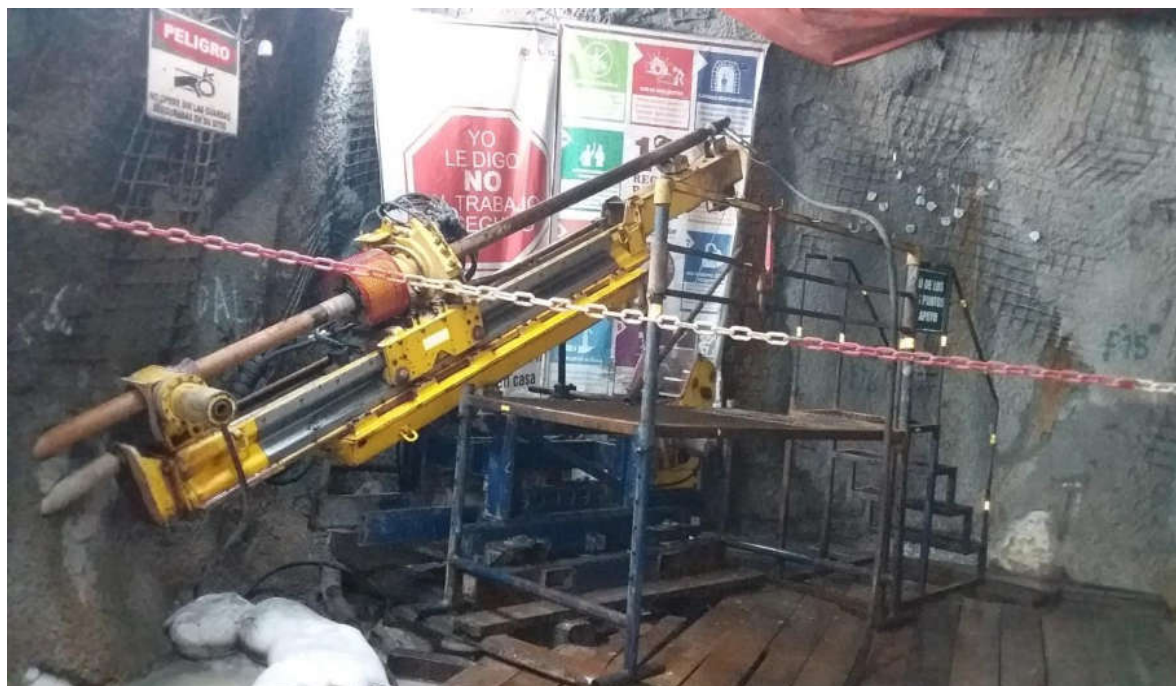
Fotografía 3: Perforadora LM 75 en ángulo negativo
