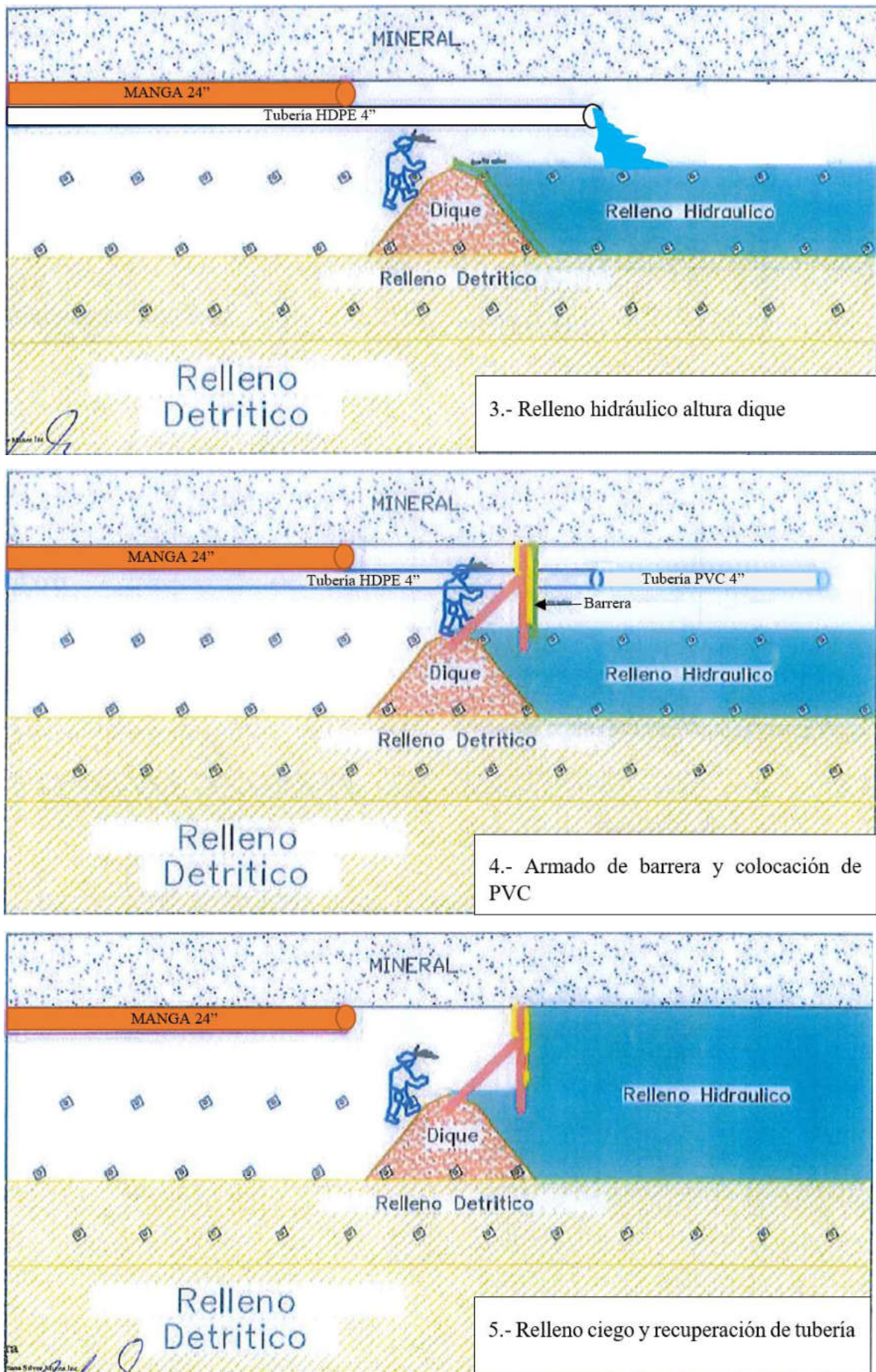
Figura 5. Estándar de secuenciamiento del relleno hidráulico en tajos – Breasting UEA San Cristóbal. Fuente: (MIBSAC, 2017).
