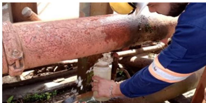
Fig. 3. Recolección de muestra de agua de alimentación en el punto de toma de muestra: entrada de planta.
