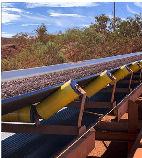
Fig. 1. Faja transportadora basada en polines
