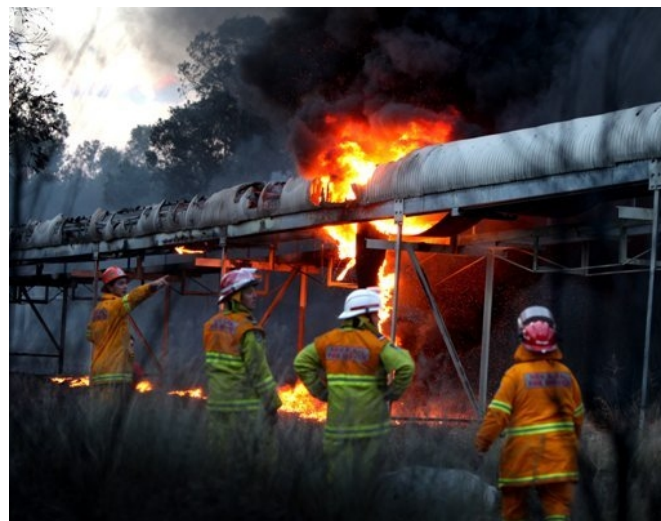
Fig. 2. Incendio ocasionado por el posible calentamiento de un polín
