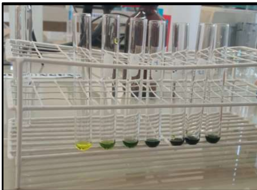
Figura 28 — Reacción de ácido gálico y folin
