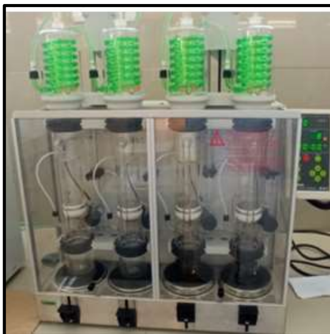
Figura 26 — Extracción de extractos por el método Soxhlet en caliente
