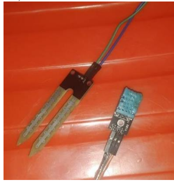
Fig. 3: sensores de humedad y temperatura
