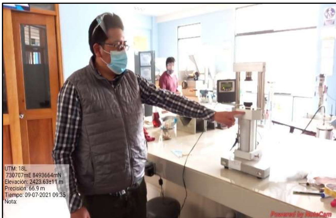
Figura 68 — Utilización de los Equipos en el laboratorio para realizar ensayo de carga simple para estimar la resistencia del macizo rocoso
