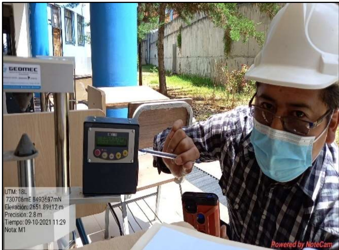
Figura 70 — Registro de resultados del equipo de carga puntual de haber sometido a ensayo la muestra
