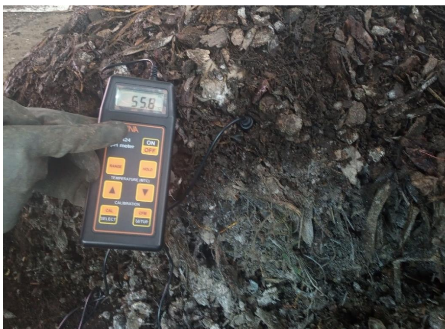
Fotografía 16 — Control de temperatura en núcleo de pila compostera (pilas)
