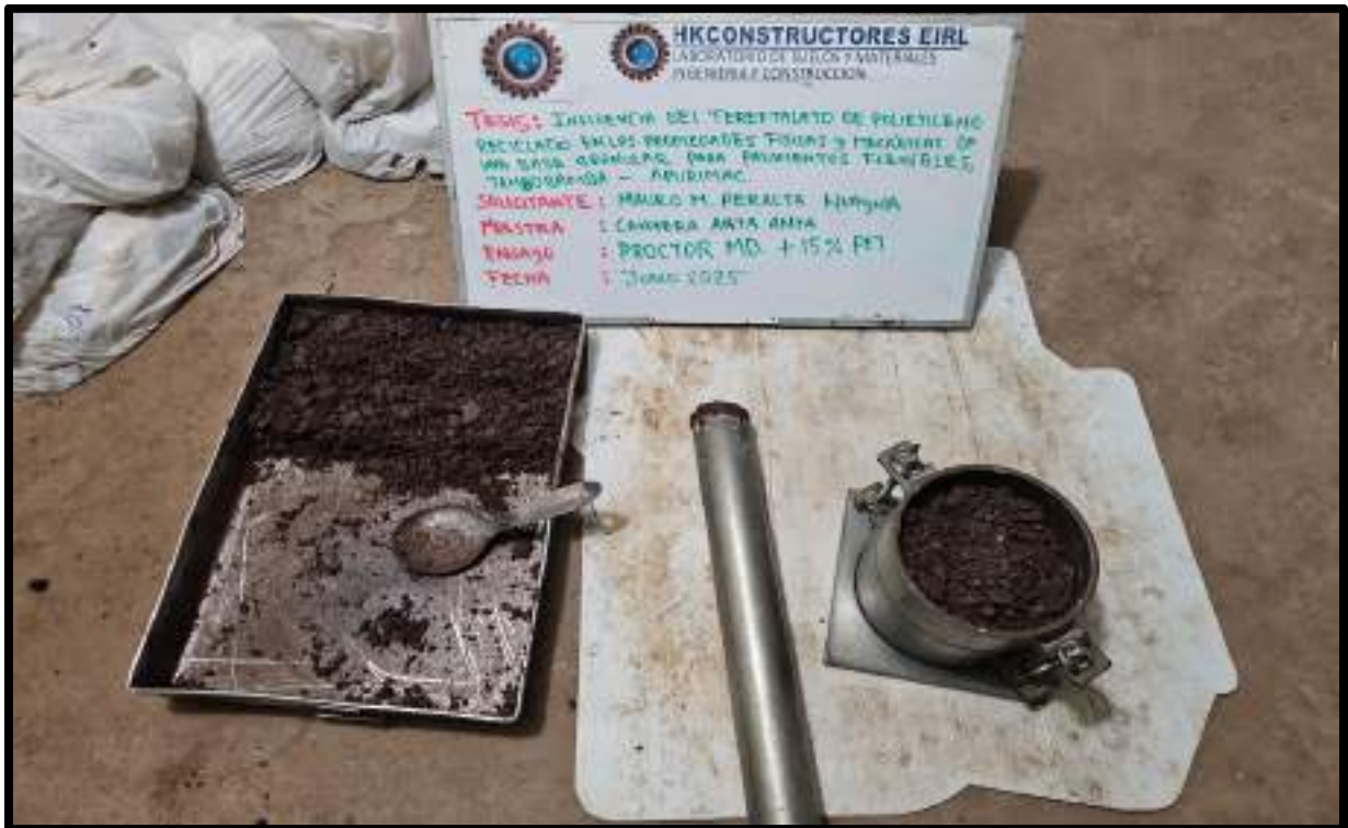
Figura 110 — Ensayo proctor modificado + 15% PET-R.
