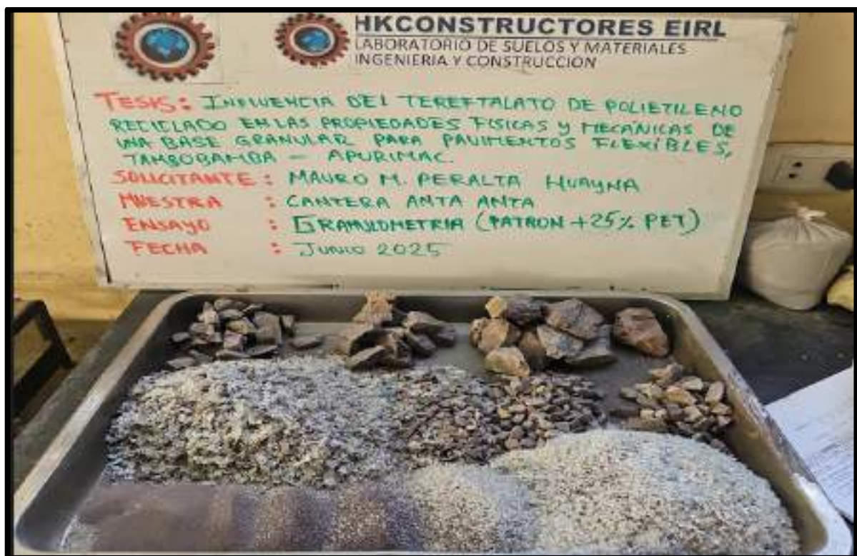
Figura 117 — Granulometría de muestra patrón + PET reciclado.
