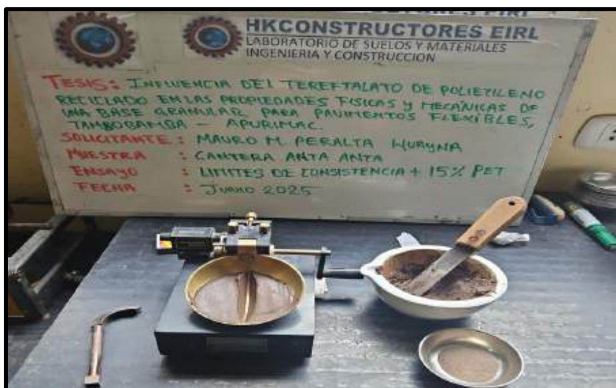
Figura 115 — Ensayo de límites de consistencia LL + PET reciclado.
