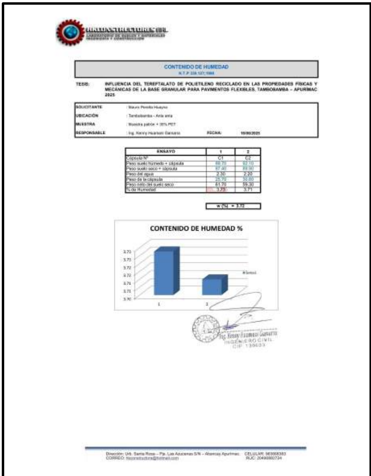
Figura 65 — Resultado contenido de humedad + 35% PET-R
