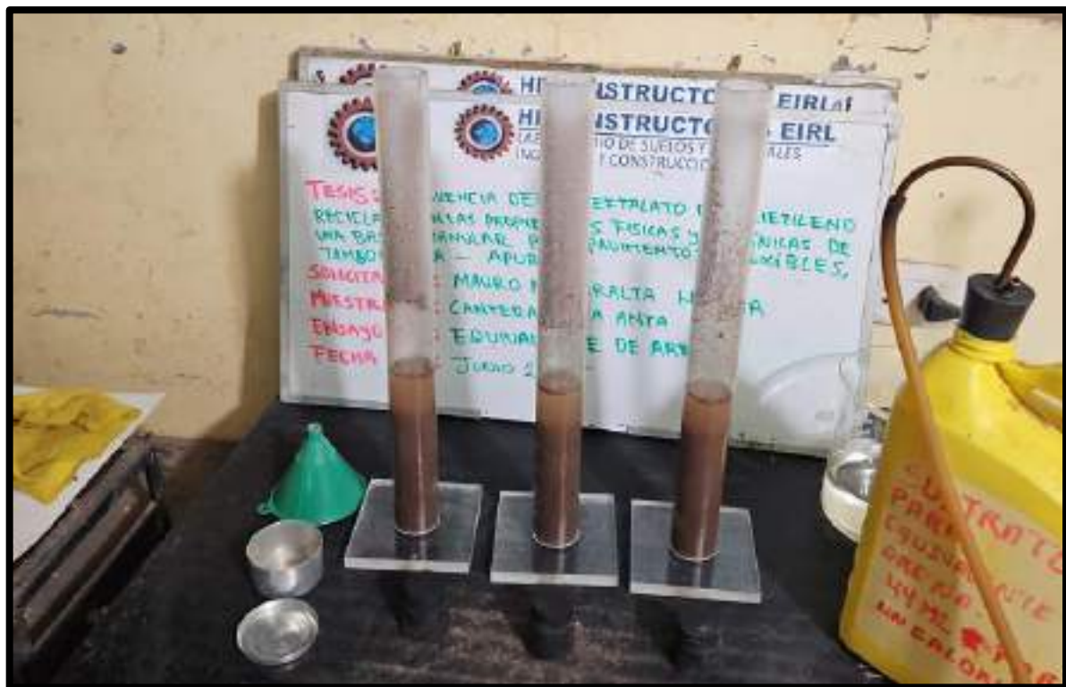
Figura 111 — Ensayo equivalente de arena.
