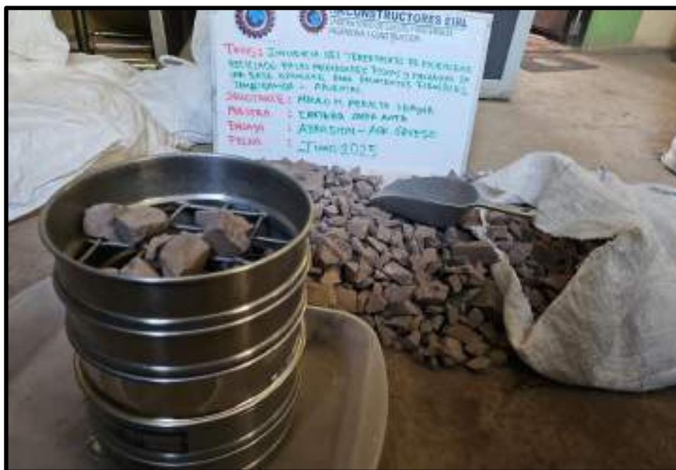
Figura 13 — Preparación de muestra para desgaste Los Ángeles
