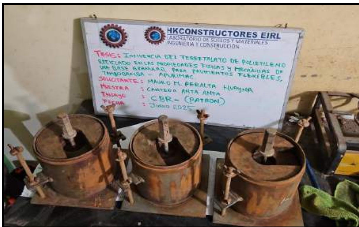
Figura 112 — Ensayo CBR de la muestra patrón.
