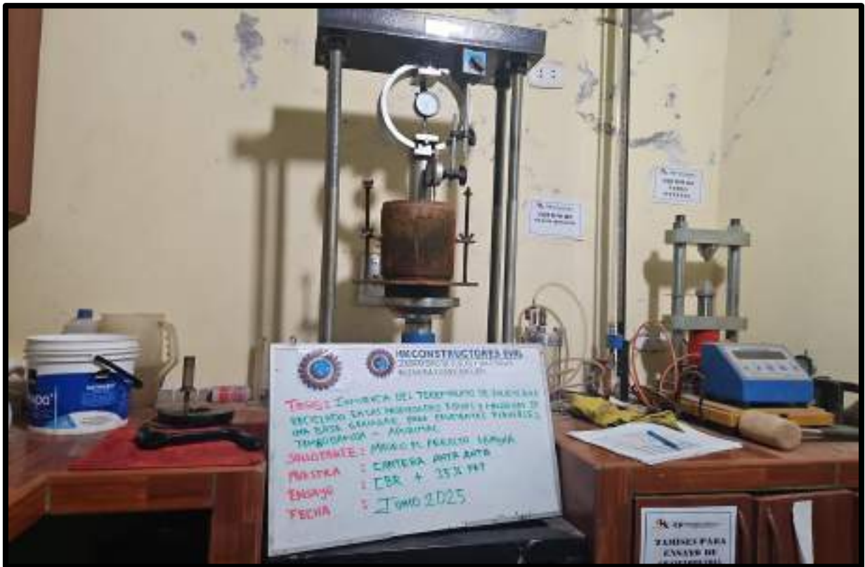
Figura 116 — Ensayo CBR + 35% PET-R
