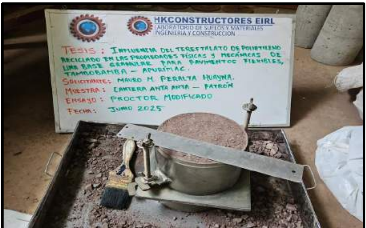
Figura 109 — Ensayo de Proctor modificado.
