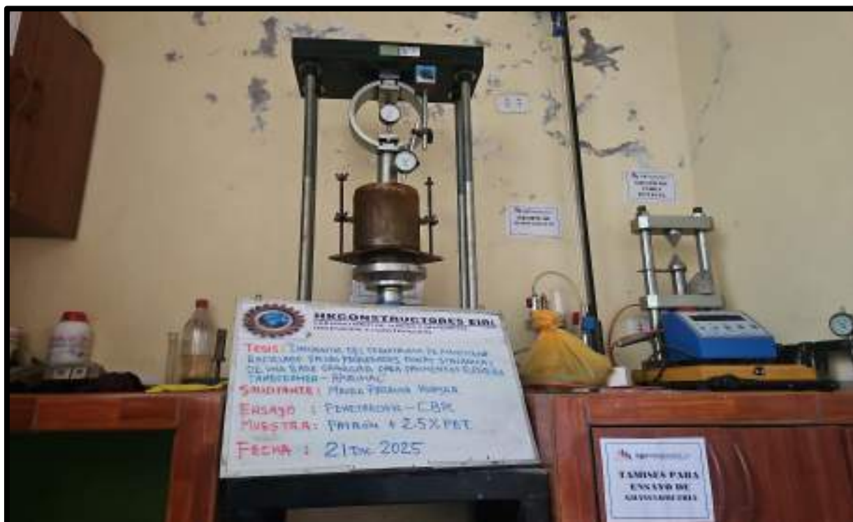
Figura 119 — Ensayo CBR + 2.5% PET-R.
