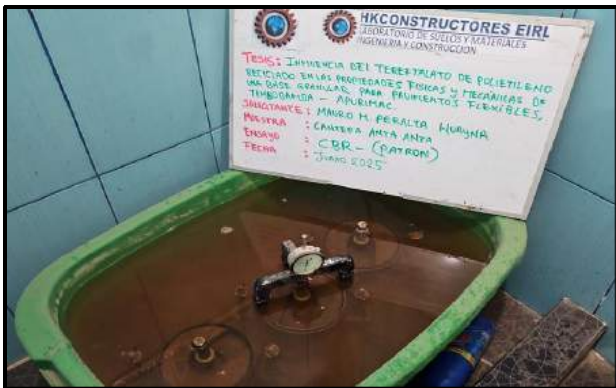
Figura 113 — Ensayo de expansión y contracción.
