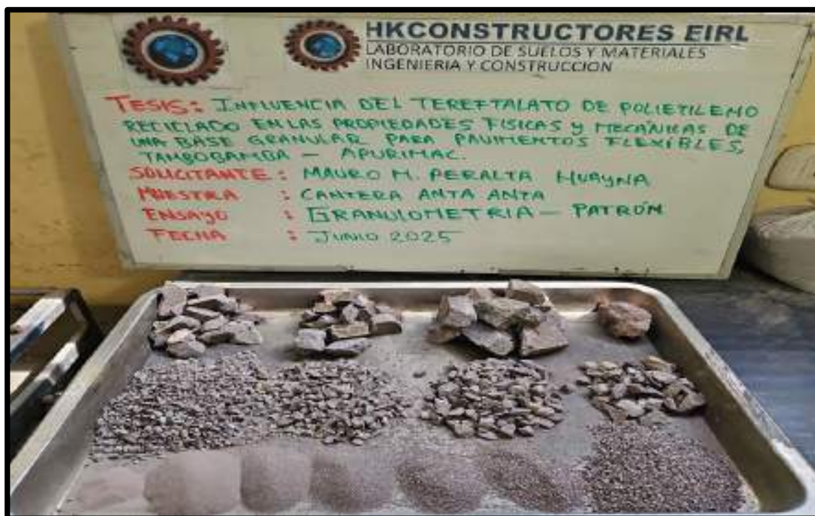
Figura 107 — Ensayo de granulometría por tamizado.
