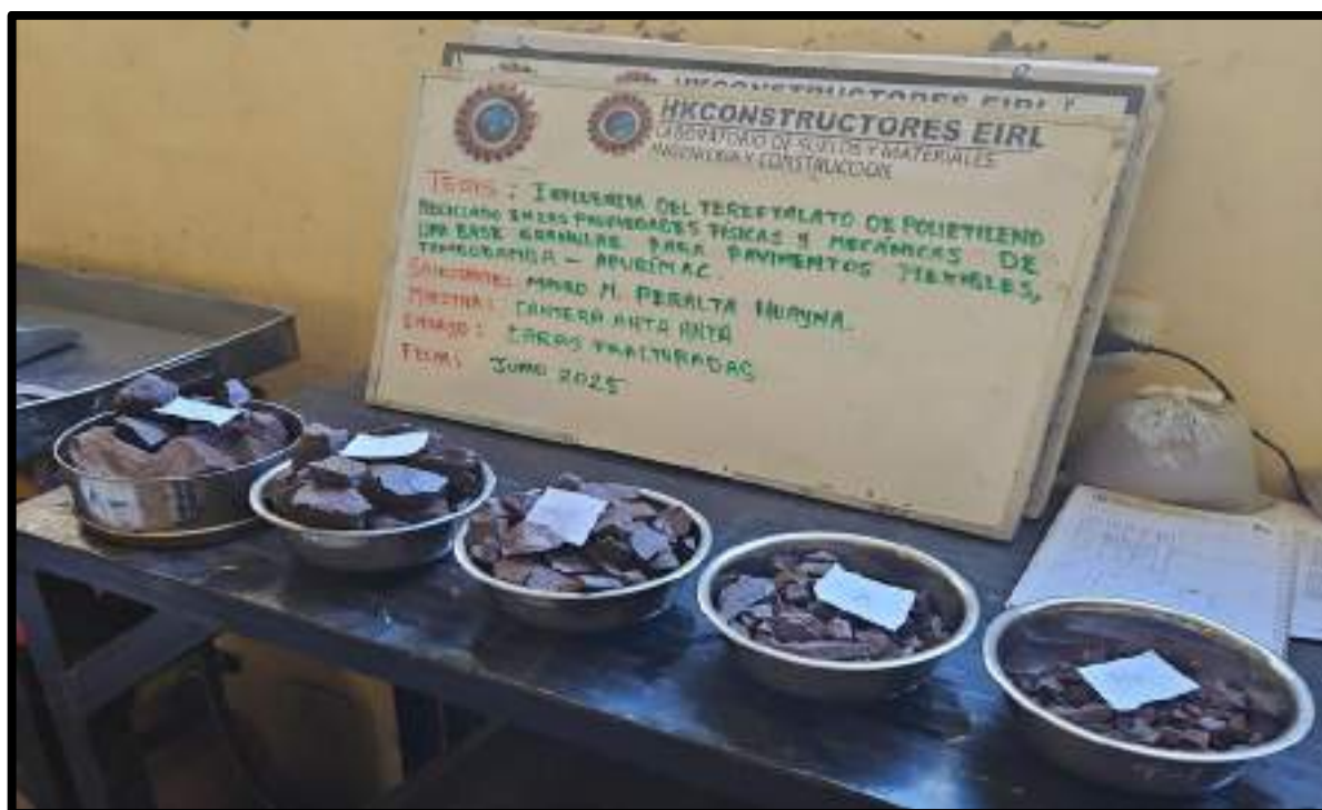
Figura 105 — Ensayo caras fracturadas.
