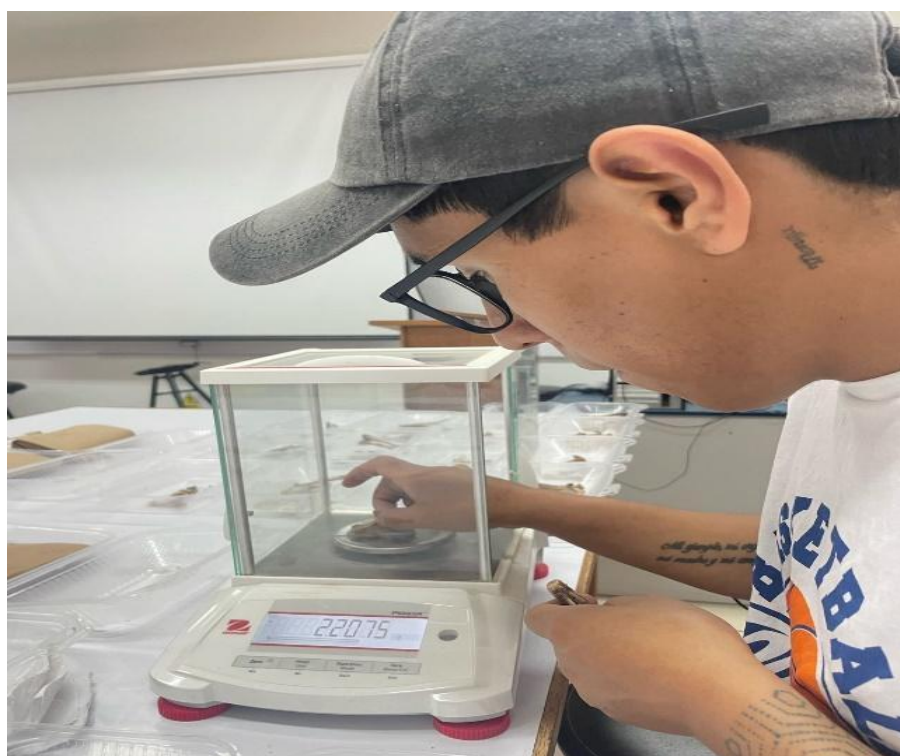
Fig. 9. Proceso de determinación del peso óseo mediante el uso de balanza analítica digital de alta precisión (Marca OHAUS) para la evaluación cuantitativa de las estructuras óseas obtenidas de pollos de engorde Cobb 500 sometidos a diferentes niveles de calcio total
