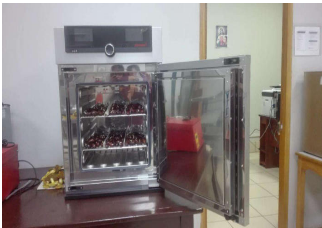
Figura 16 — Proceso de secado por convección forzada de las semillas de basul
