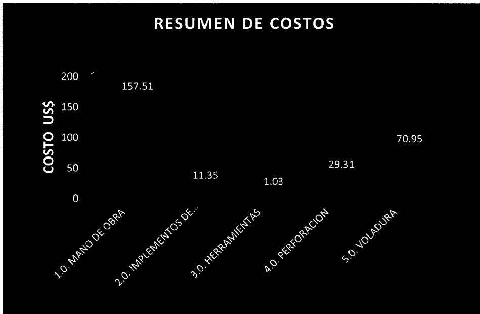
Grafico N° III-2: Diagrama de barras de los costos durante la excavación de la chimenea.
