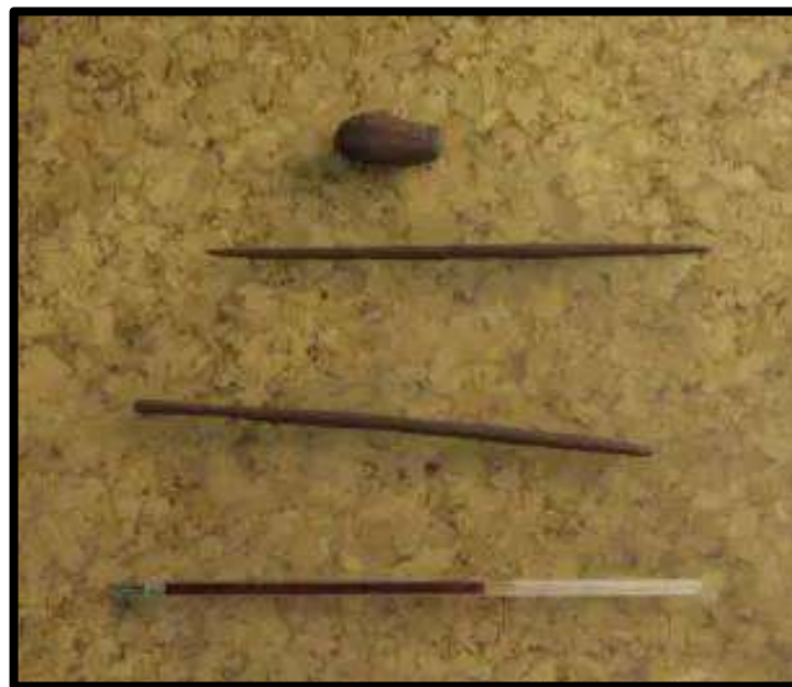
Figura 3 — Prueba de límite plástico
