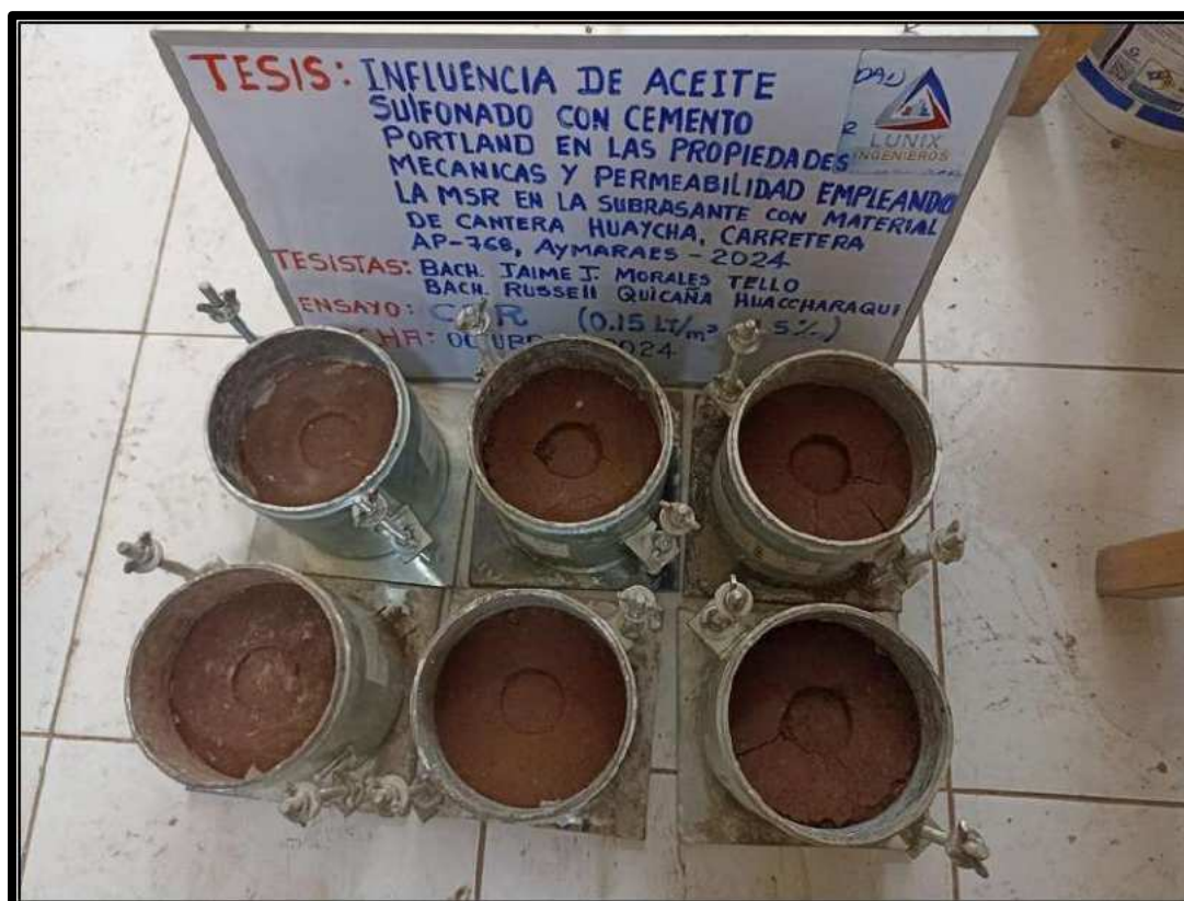
Figura 65 — Moldes de las muestras después del ensayo CBR
