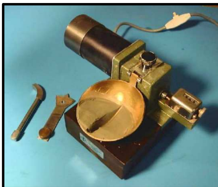
Figura 4 — Prueba de límite líquido
