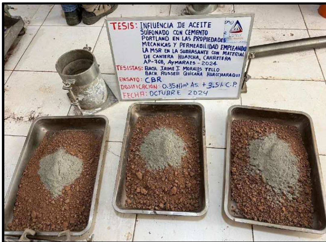
Figura 61 — Combinación del cemento portland I con el material de cantera Huaycha
