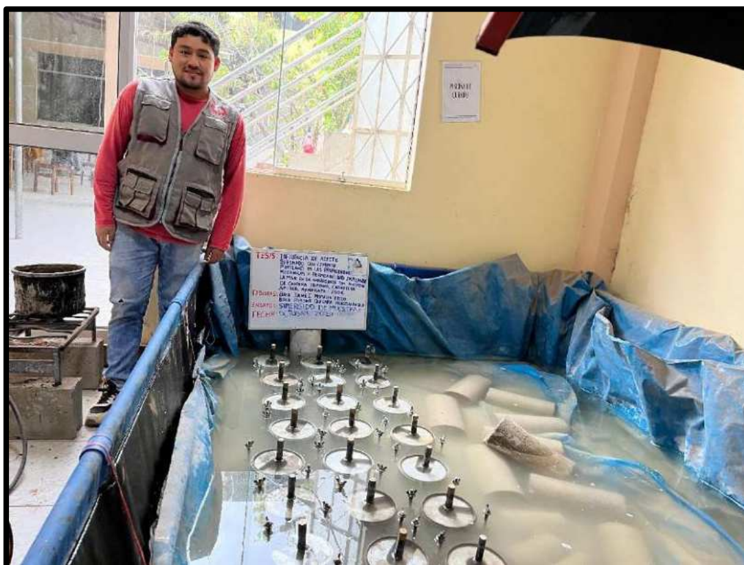
Figura 62 — Inmersión de moldes CBR para el ensayo de expansión volumétrica
