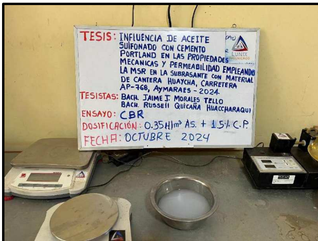
Figura 60 — Combinación del agua con el aceite sulfonado IONICSOIL
