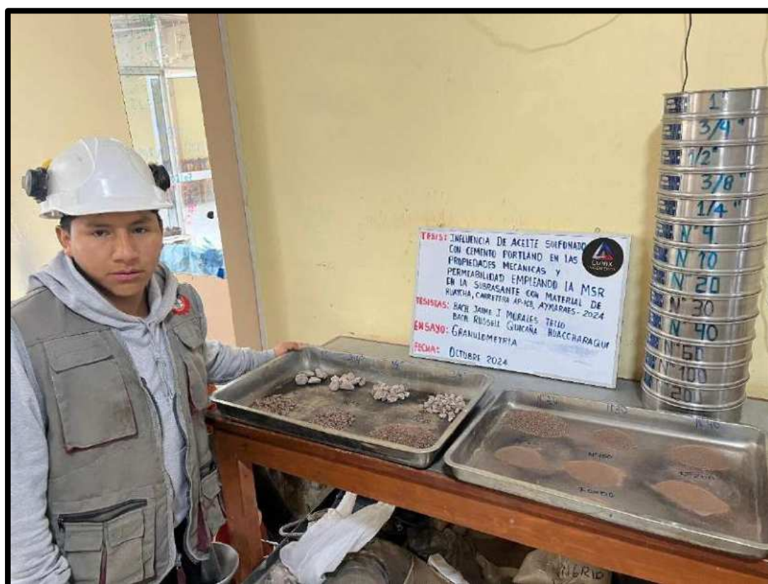
Figura 54 — Clasificación de suelo mediante análisis granulométrico por tamizado
