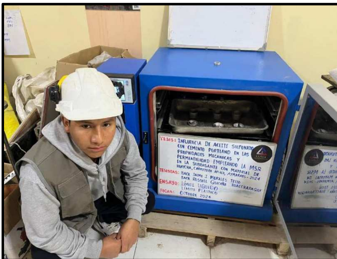
Figura 56 — Secado en el horno muestras límite líquido y límite plástico
