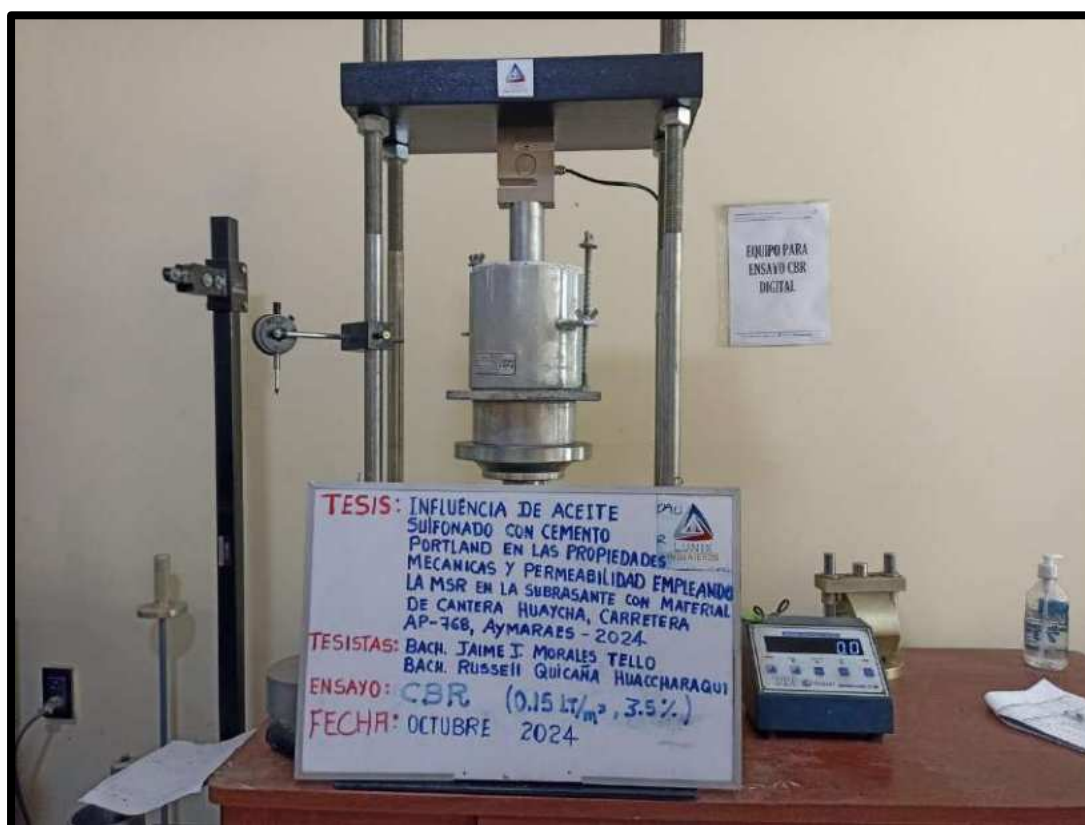
Figura 64 — Ensayo de rotura en la prueba CBR
