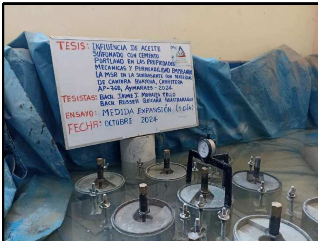
Figura 63 — Medición de la expansión volumétrica en especímenes de CBR
