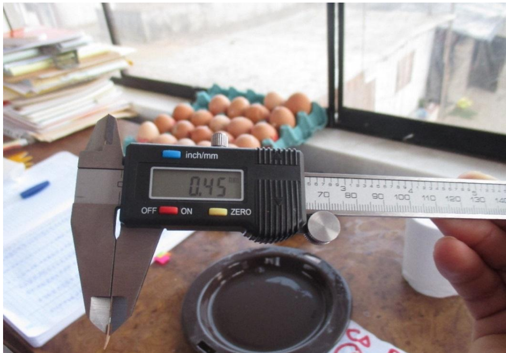
Figura28. Medición de la cáscara con el micrómetro digital.
