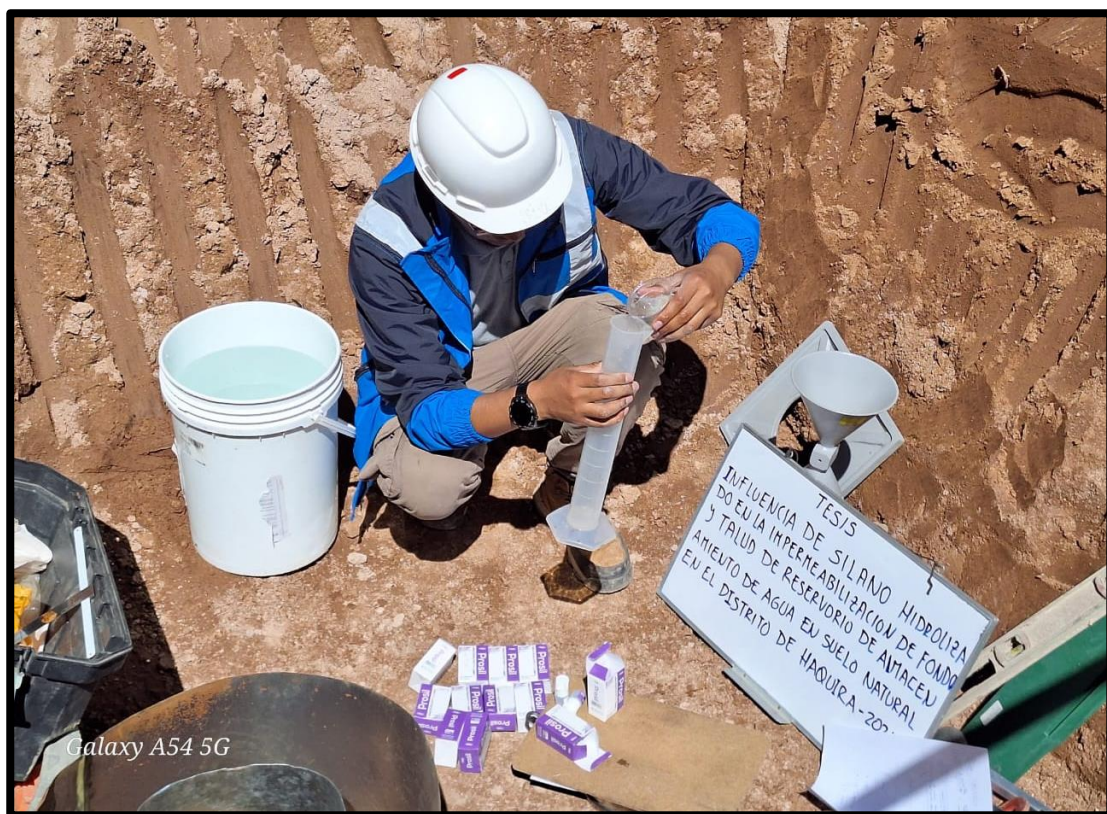
Figura 39 — Preparación de silano para los ensayos de talud y fondo
