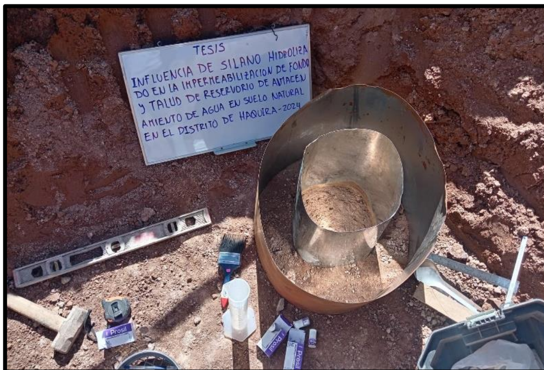
Figura 22 — Colocación de anillo para el ensayo en el fondo de reservorio
