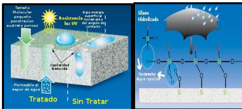
Figura 1 — Modo de acción del silano hidrolizado (SiOH)
