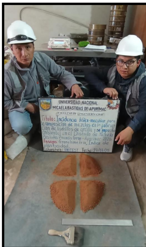
Figura 46 — Cuarteado de la muestra de la composición de mezclas de arcilla de las diferentes muestras para el ensayo de granulometría en el laboratorio automatizado de control de calidad de materiales UNITEST – Cusco
