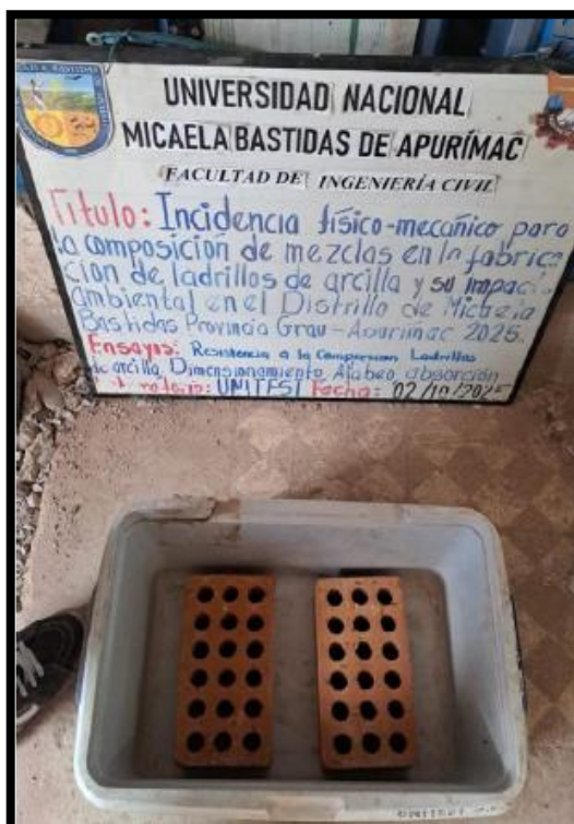
Figura 60 — Ensayo de eflorencia de ladrillos de arcilla King Kong 18 huecos 9x24x12.5 cm en el laboratorio automatizado de control de calidad de materiales UNITEST – Cusco
