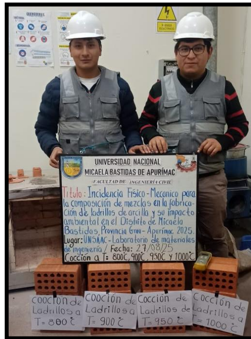
Figura 52 — Cocción de ladrillos de arcilla King kong 18 huecos 9x24x12.5 cm a diferentes temperaturas T=800\text{ }^{\circ}\text{C} , T=900\text{ }^{\circ}\text{C} , T=950\text{ }^{\circ}\text{C} y T=1000\text{ }^{\circ}\text{C} en el Laboratorio de Materiales de Ingeniería – Facultad de Ingeniería de Procesos – UNSAAC
