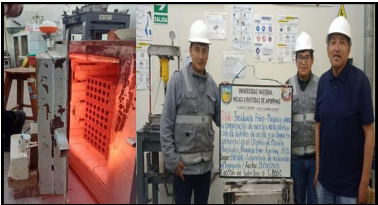
Figura 51 — Cocción de ladrillo de arcilla King kong 18 huecos 9x24x12.5 cm en el Laboratorio de Materiales de Ingeniería – Facultad de Ingeniería de Procesos – UNSAAC
