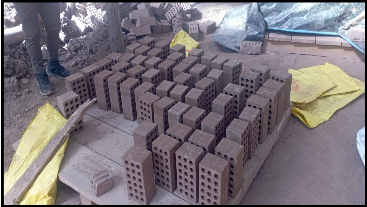
Figura 50 — Secado de Ladrillo King kong 18 huecos 9x24x12.5 cm en la ladrillera LATER. distrito de San Jerónimo, provincia Cusco - Cusco
