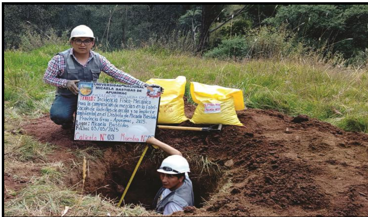
Figura 42 — Calicata 03, muestra 03 para el laboratorio de análisis químico
