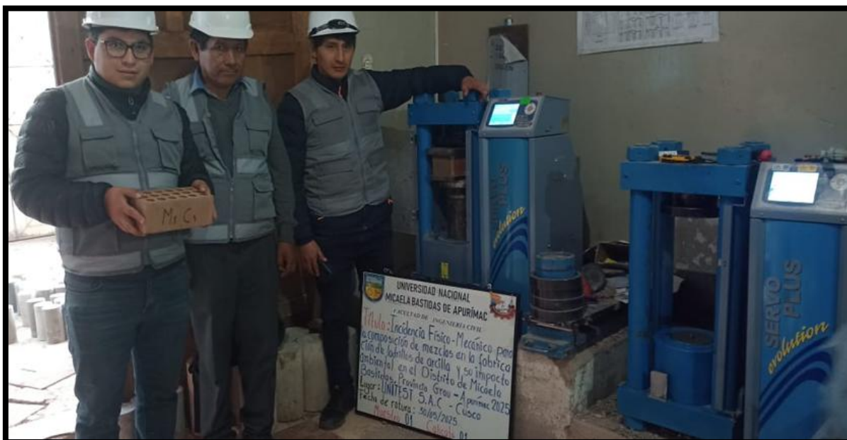
Figura 55 — Ensayos de compresión a diferentes temperaturas de ladrillo de arcilla King Kong 18 huecos 9 \times 24 \times 12.5\text{ cm} en el laboratorio automatizado de control de calidad de materiales UNITEST – Cusco
