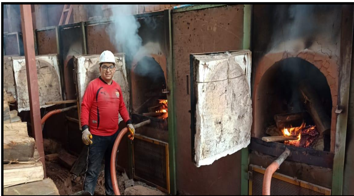
Figura 54 — Cocción de ladrillo a temperatura T=1100\text{ }^{\circ}\text{C} controlado por termocupla en la ladrillera LATER. distrito de San Jerónimo, provincia Cusco – Cusco
