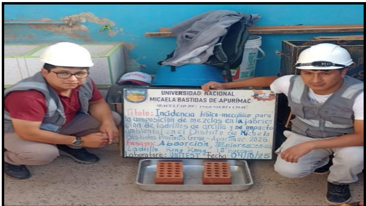
Figura 59 — Ensayo de Absorción de ladrillos de arcilla King Kong 18 huecos 9x24x12.5 cm en el laboratorio automatizado de control de calidad de materiales UNITEST – Cusco
