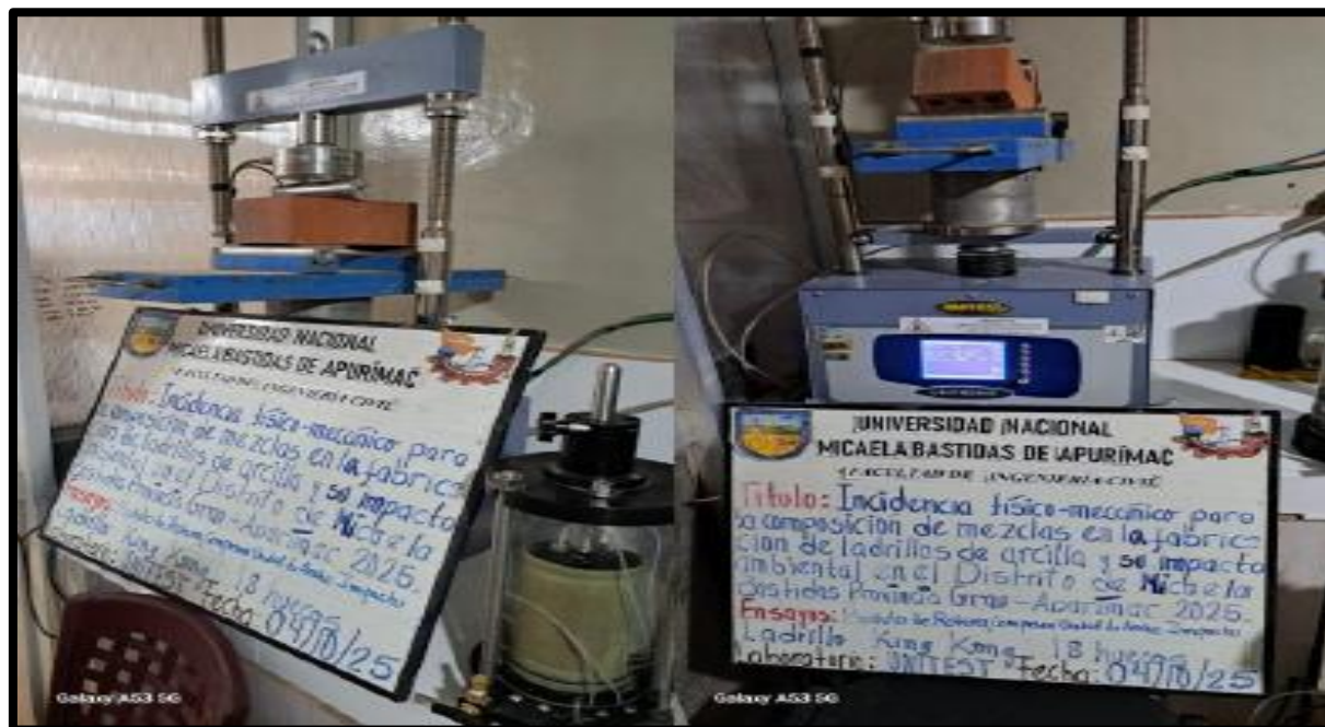
Figura 61 — Ensayo de módulo de rotura (Ensayo de flexión) de ladrillos de arcilla King Kong 18 huecos 9x24x12.5 cm en el laboratorio automatizado de control de calidad de materiales UNITEST – Cusco.
