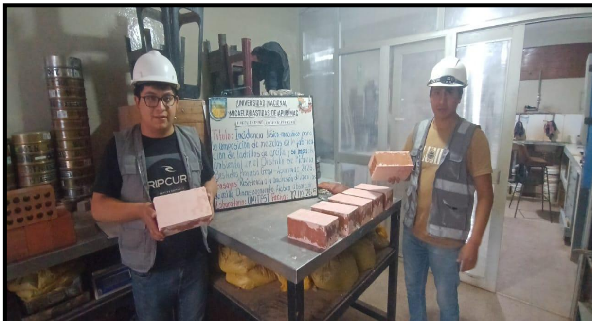
Figura 56 — Ladrillo de arcilla King Kong 18 huecos 9x24x12.5 cm para la prueba refrentando usando yeso piedra especial extra duro en el laboratorio automatizado de control de calidad de materiales UNITEST – Cusco
