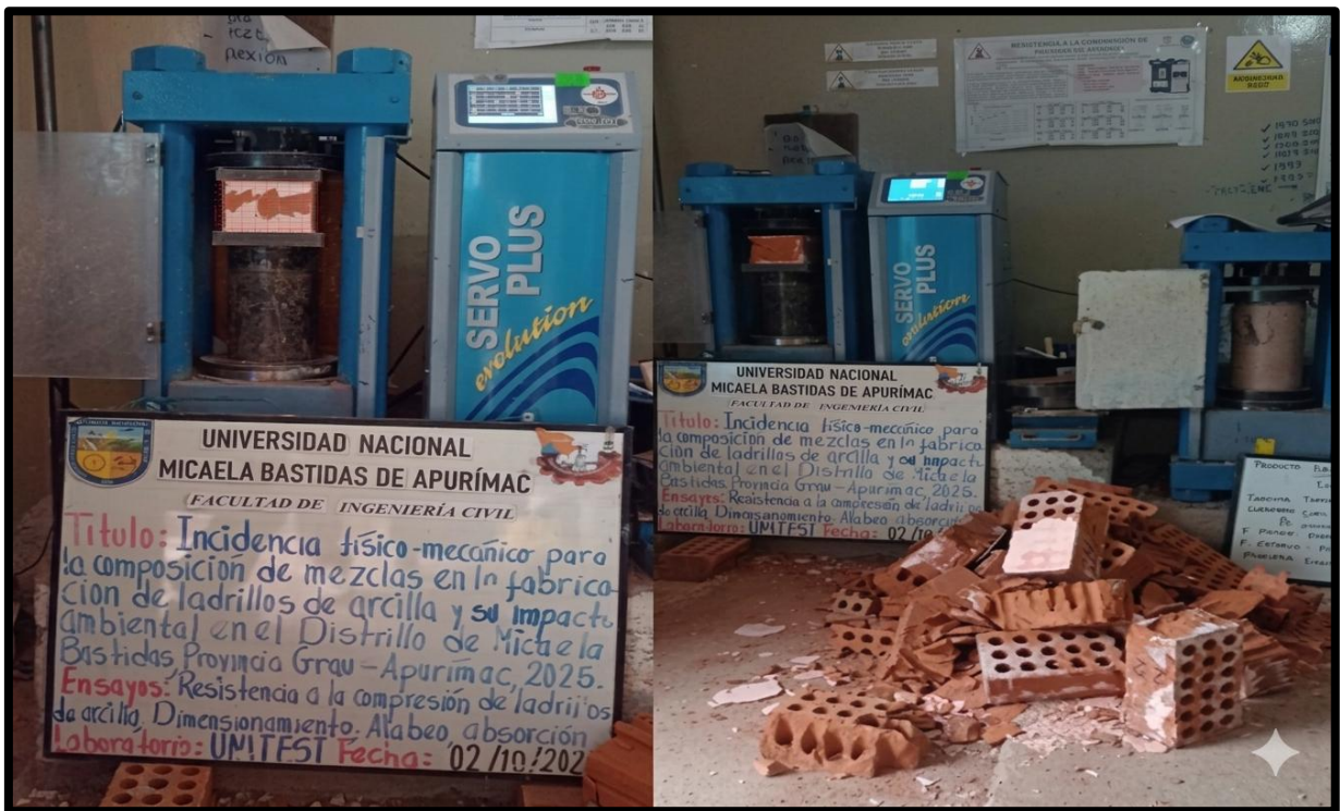
Figura 58 — Ensayos a la compresión de ladrillo de arcilla King Kong 18 huecos 9x24x12.5 cm, ladrillos Refrentados en el laboratorio automatizado de control de calidad de materiales UNITEST – Cusco
