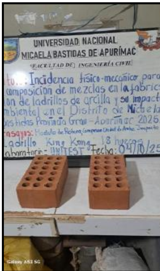
Figura 62 — Ensayo de compresión al impacto de ladrillos de arcilla King Kong 18 huecos 9x24x12.5 cm en el laboratorio automatizado de control de calidad de materiales UNITEST – Cusco
