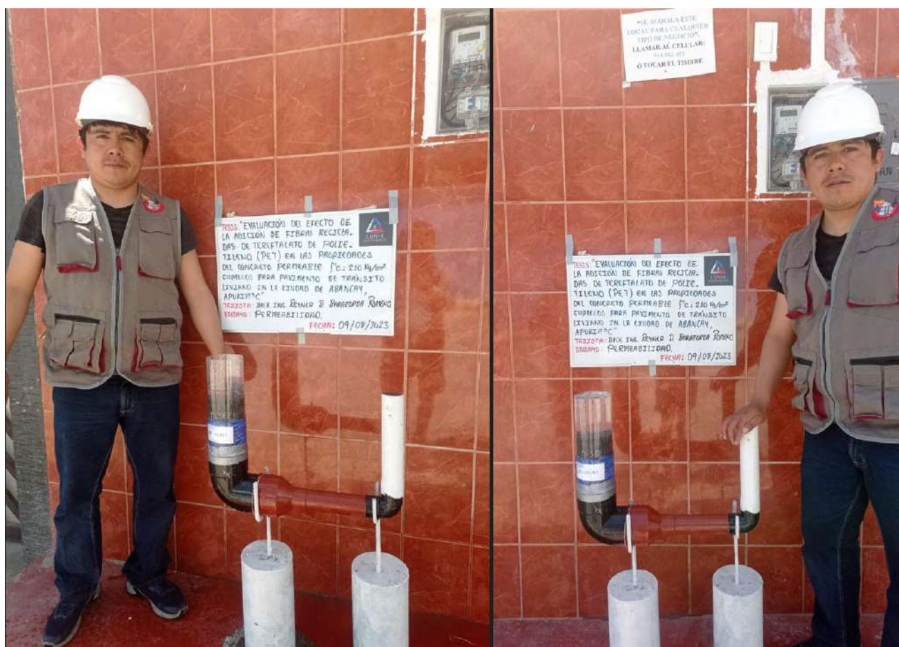
Figura 63 — Ensayo de permeabilidad a especímenes de concreto permeable
