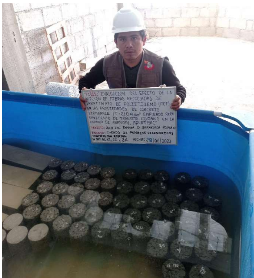
Figura 54 — Curado del concreto
