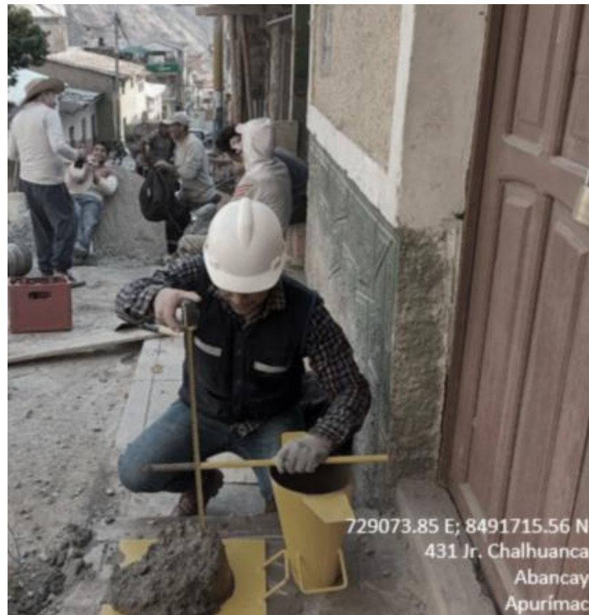
Figura 54 — Ensayo del asentamiento del concreto
