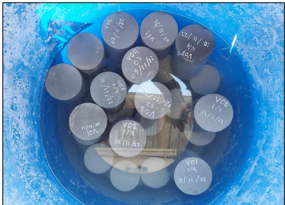
Figura 13 — Curado de briquetas de concreto en laboratorio
