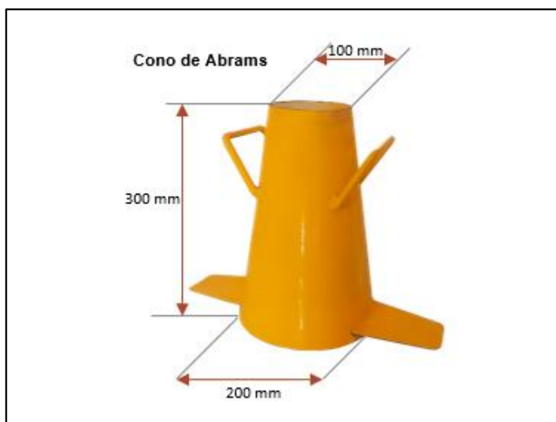
Figura 5 — Medidas del Cono de Abrams
