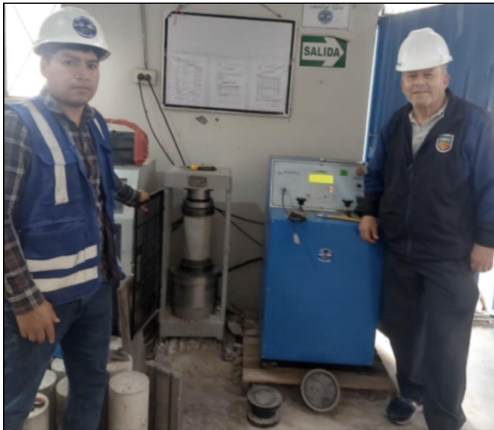
Figura 45 —Ensayo a la compresión del concreto con verificación del asesor de tesis
