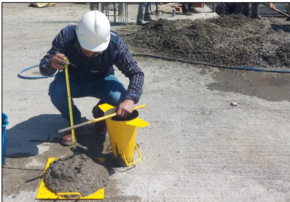
Figura 7 — Ensayo del asentamiento del concreto con el cono de Abrams
