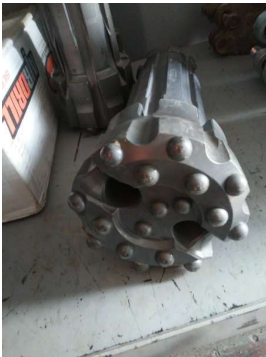
Figura 9 — Broca de botones para la perforacion rotopercutiva
