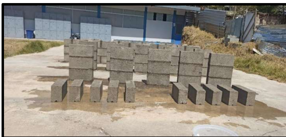
Figura 47 — Construcción de prismas de albañilería
