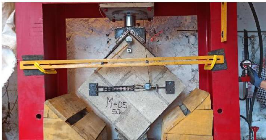
Imagen 07: Muestra la instrumentación del murete que será sometido a corte.
