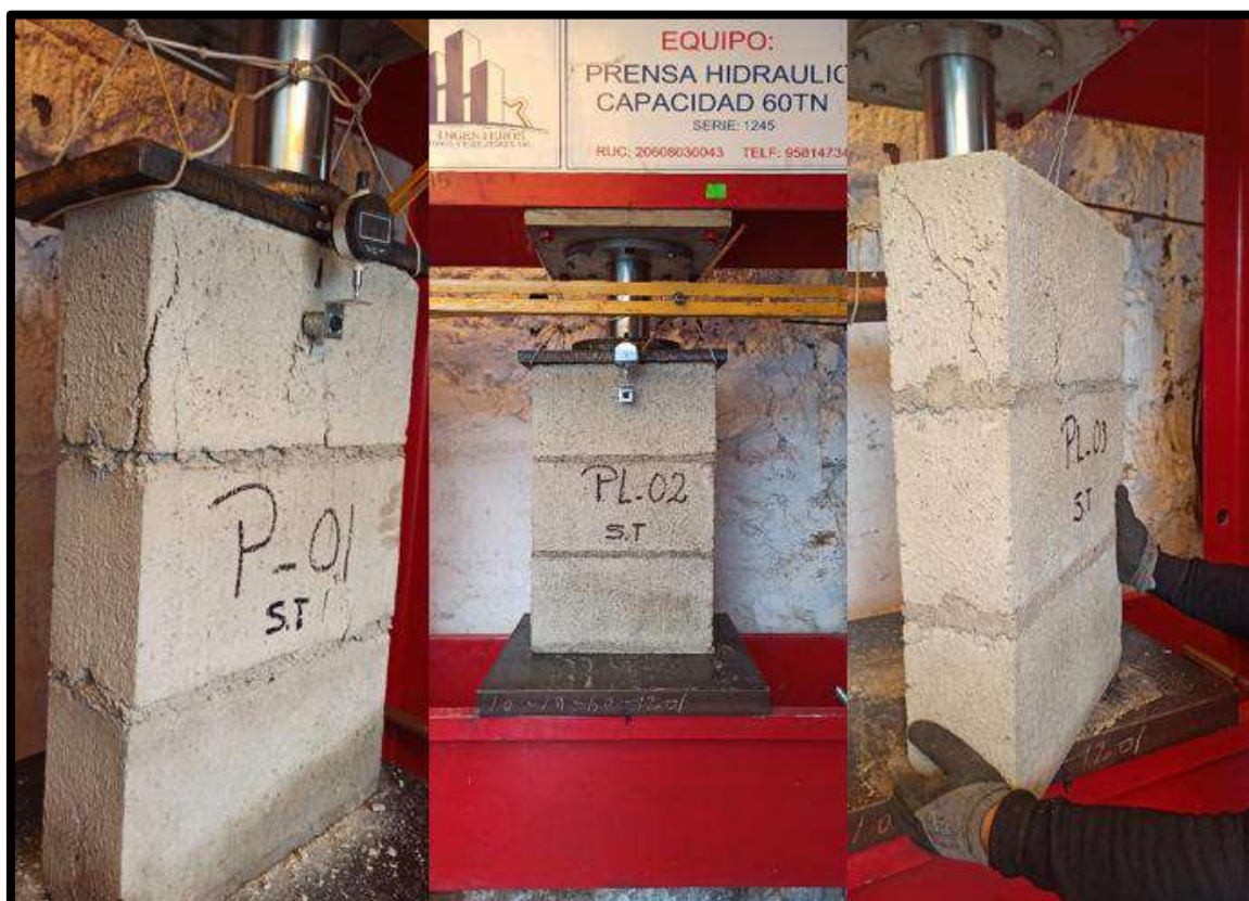
Figura 27 — Ensayo de las pilas PL-01, PL-02, PL-03
