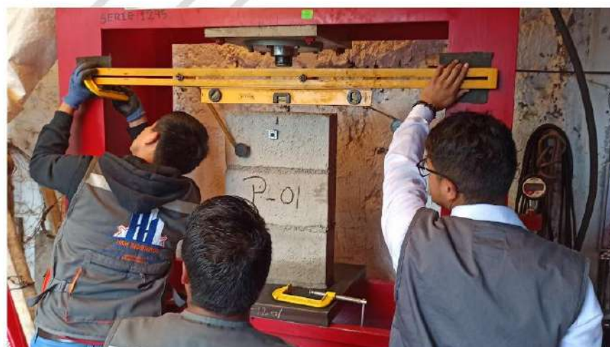
Imagen 04: Muestra la instrumentación del equipo para someter al ensayo de a compresión de pilas y las lecturas de deformación.
