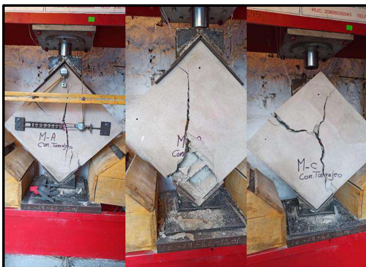
Figura 31 — Ensayo de muretes con tarrajeo M-A, M-B y M-C
