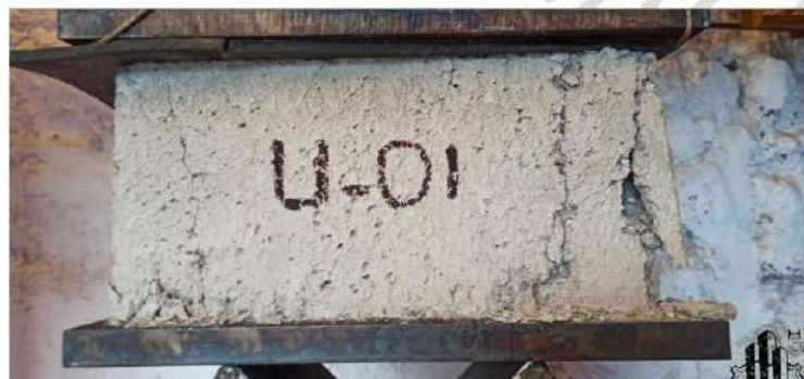
Imagen 02: Muestra la falla de la unidad de concreto.
