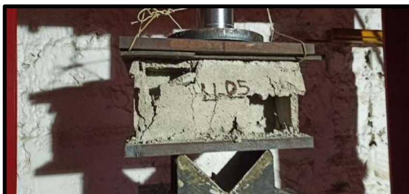
Figura 25 — Ensayo de bloque de concreto U - 05
