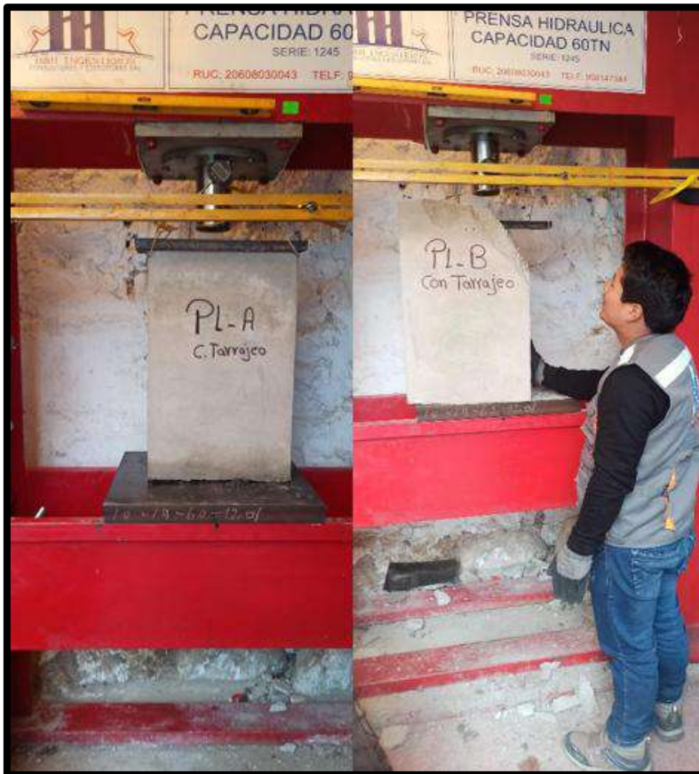
Figura 28 — Ensayo de pilas con tarrajeo PL-A y PL-B
