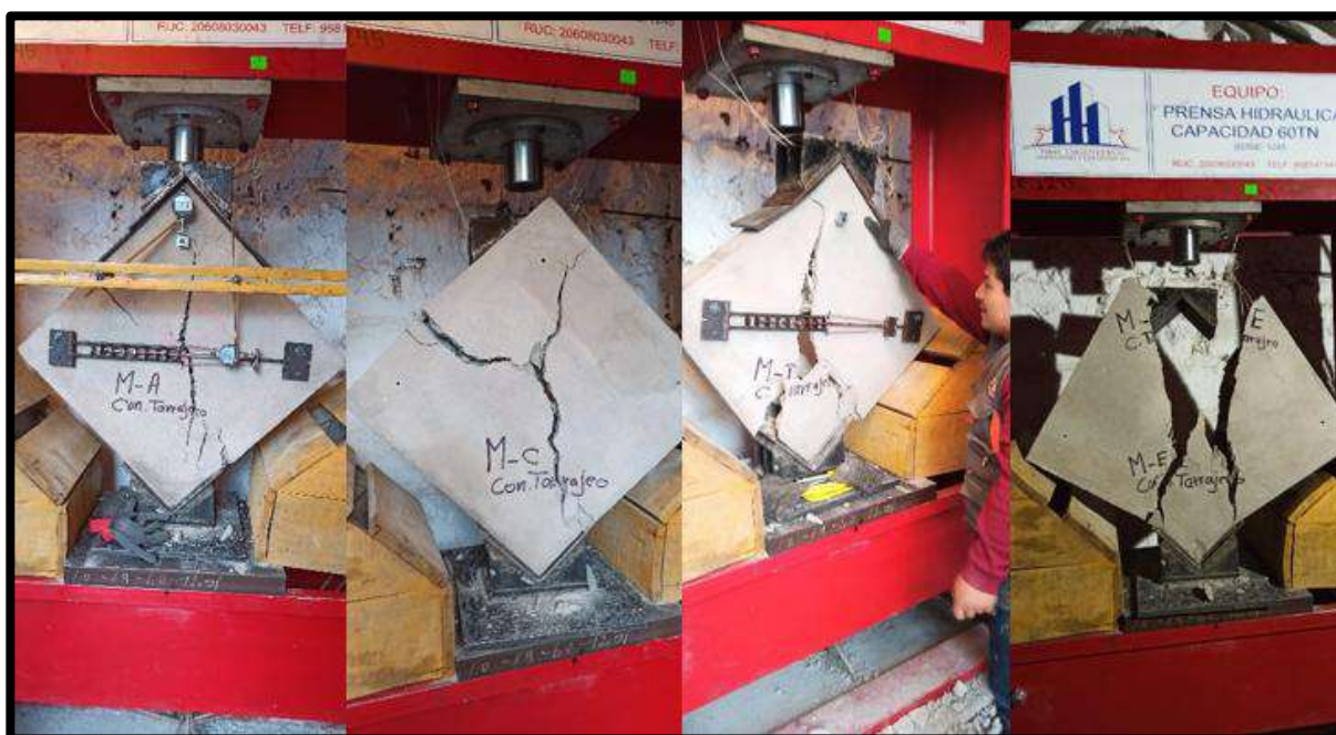
Figura 18 — Formas de falla de los muretes con tarrajeo
