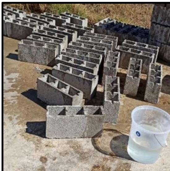
Figura 3 — Humedecimiento de los bloques de concreto
