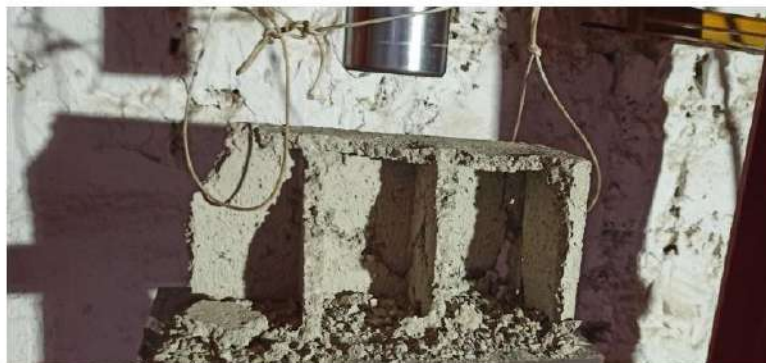
Imagen 03: Muestra la falla lateral a corte, el cual es la adecuada en unidades de albañilería.
