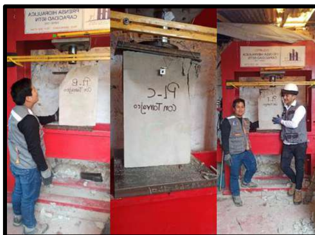
Figura 10 — Pilas con tarrajeo PL – B, PL – C y PL – E, post ensayo
