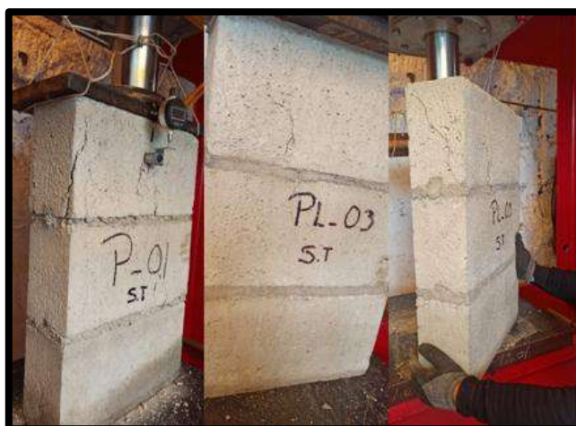
Figura 9 — Pilas sin tarrajeo P-01y PL-03, post ensayo
