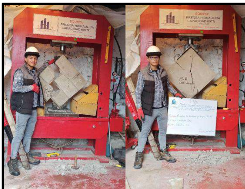
Figura 32 — Ensayo de resistencia a compresión diagonal de muretes
