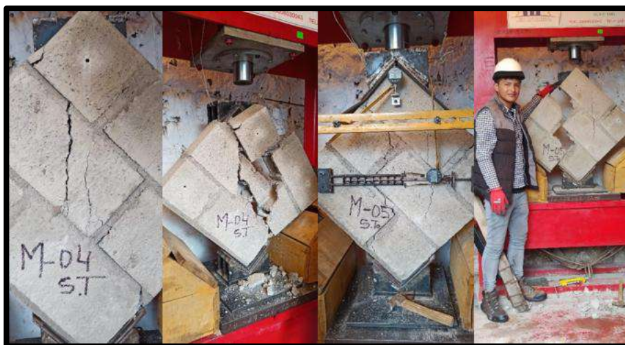
Figura 17 — Formas de falla de los muretes M – 04 y M - 05
