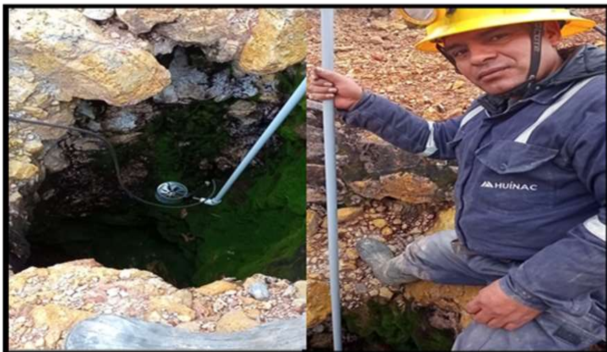
Figura 21 — La Medición con Tubo de Pitot Velocidad de Aire
