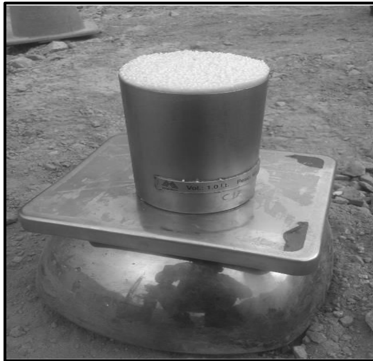
FOTO N° 10: Esponjamiento de la mezcla explosiva gasificada (HA-73G).
