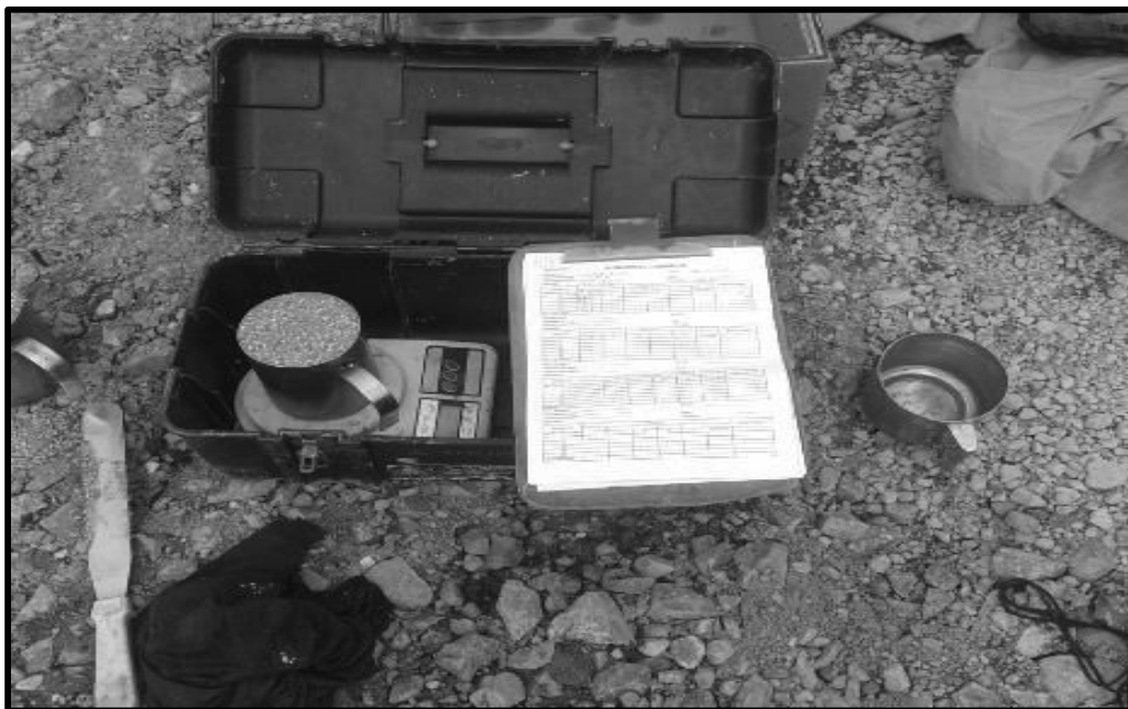
FOTO N° 11: Medición y control de la mezcla explosiva gasificada (HA-73G).
