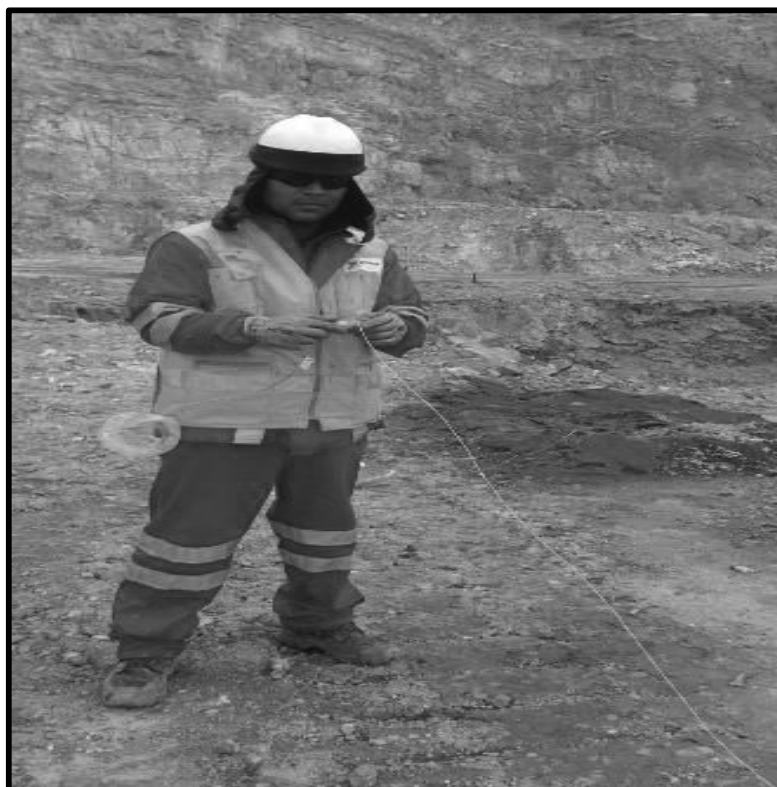
FOTO N° 16: Realizando el amarre del proyecto de voladura en el sistema electrónico.
