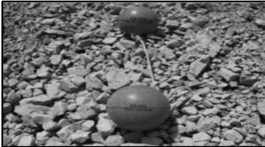
Figura N° 46: Toma de imágenes en campo del material fragmentado post voladura.
