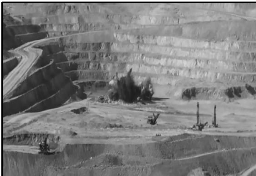
FOTO N° 24: Detonacion del proyecto de voladura en el Mini Tajo.
