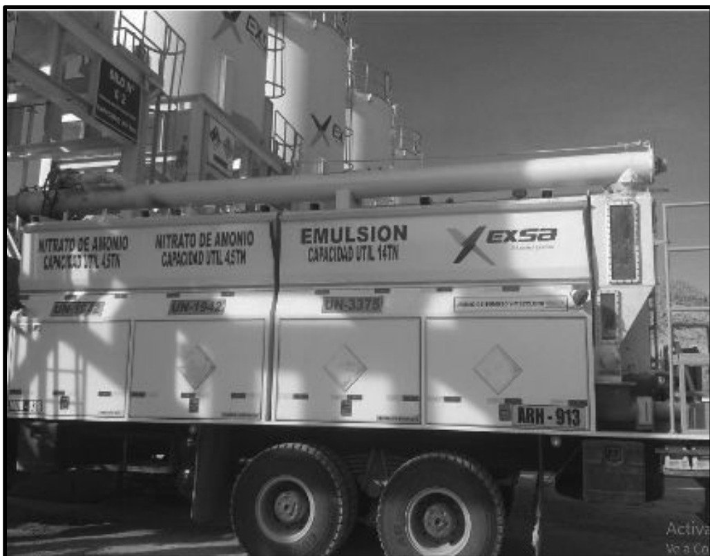
FOTO N° 07: Abastecimiento de agentes de voladura en la cancha de nitrato.
