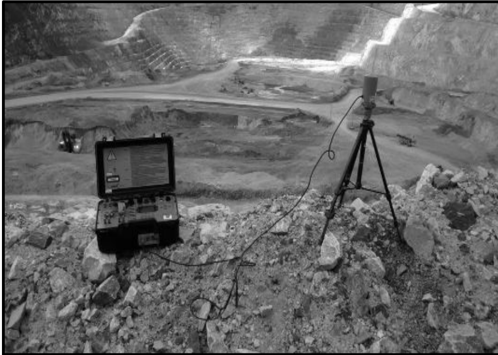
FOTO N° 22: Instalacion del base station.
