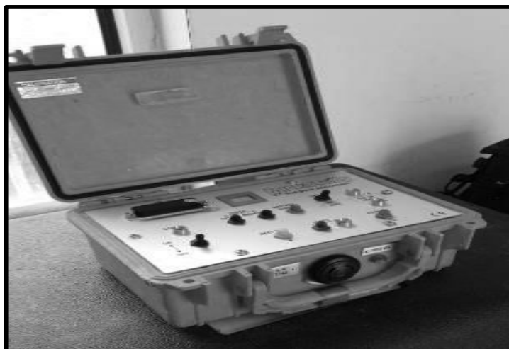
Figura N° 48: Equipo Microtrap en gabinete.
