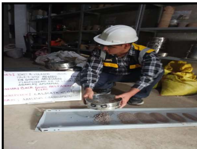
Figura 24 — Partículas retenidas en cada tamiz C-04
