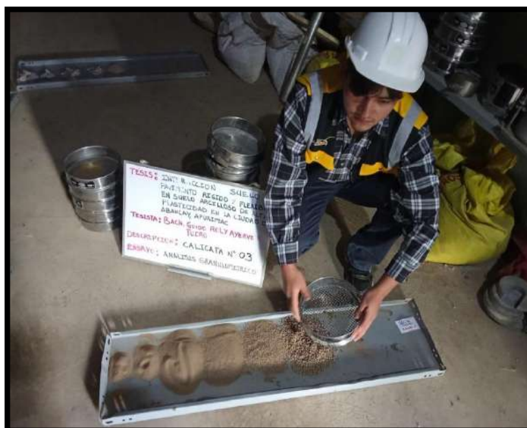
Figura 22 — Partículas retenidas en cada tamiz C-3
