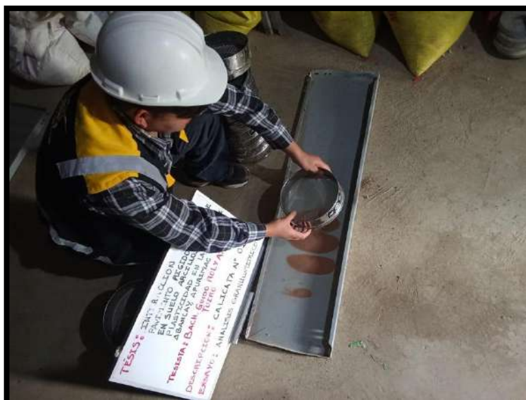
Figura 19 — Partículas retenidas en cada tamiz C-01
