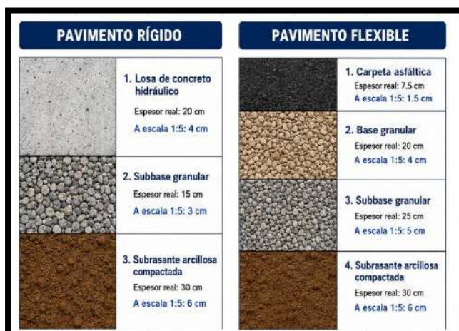
Figura 2 — losas a escala del pavimento rígido y flexible
