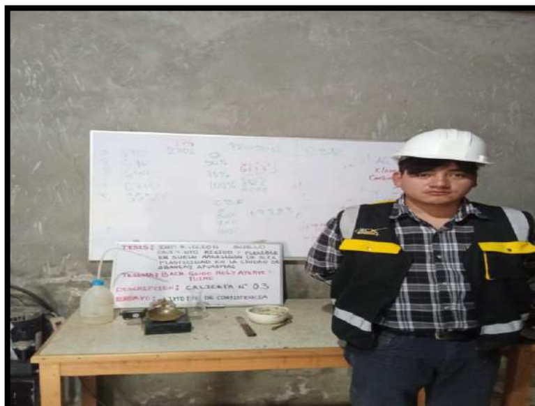
Figura 27 — Límites de consistencia- Límite Plástico C-6
