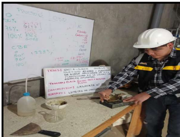
Figura 23 — Límites de consistencia- límite plástico C-02
