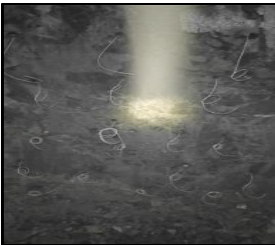
Figura 43 — Carguío de frente GL 599 Nv 8
