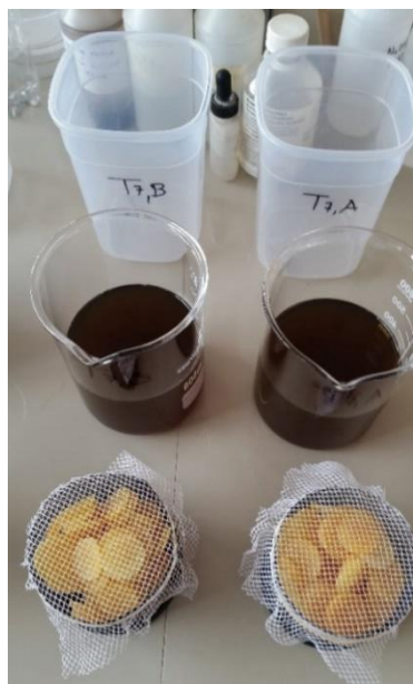
Anexo 10. Fotografías de Inmersión de láminas mashua en la solución sacarosa, deshidratación osmótica en baño maría con agitación orbital, y drenado para realizar los análisis grados °Brix y peso.
