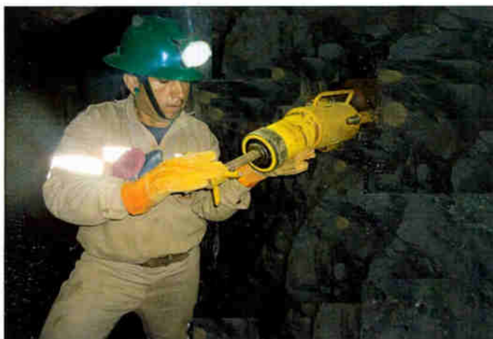
Fotografía 4. 6. Muestra el arranque de los soportes "Rs bolt" con el equipo "pull test" en el tajo 5960.
