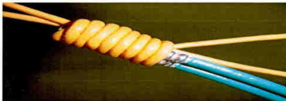
Fotografía 5. 7. Amarre de carmix con el cordón detonante para iniciar la voladura masiva no eléctrica.
