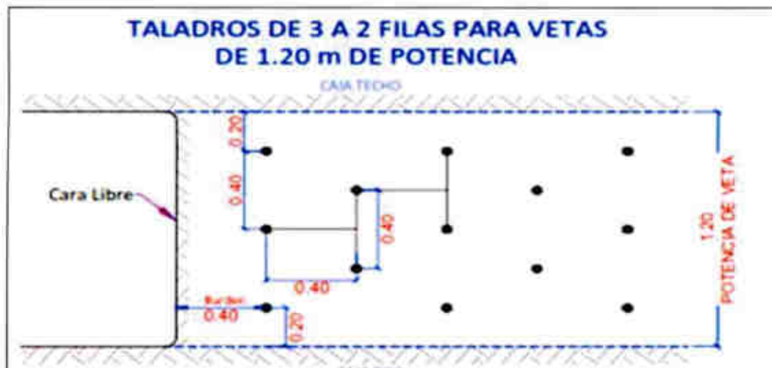
Figura 4. 12. Malla de perforación para veta (av) de 1.20m
