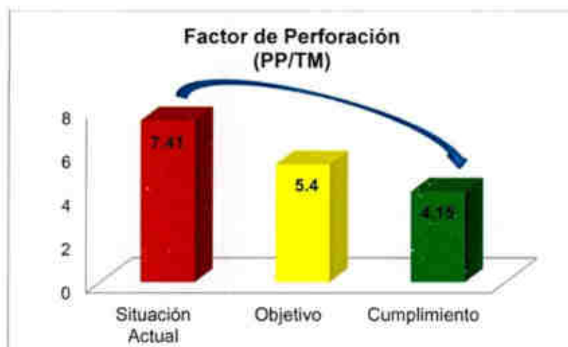
Figura 5. 9. Muestra la reducción de los pies perforados.
