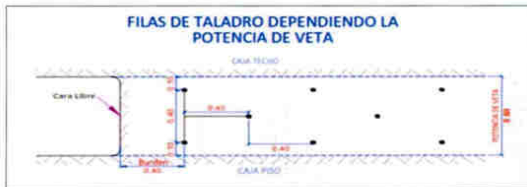
Figura 4. 11. Malla de perforación para veta (av) de 0.60m.
