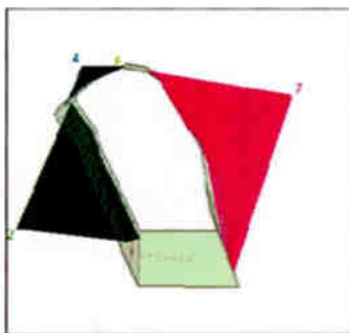
Figura 4. 7. Muestra de las cuñas en la caja techo y piso.
