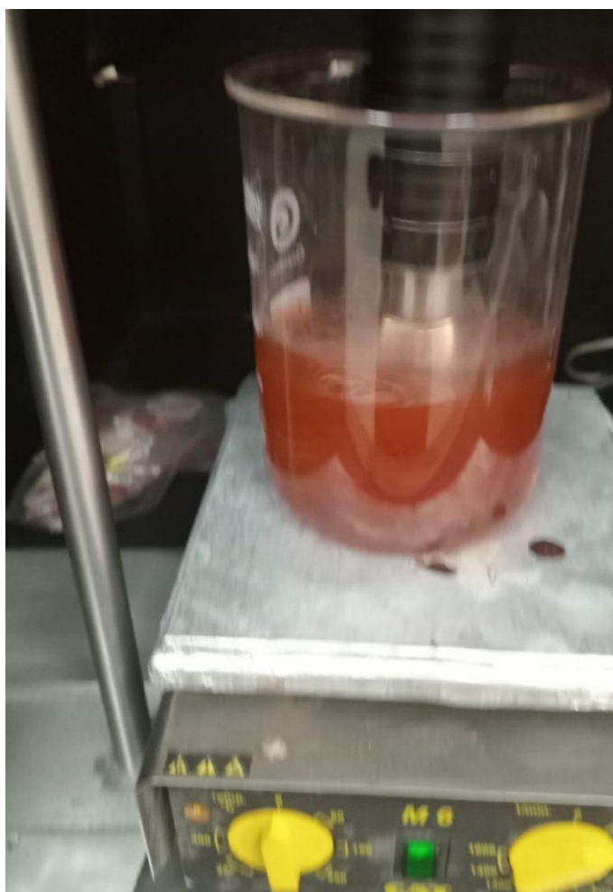
Figura 9. Descarga de plasma a presión atmosférica sobre solución acuosa de colorante de cochinilla Laboratorio-UNMSM.
