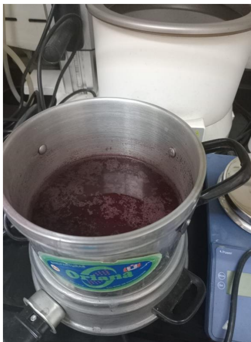
Figura 10. Proceso de hervido de cochinilla para homogenizar la solución acuosa- Laboratorio - UNMSM.
