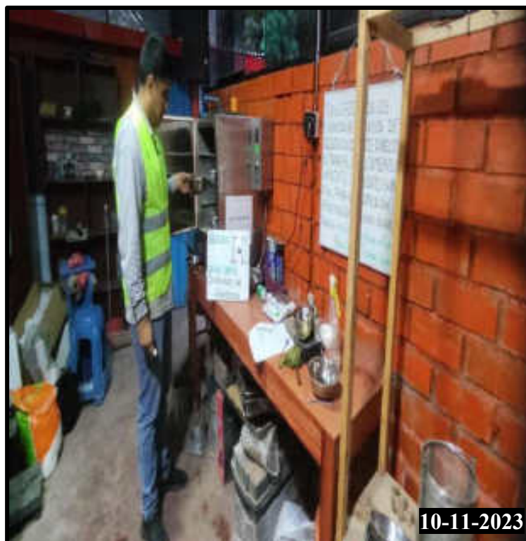
Figura 208 — Realización del ensayo de contenido de humedad de la calicata 01
