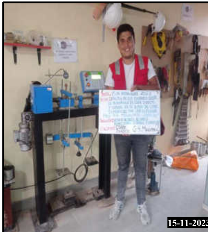
Figura 246 — Realización del ensayo de corte directo de la calicata 04 muestra 02
