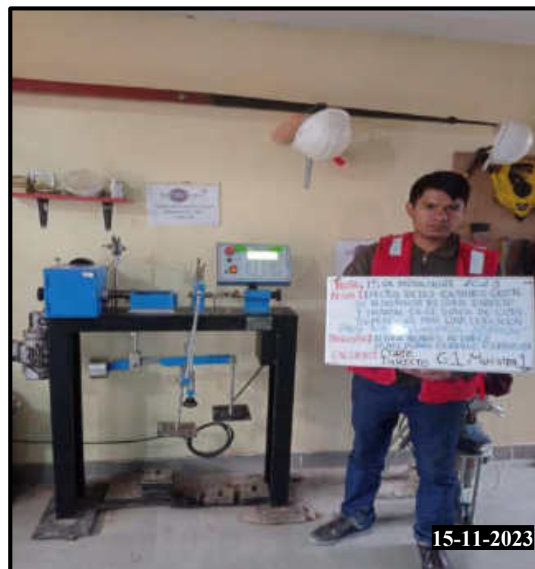
Figura 233 — Realización del ensayo de corte directo de la calicata 01 muestra 01
