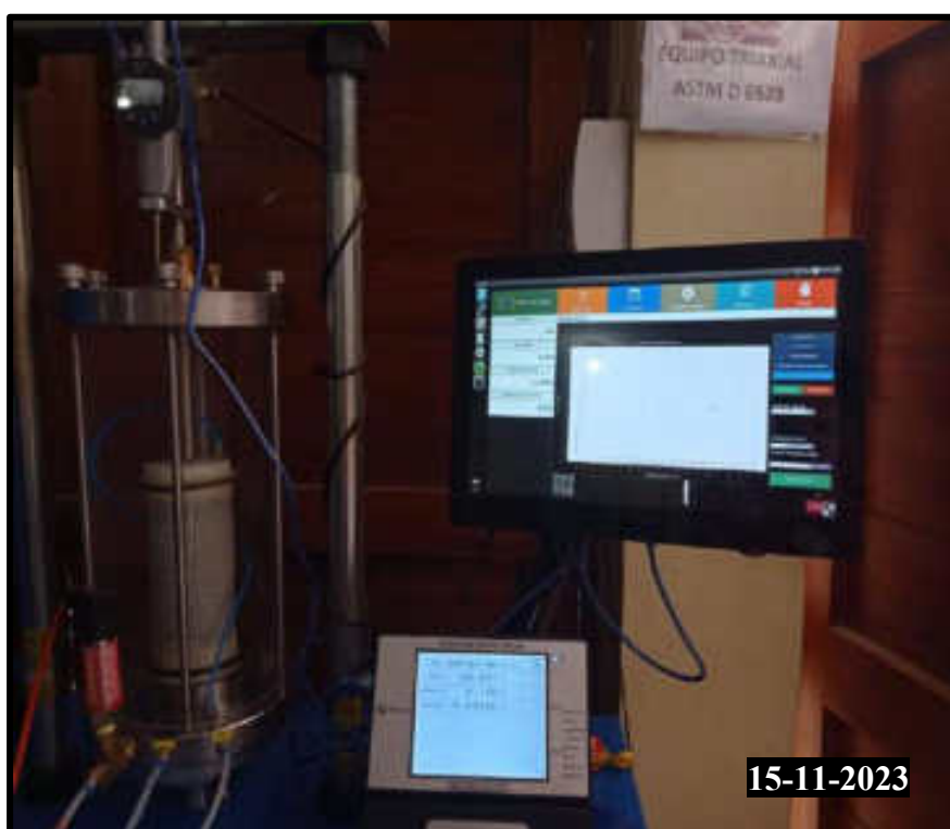
Figura 249 — Realización del ensayo de compresión triaxial
