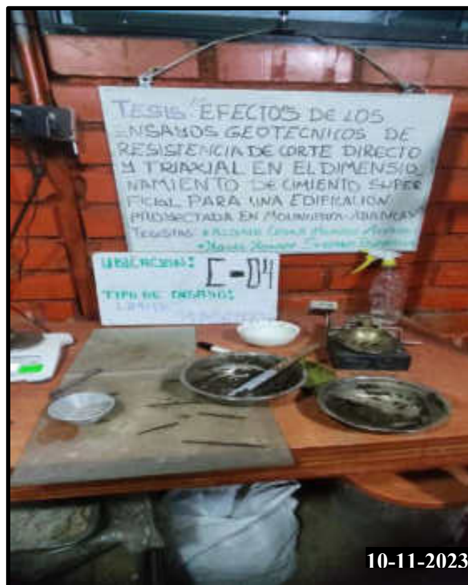
Figura 207 — Realización del ensayo limite plástico de la calicata 04
