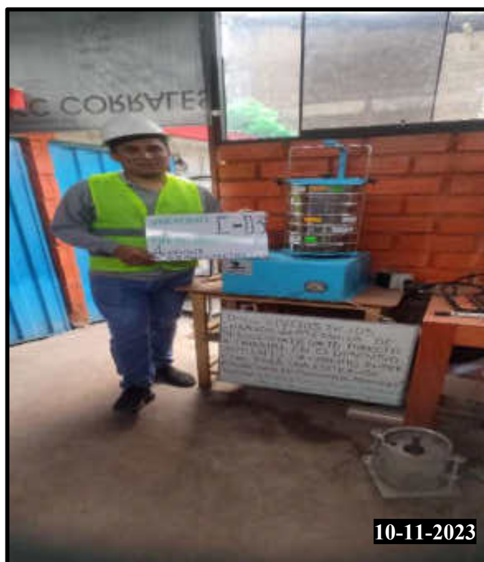
Figura 190 — Realización del ensayo granulométrico por tamizado de la calicata 03
