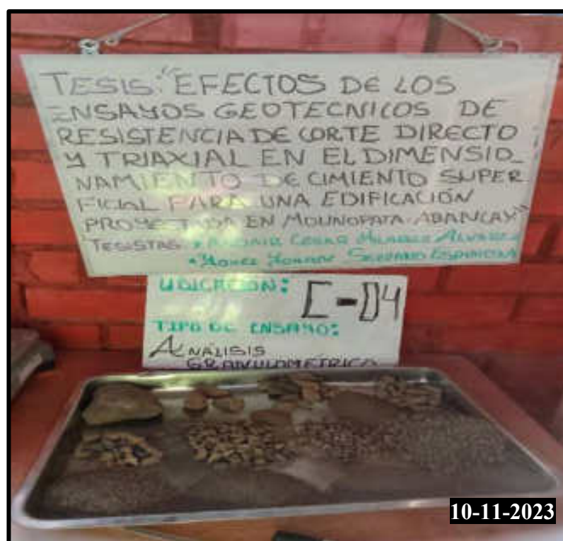
Figura 193 — Ensayo granulométrico de la calicata 04
