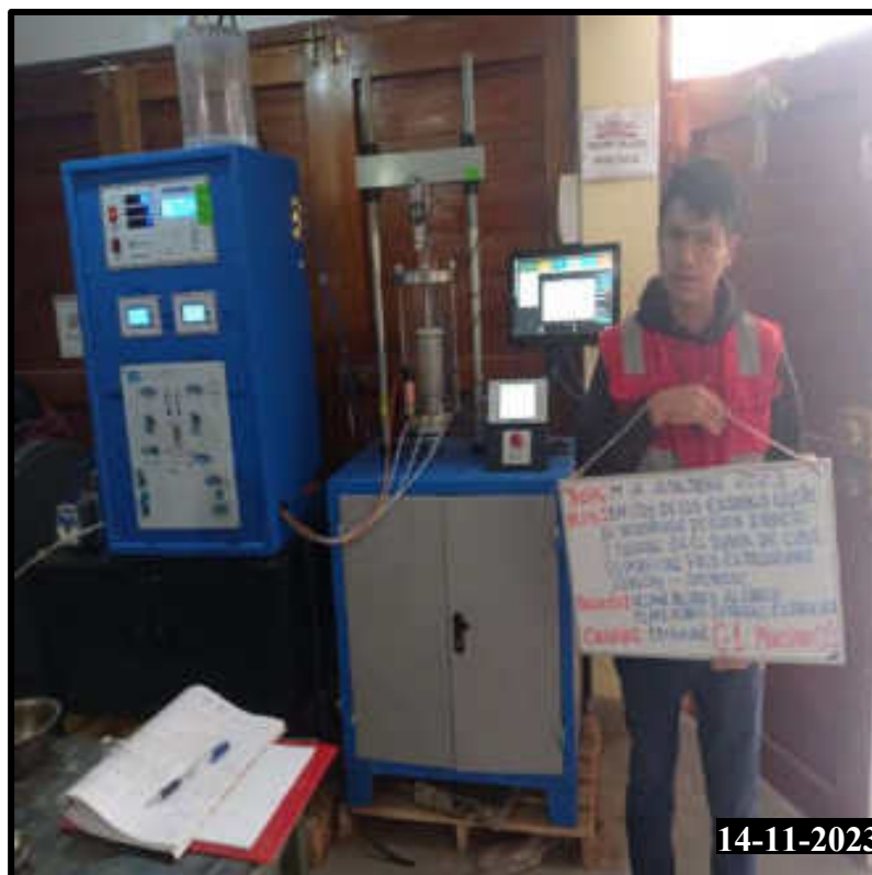
Figura 216 — Realización del ensayo de compresión triaxial, preparación de calicata 01 muestra 01
