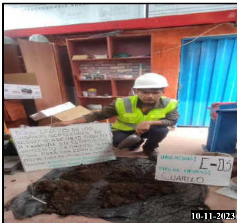
Figura 184 — Realización del Cuarteo manual de la calicata 03.
