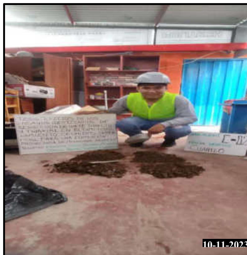
Figura 183 — Realización del Cuarteo manual de la calicata 02
