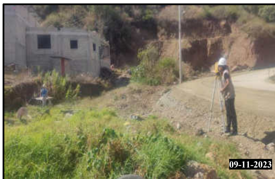
Figura 167 — Levantamiento topográfico del terreno de estudio con estación total en el sector de Molinopata
