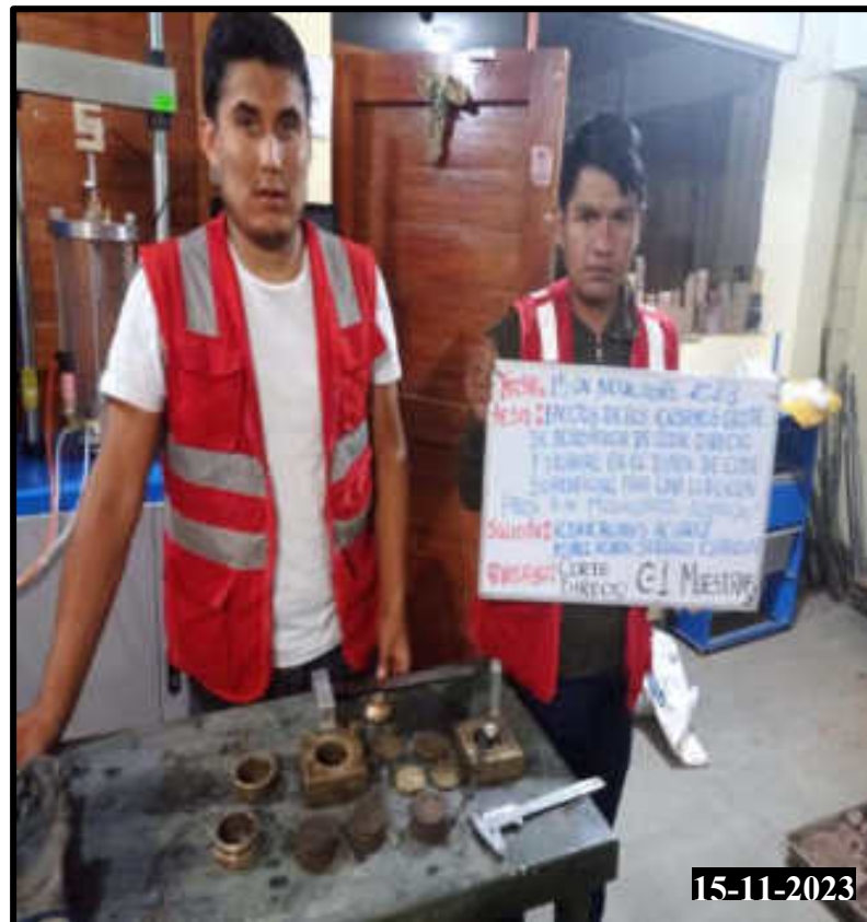
Figura 236 — Especímenes del ensayo corte directo de las muestras 01,02 y 03 de la calicata 01
