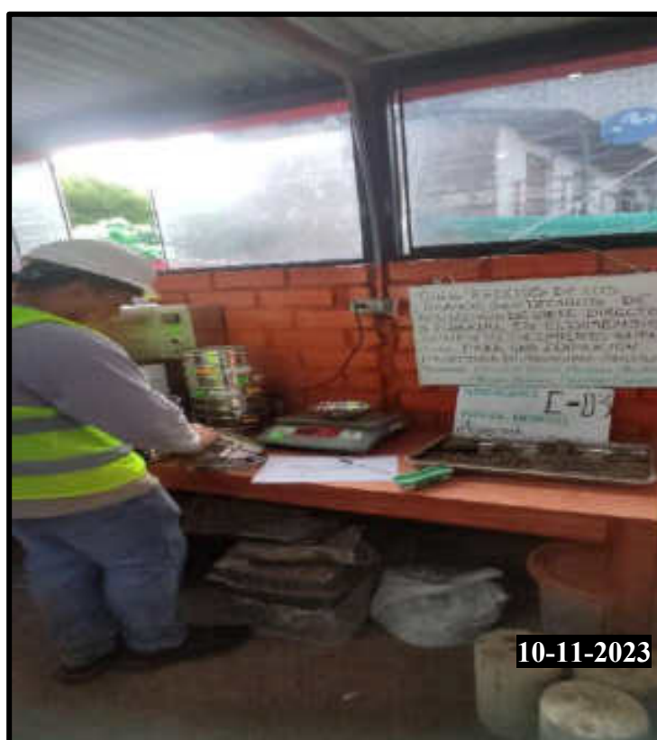
Figura 191 — Ensayo granulométrico de la calicata 03
