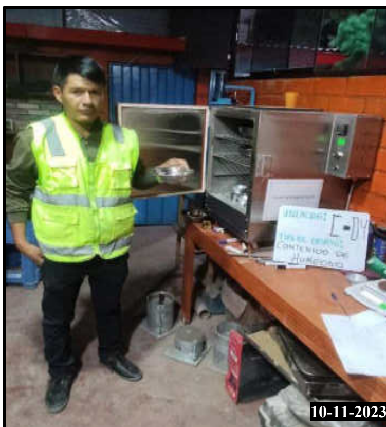
Figura 211 — Realización del ensayo de contenido de humedad de la calicata 04
