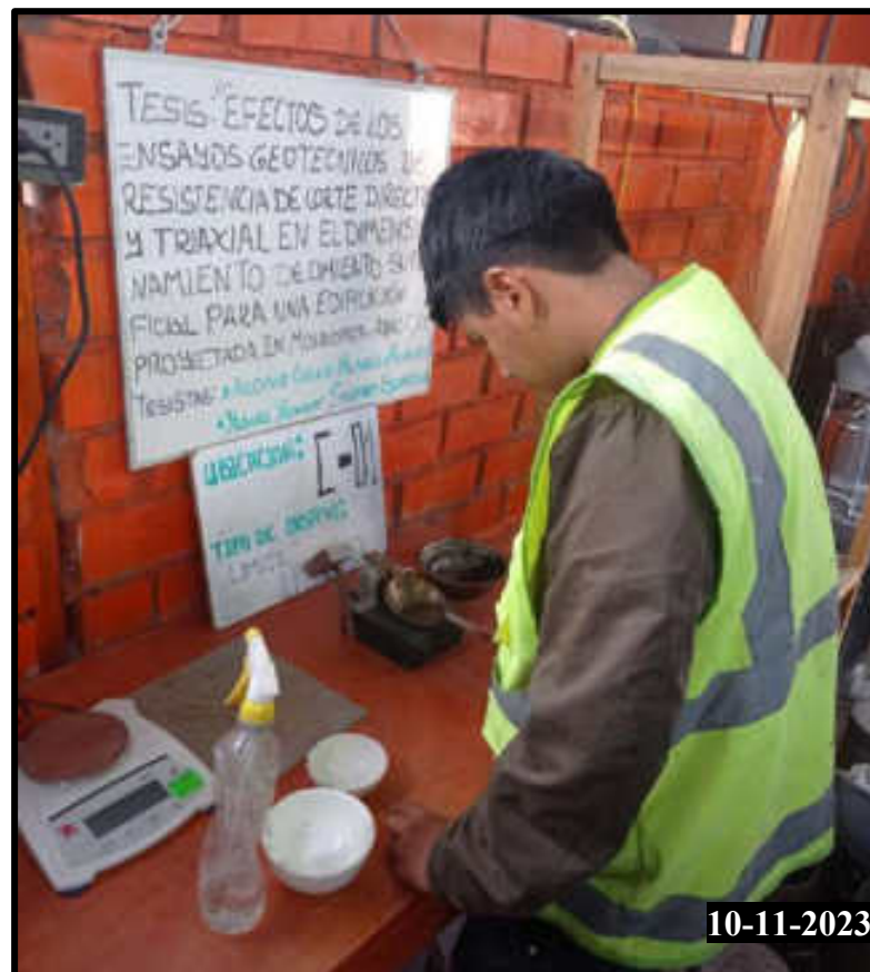
Figura 194 — Realización del ensayo limite liquido de la calicata 01
