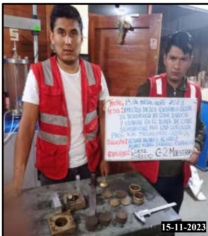
Figura 240 — Especímenes del ensayo corte directo de las muestras 01,02 y 03 de la calicata 02
