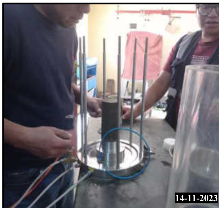
Figura 214 — Realización del ensayo de compresión triaxial muestra moldeado para realizar el ensayo
