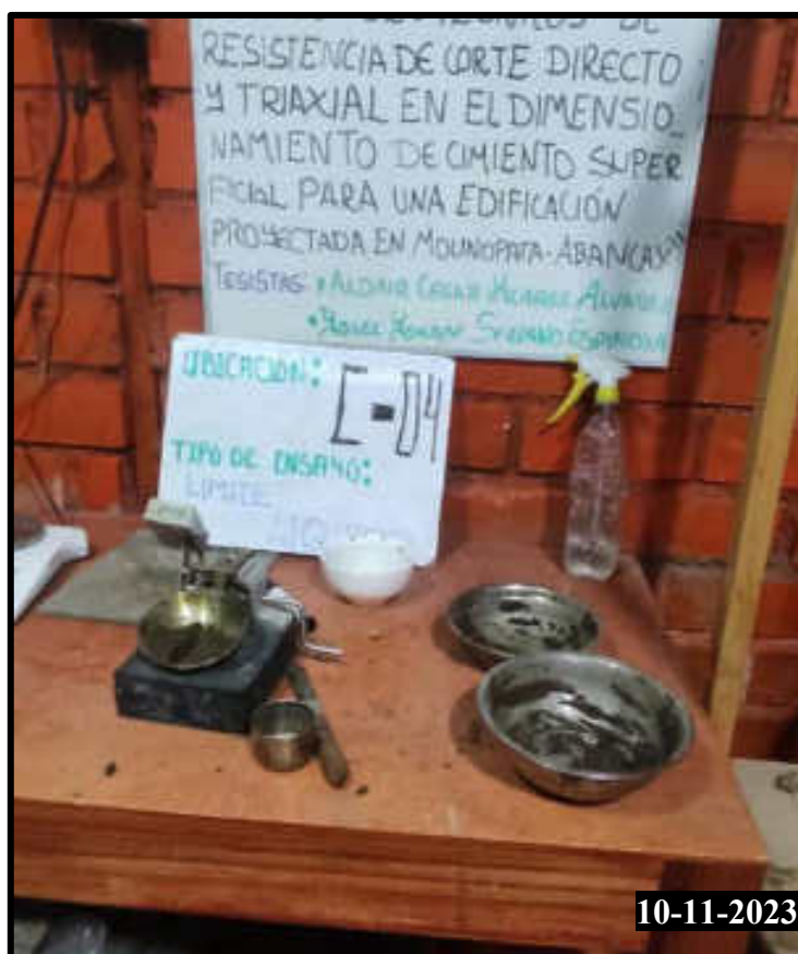
Figura 199 — Realización del del ensayo limite liquido de la calicata 04
