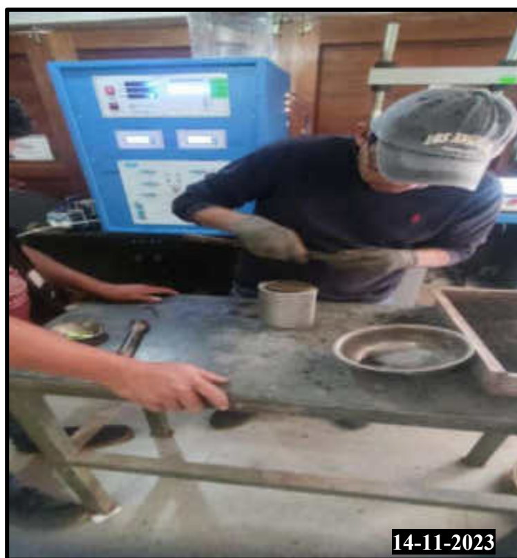
Figura 213 — Preparación y moldeamiento de la muestra 01 del ensayo de compresión triaxial
