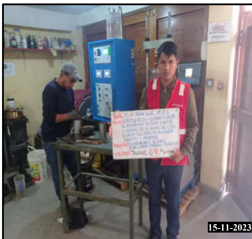
Figura 228 — Realización del ensayo de compresión triaxial, preparación del espécimen de calicata 04 muestra 03
