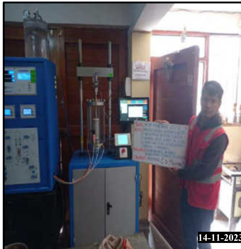
Figura 224 — Realización del ensayo de compresión triaxial, preparación del espécimen de calicata 03 muestra 02
