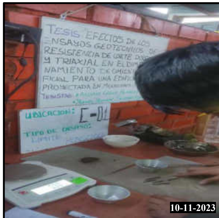
Figura 200 — Realización del del ensayo de limite plástico de la calicata 01
