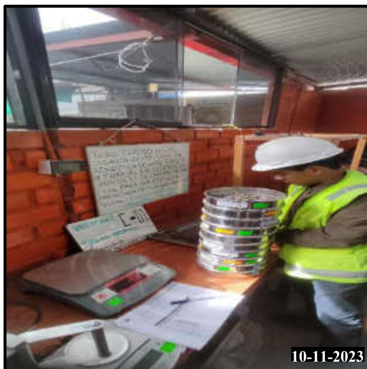
Figura 186 — Realización del ensayo granulométrico por tamizado de la calicata 01
