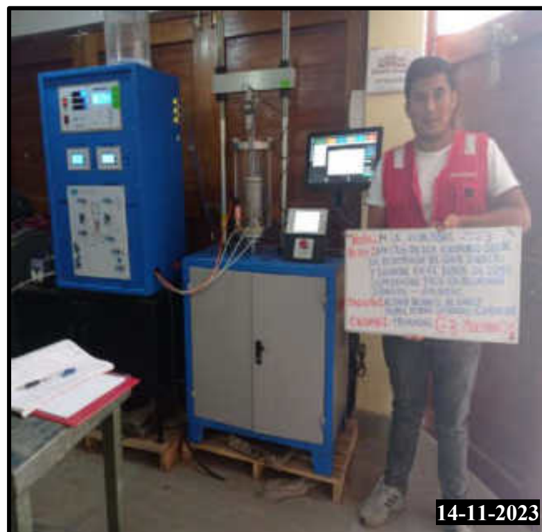
Figura 223 — Realización del ensayo de compresión triaxial, preparación del espécimen de calicata 03 muestra 01
