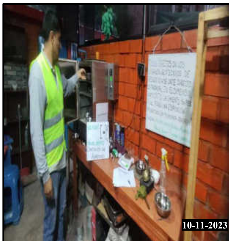
Figura 210 — Realización del ensayo de contenido de humedad de la calicata 03
