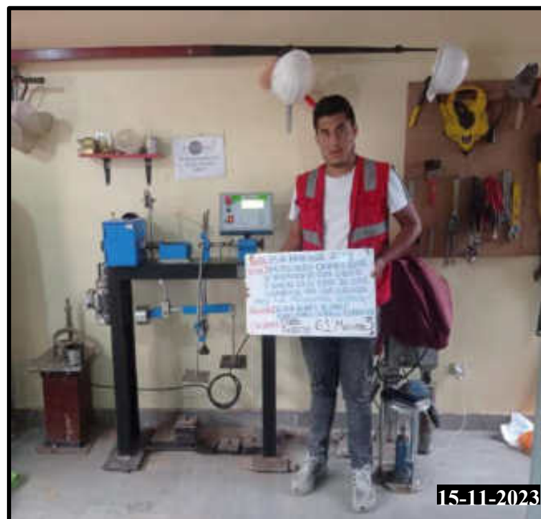
Figura 235 — Realización del ensayo de corte directo de la calicata 01 muestra 03
