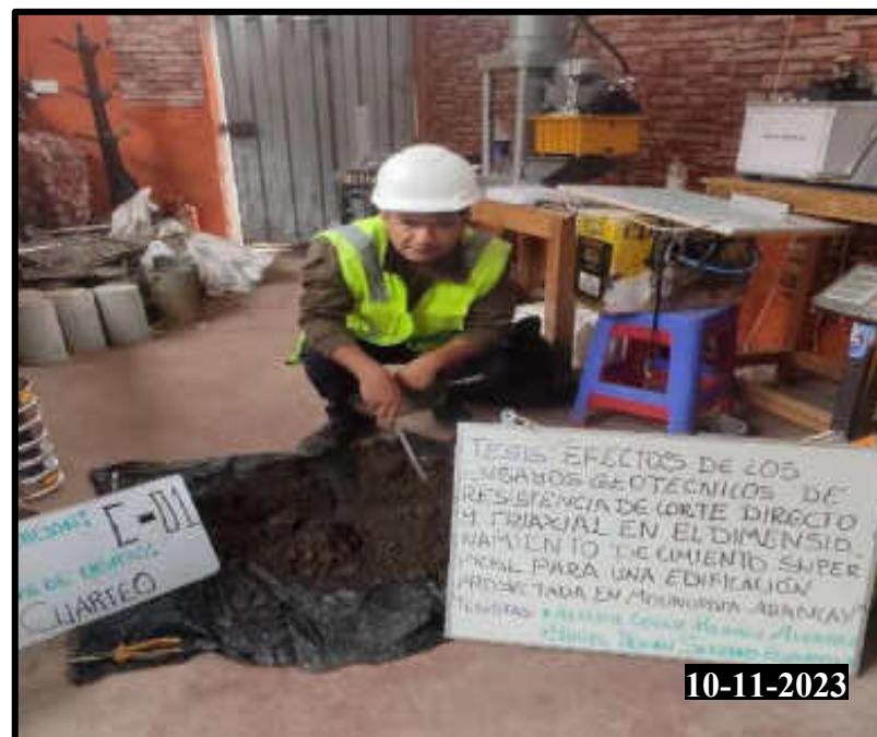
Figura 182 — Realización del Cuarteo manual de la calicata 01
