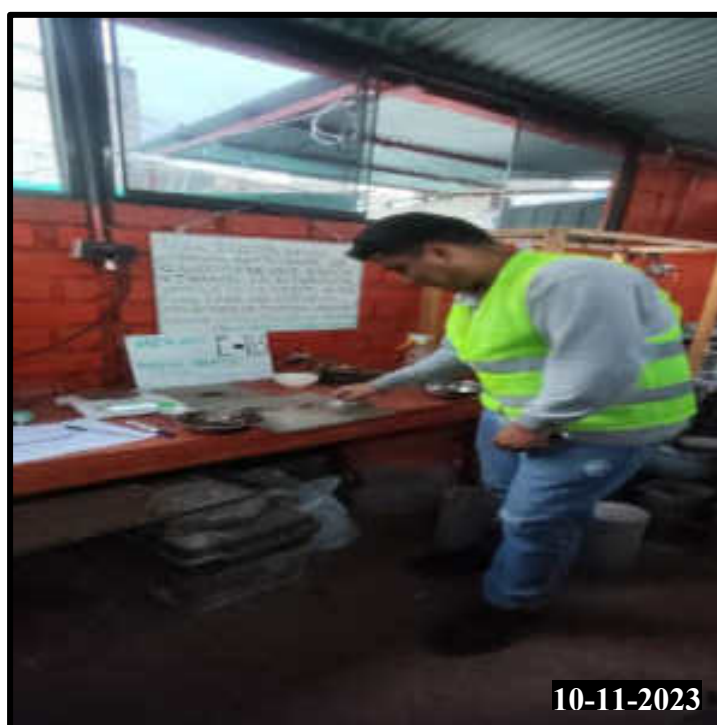
Figura 204 — Realización del ensayo de limite plástico de la calicata 03
