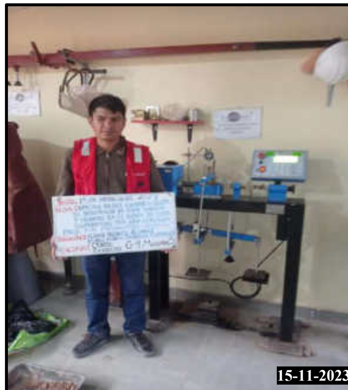
Figura 247 — Realización del ensayo de corte directo de la calicata 04 muestra 03
