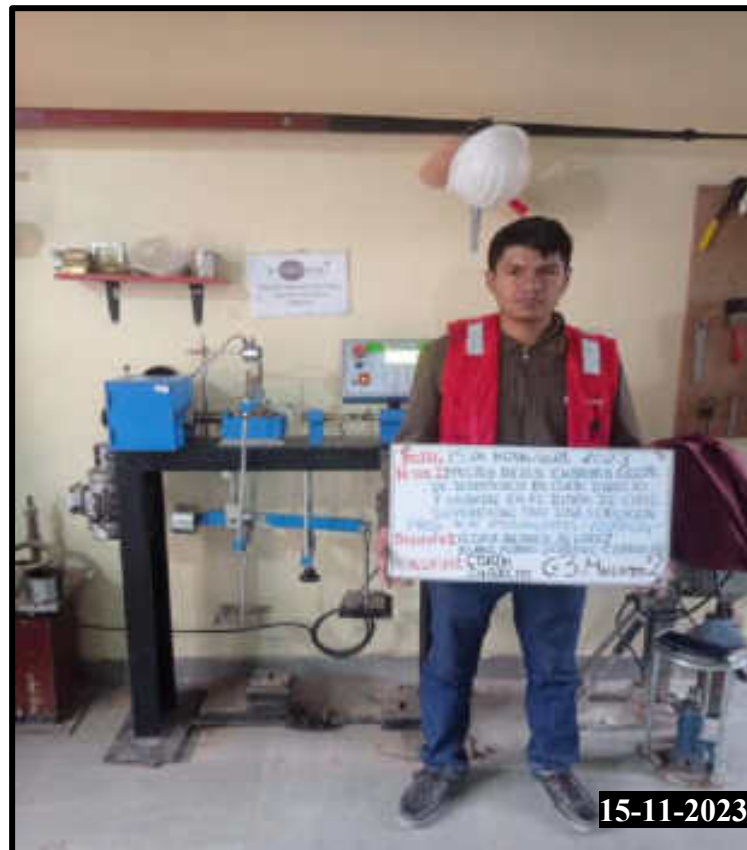
Figura 242 — Realización del ensayo de corte directo de la calicata 03 muestra 02
