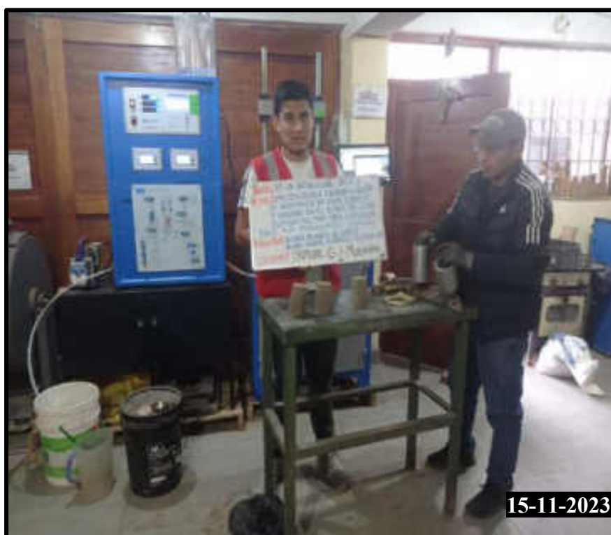
Figura 229 — Especímenes del ensayo triaxial de las muestras 01,02 y 03 de la calicata 01
