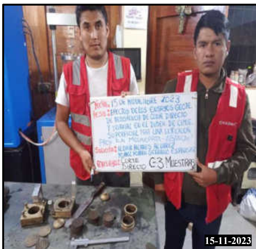
Figura 244 — Especímenes del ensayo corte directo de las muestras 01,02 y 03 de la calicata 03
