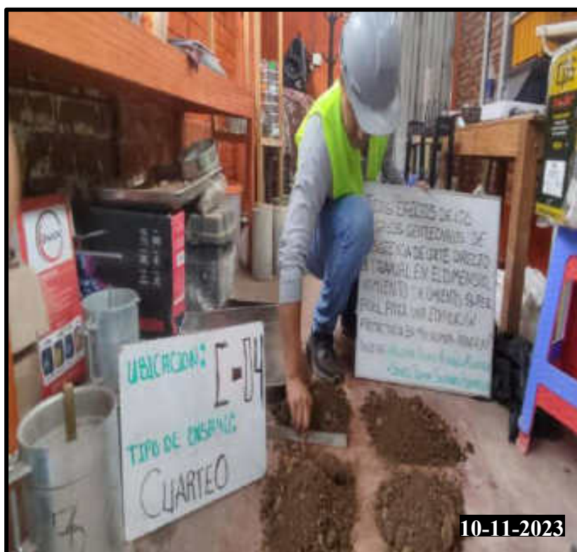
Figura 185 — Realización del Cuarteo manual de la calicata 04.
