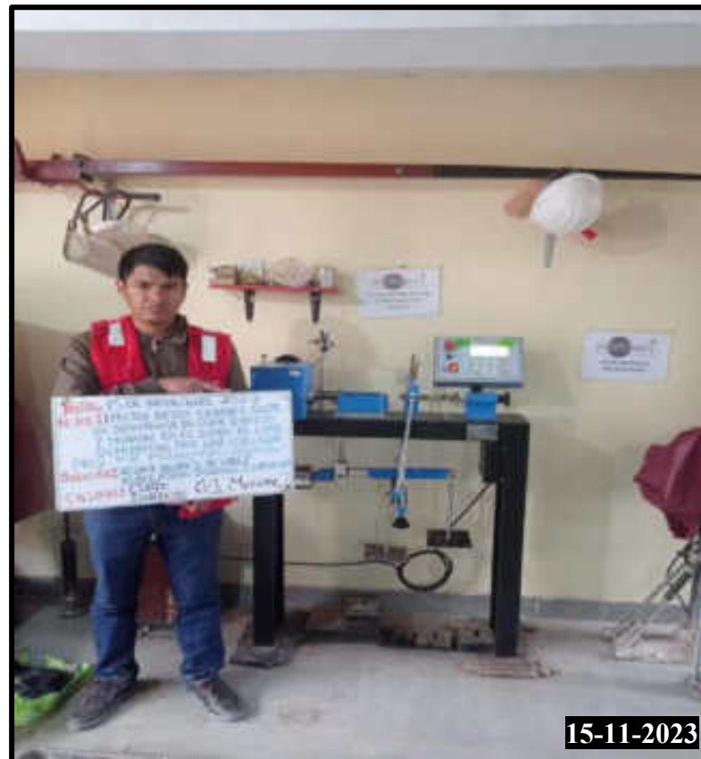
Figura 234 — Realización del ensayo de corte directo de la calicata 01 muestra 02
