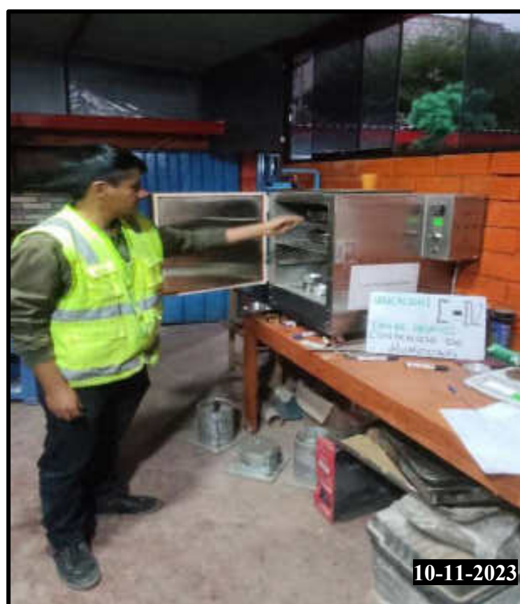
Figura 209 — Realización del ensayo de contenido de humedad de la calicata 02
