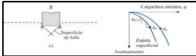
Figura 20 — Falla por corte de punzonamiento
