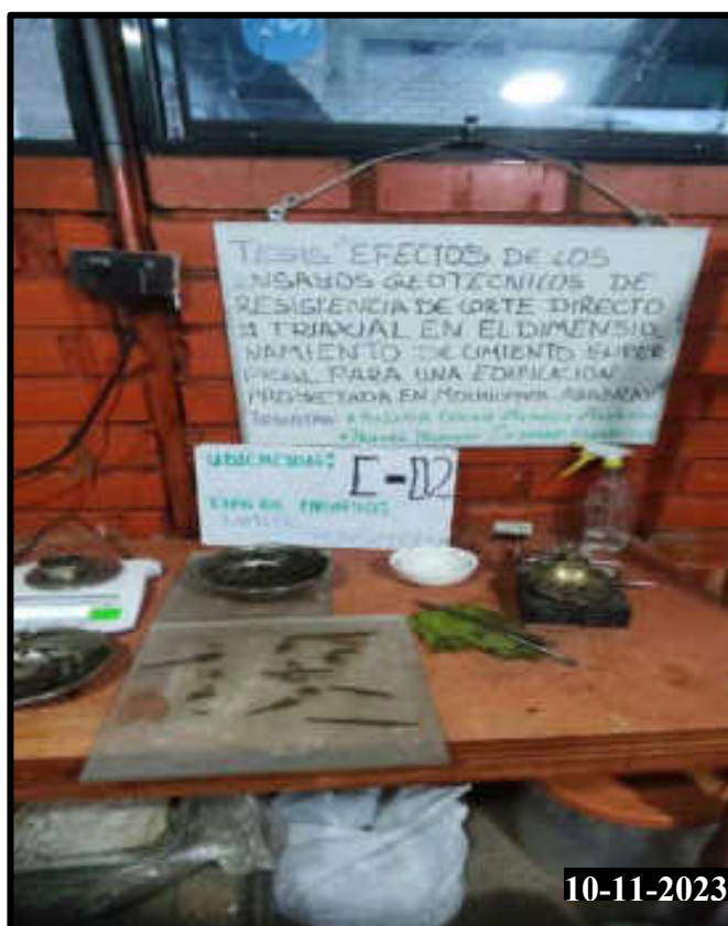
Figura 203 — Realización del ensayo limite plástico de la calicata 02
