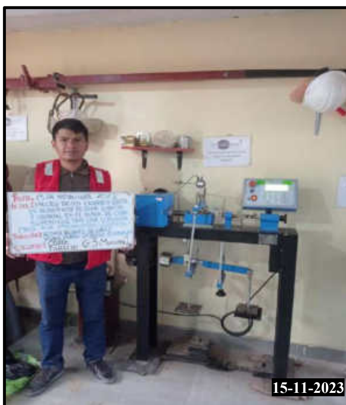
Figura 241 — Realización del ensayo de corte directo de la calicata 03 muestra 01
