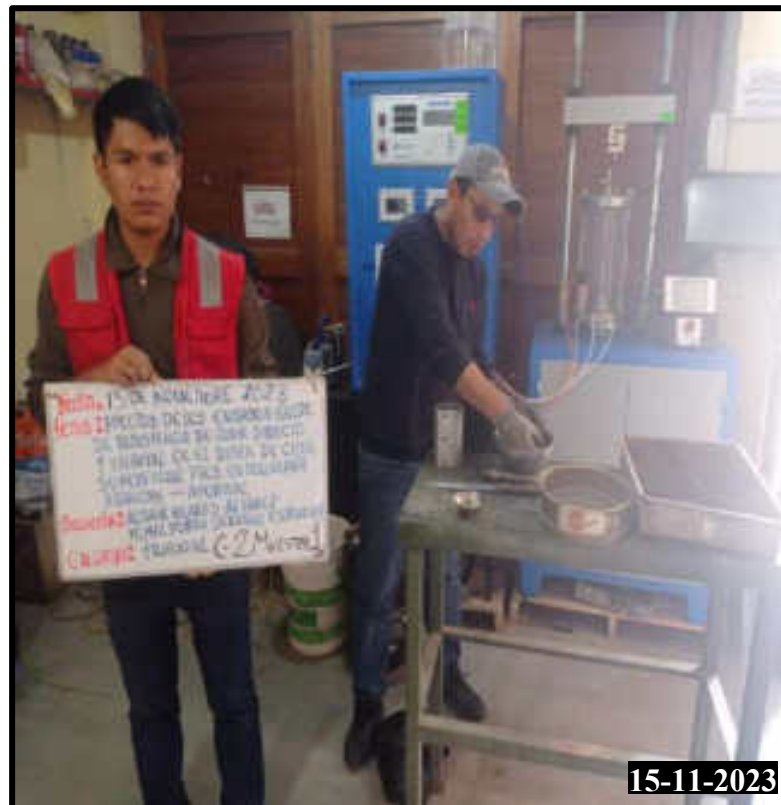
Figura 220 — Realización del ensayo de compresión triaxial, preparación del espécimen de calicata 02 muestra 01
