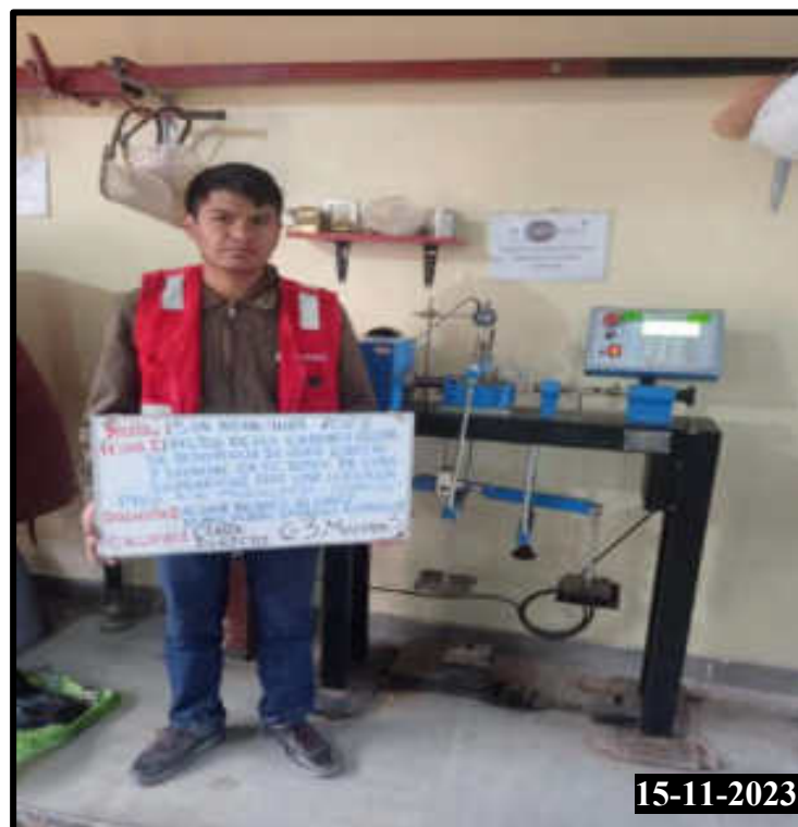
Figura 243 — Realización del ensayo de corte directo de la calicata 03 muestra 03
