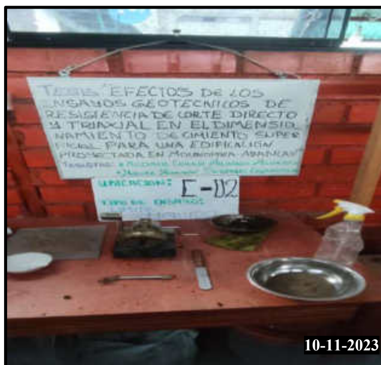
Figura 197 — Realización del del ensayo limite liquido de la calicata 02
