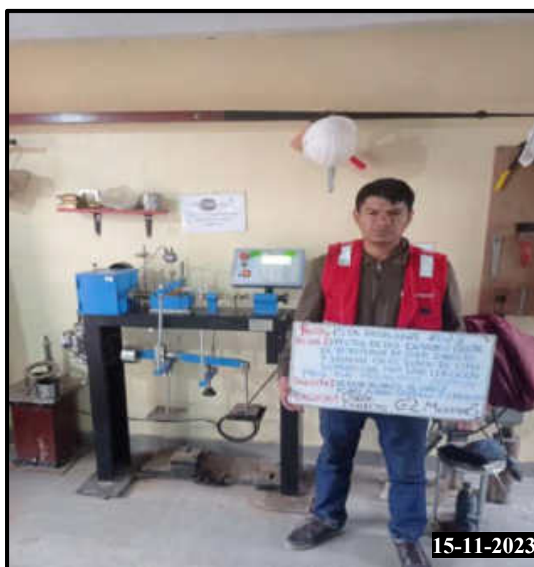
Figura 239 — Realización del ensayo de corte directo de la calicata 02 muestra 03
