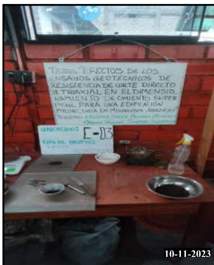
Figura 205 — Realización del ensayo limite plástico de la calicata 03
