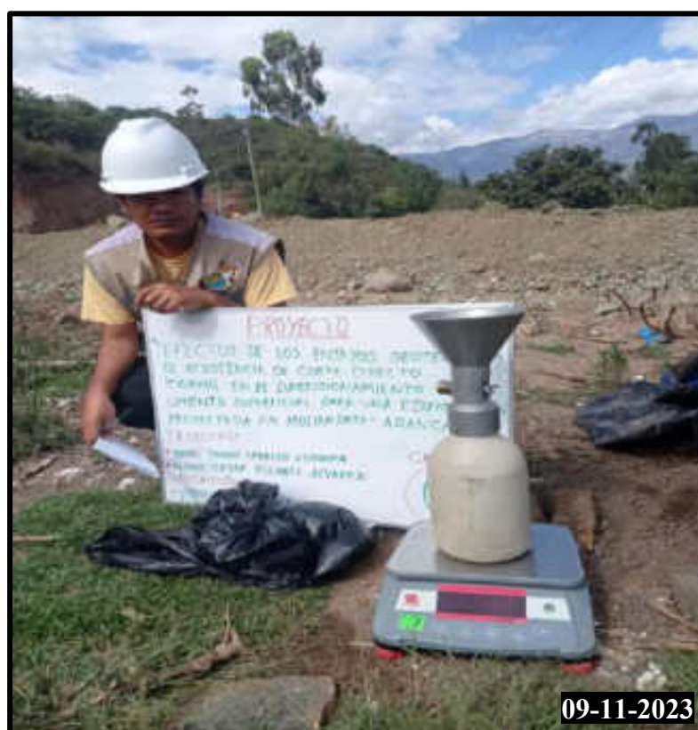
Figura 181 — Densidad de campo in-situ en la calicata 04
