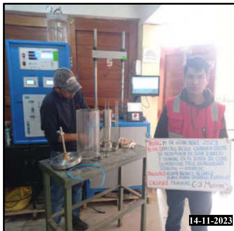
Figura 225 — Realización del ensayo de compresión triaxial, preparación del espécimen de calicata 03 muestra 03
