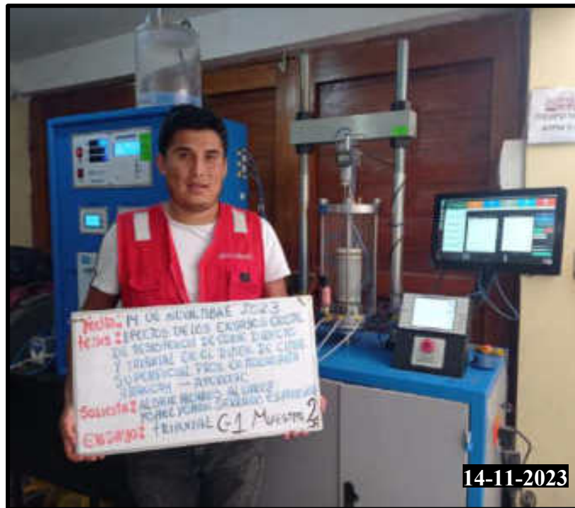
Figura 218 — Ejecución del ensayo de compresión triaxial, preparación de calicata 01 muestra 02
