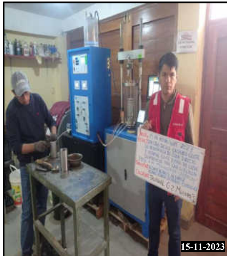
Figura 222 — Realización del ensayo de compresión triaxial, preparación del espécimen de calicata 02 muestra 03
