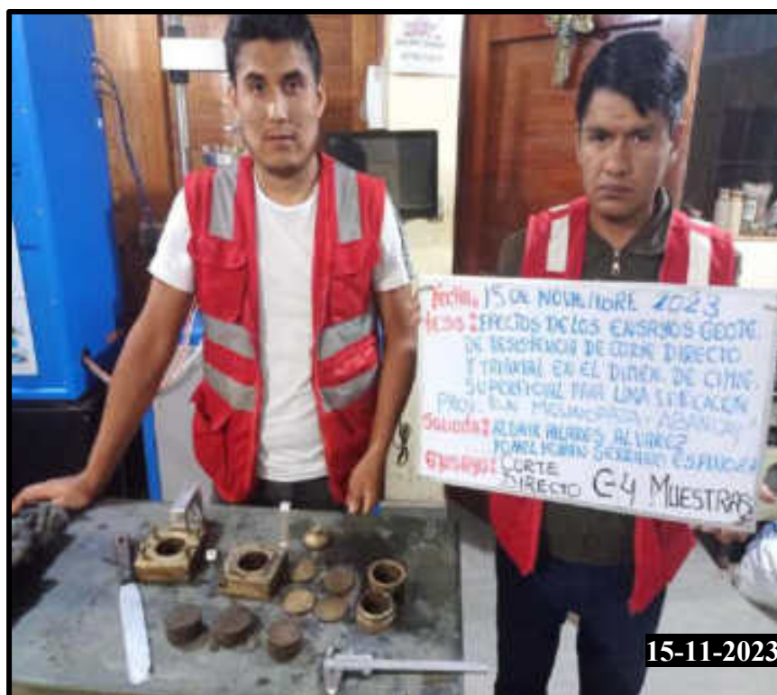
Figura 248 — Especímenes del ensayo corte directo de las muestras 01,02 y 03 de la calicata 04
