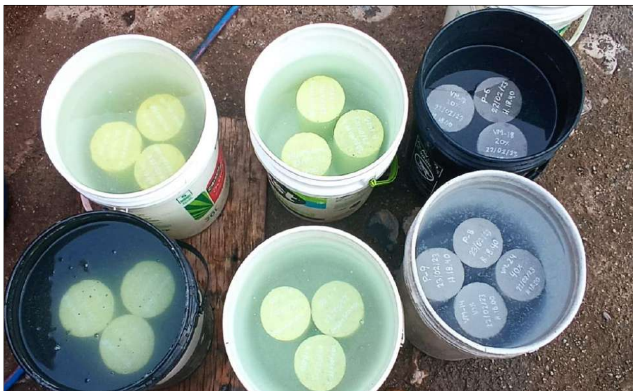
Figura 65 — Curado de especímenes de concreto a la edad de 7días, 14días y 28 días
