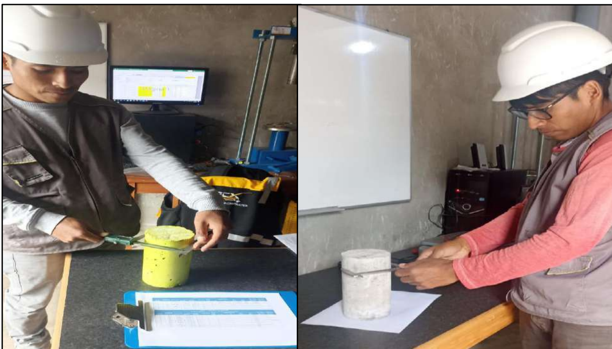
Figura 71 — Medidas del diámetro de la sección transversal de los especímenes antes del ensayo
