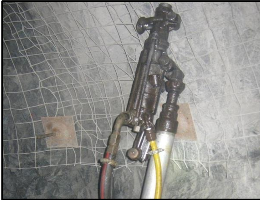
Figura 18 — Martillo neumático Jackleg
