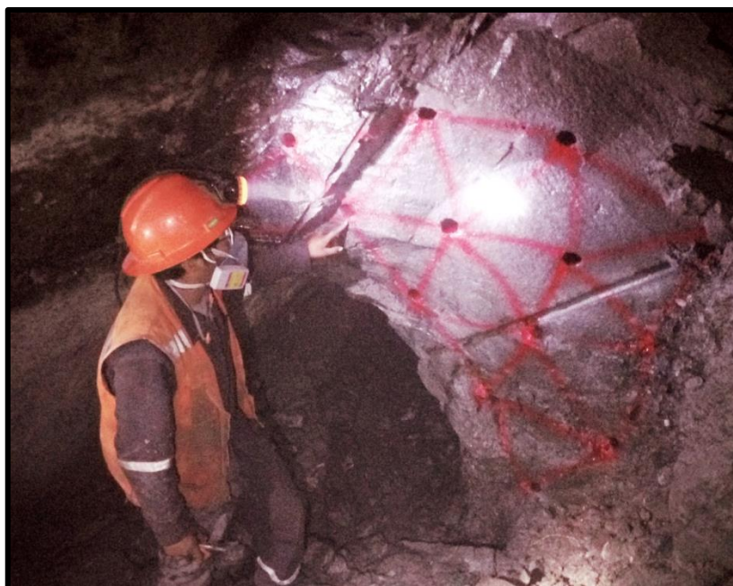
Figura 17 — Diseño de malla de perforación
