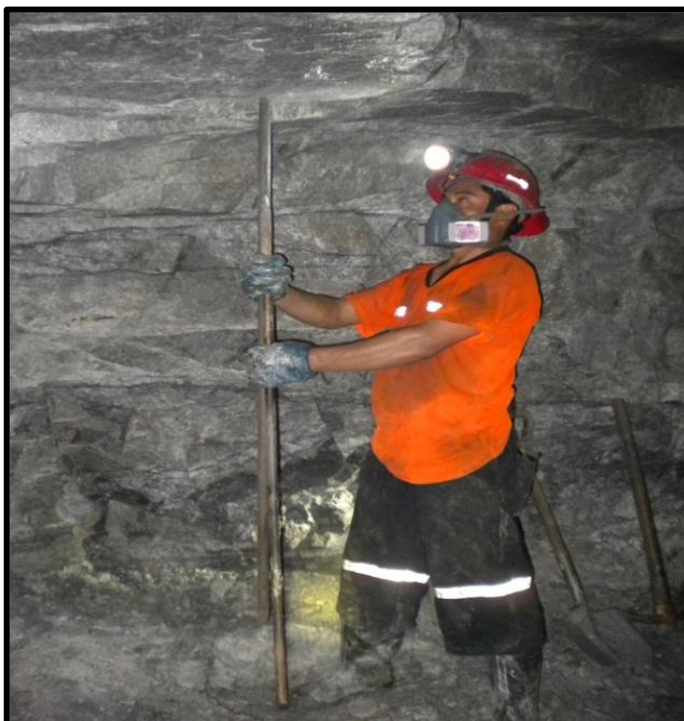
Figura 15 — Marcación con la varilla de madera (atacador) la perpendicularidad entre el puntal y la caja techo, considerando una superficie plana de contacto.
