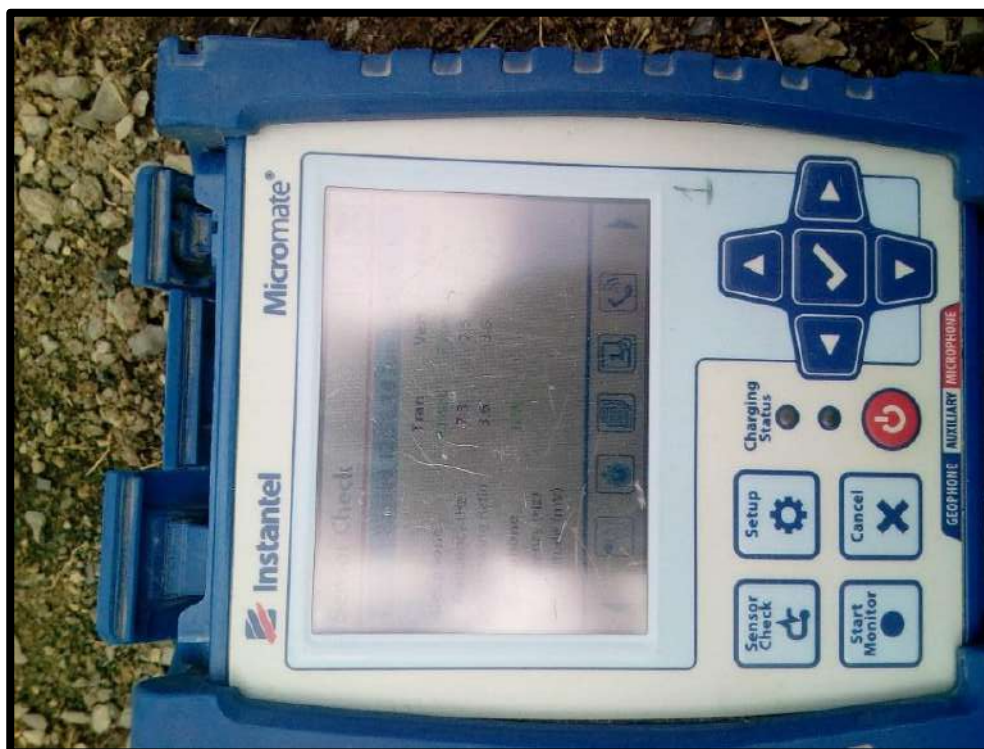
Figura 26 — Equipo N°02 instantel micromate utilizado en el registro de vibraciones
