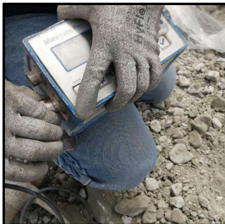
Figura 32 — Instalación del geófono con sismógrafo punto de monitoreo 9
