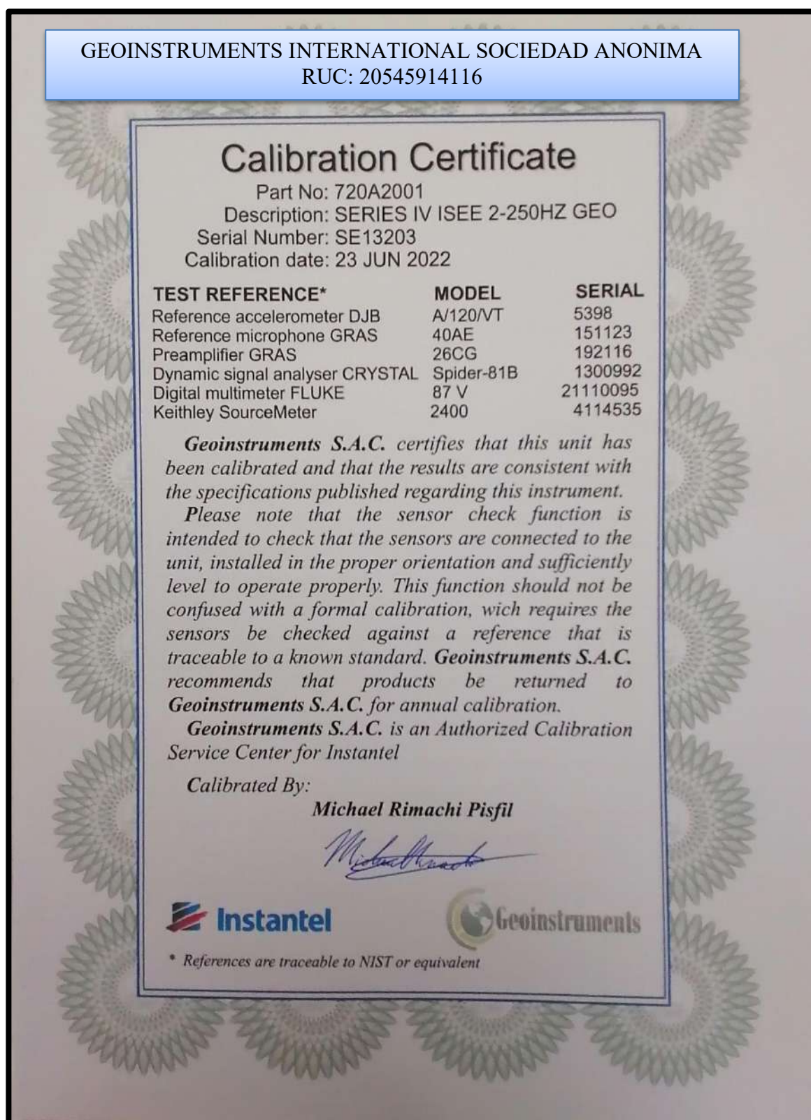
Figura 27— Certificado de calibración del equipo N°01 instantel minimate pro utilizado en el registro de vibraciones
