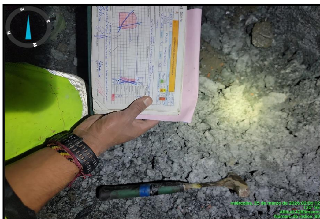
Figura 26 — Uso de picota y brújula en campo para determinar el tipo de terreno.
