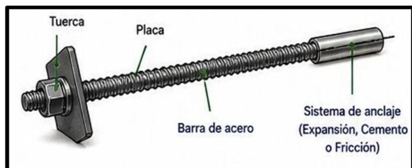
Figura 7 — Sostenimiento activo recomendado para labores tipo IVB U.M Inmaculada
