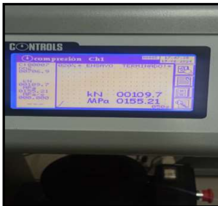
Figura 19 — Datos obtenidos durante la prueba de compresión en testigos.
