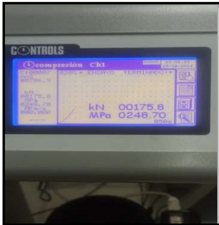
Figura 18 — Datos obtenidos durante la prueba de compresión en testigos.
