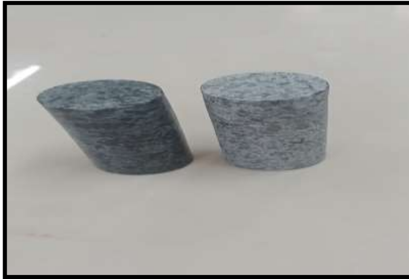
Figura 8 — Testigos obtenidos de las muestras de campo para las pruebas en laboratorio de Geomecánica de la Universidad Nacional Micaela Bastidas de Apurímac.
