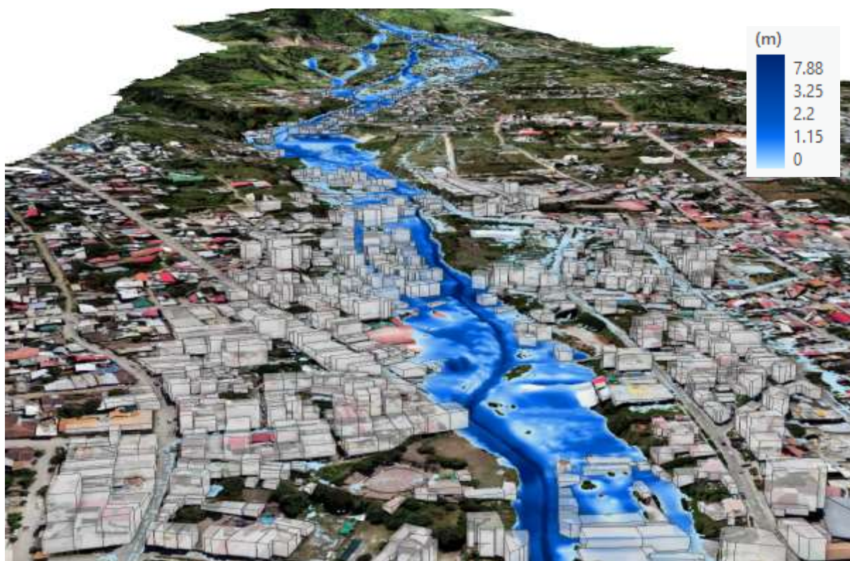
Figura 104 — Catastro urbano y la mancha de inundación
