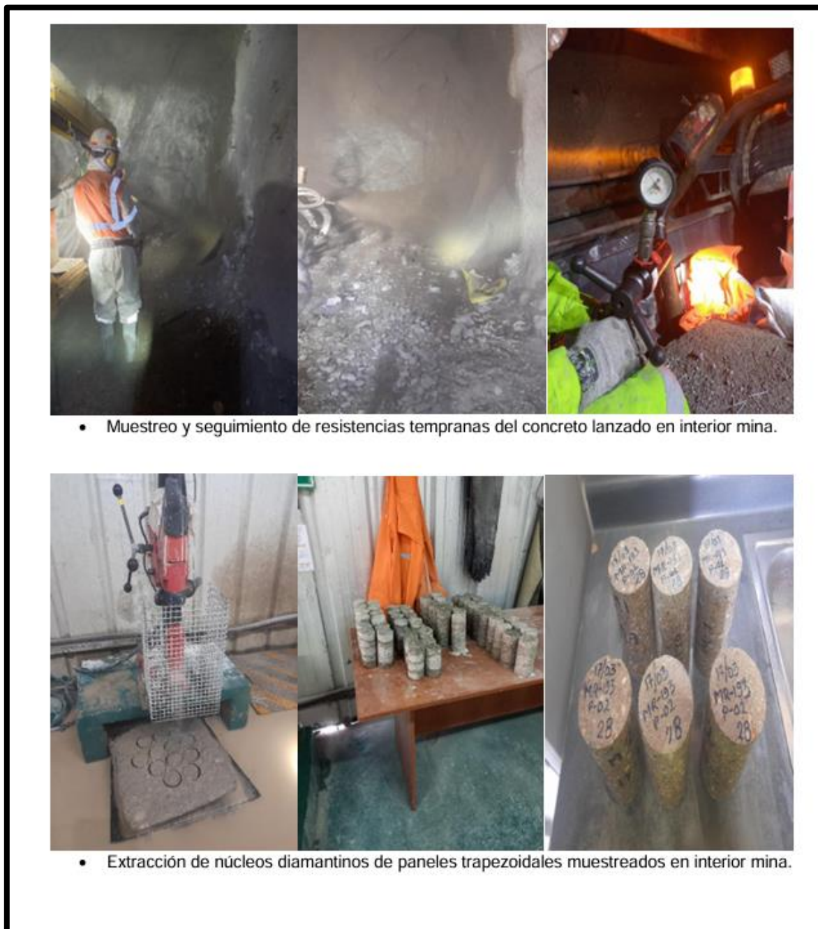
Figura 59 — Muestreo y seguimiento de resistencias tempranas del concreto lanzado en interior mina, parte 2
