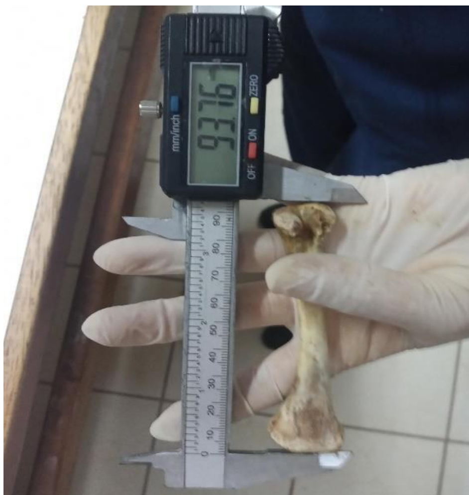
Figura 3. Fotografía de la medición de muestras óseas con calibrador Vernier
