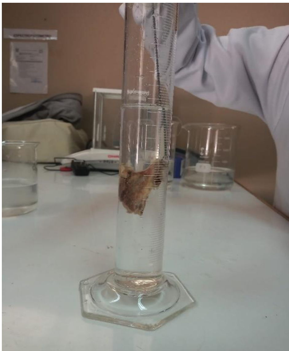
Figura 4. Fotografía de la estimación del volumen de muestras óseas haciendo uso de probeta
