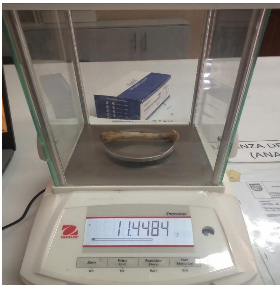
Figura 2. Fotografía del pesaje de muestras óseas en balanza analítica
