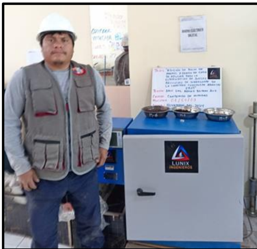
Figura 50 — Ensayo de contenido de humedad del suelo natural.
