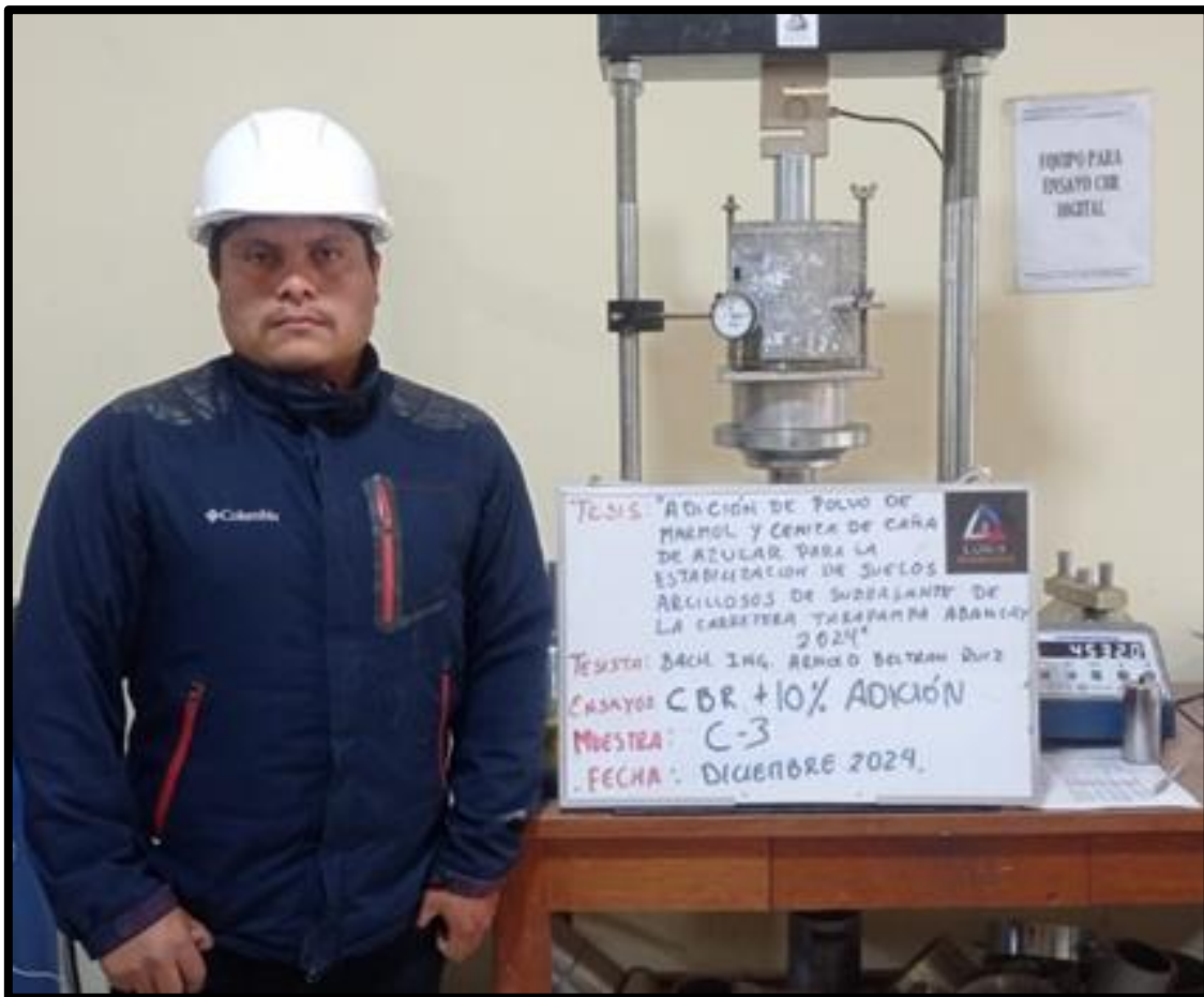
Figura 54 — Prueba de penetración, suelo con polvo de mármol y CBCA.
