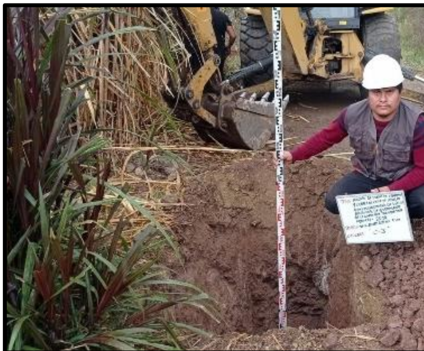
Figura 49 — Recolección de muestras de suelo en campo.
