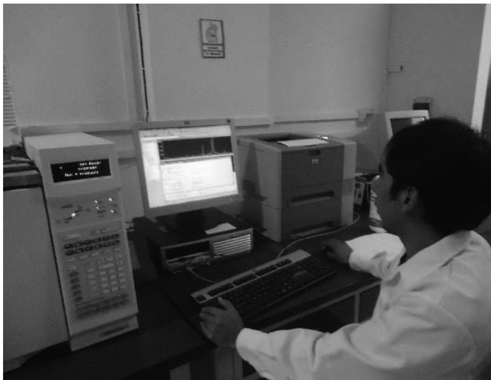
Figura 23. Analizando los componentes químicos del aceite esencial de S. brevicalyx mediante Cromatografía de Gases acoplado a Espectrometría de Masas. Laboratorio de Cromatografía de la UNSAAC – Cusco.
