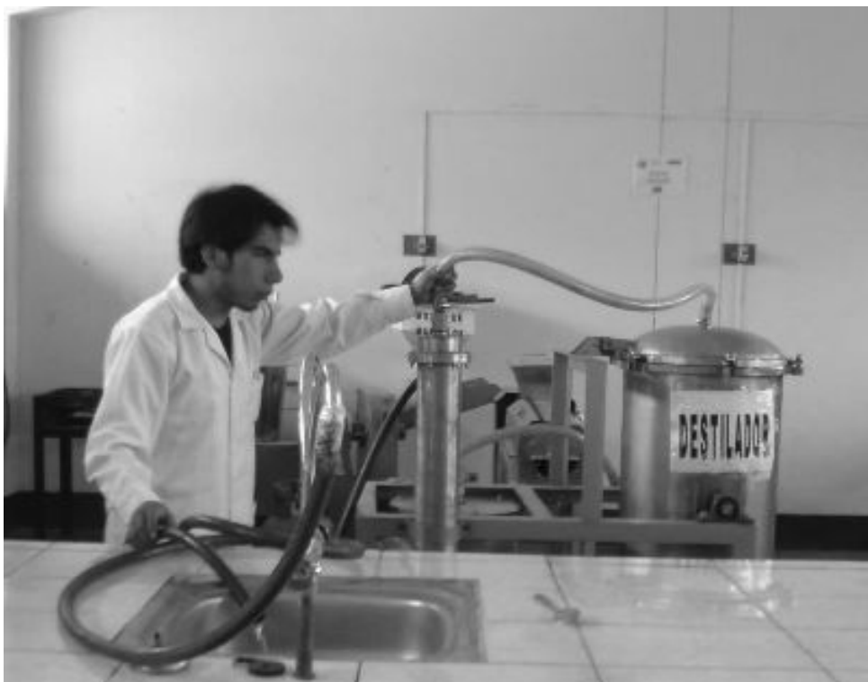
Figura 19. Destilación del aceite esencial de Satureja brevicalyx mediante arrastre por vapor de agua. Laboratorio de la DIREPRO – Apurímac.
