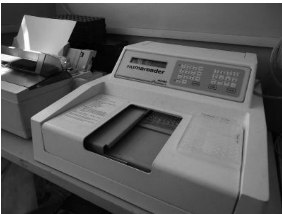
Figura 28. Lectura de placas de microdilución mediante lector ELISA. Laboratorio del Banco de Sangre del Hospital Guillermo Díaz de la Vega, Abancay - Apurimac.
