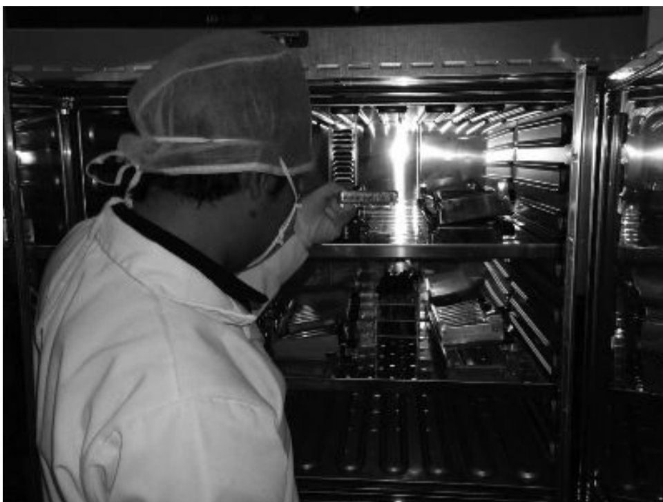
Figura 27. Placas de microdilución ensayadas ingresando a incubador para poner a prueba el efecto antibacteriano del aceite esencial de S. brevicalyx . Lab. Referencial de Salud Pública de la DIRESA – Apurimac.
