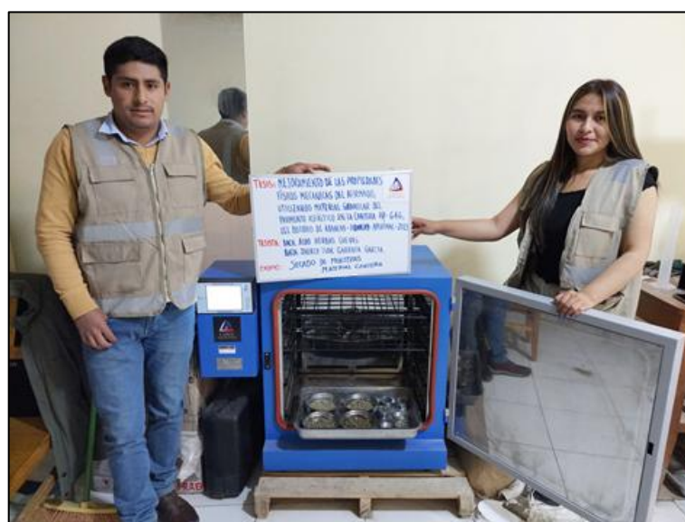
Figura 134 — Secado de muestras en horno.
