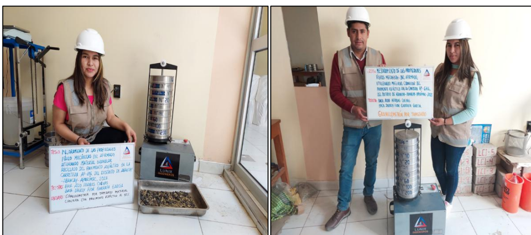
Figura 132 — Análisis granulométrico mediante tamizadora mecánica
