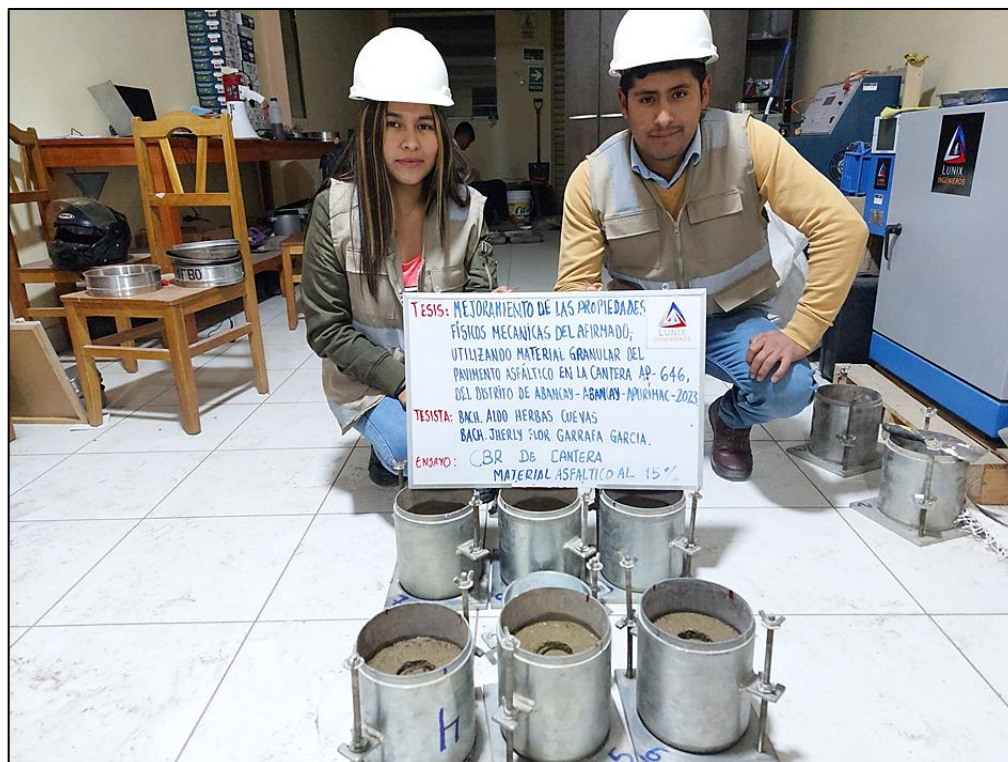
Figura 148 — Culminación de penetración de la muestra con adición de RAP al 15 %
