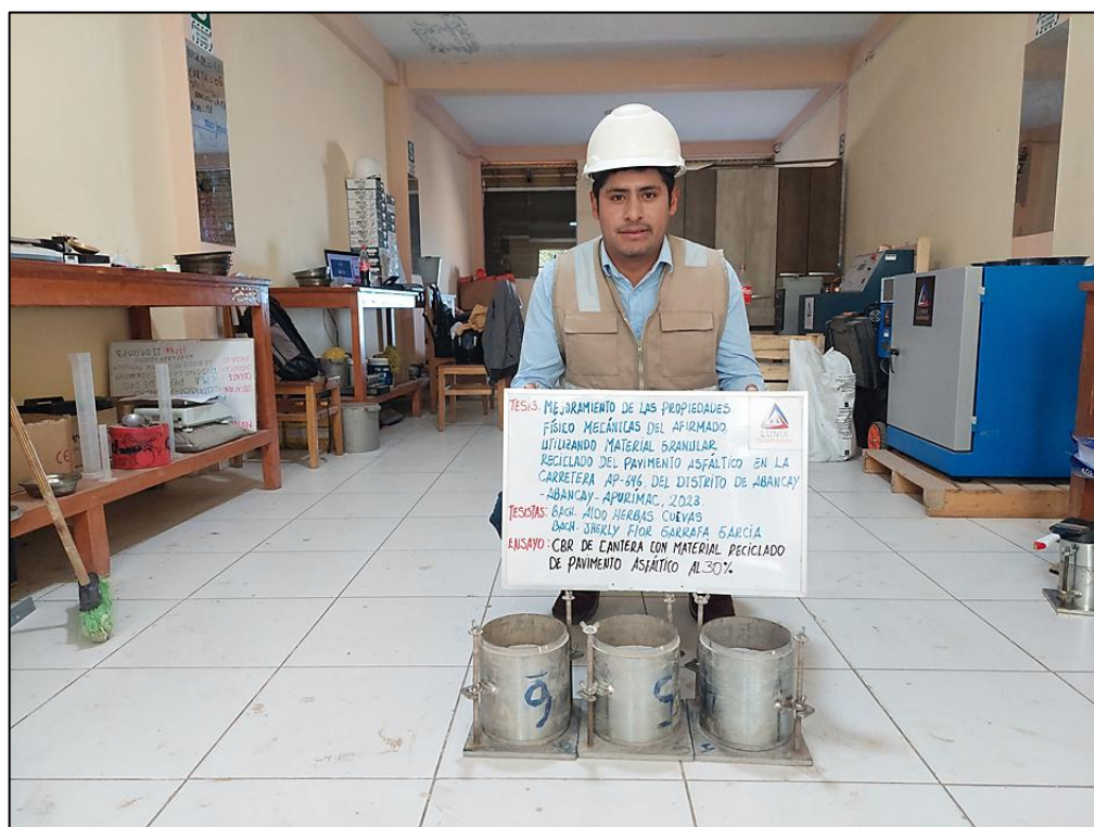
Figura 151 — Compactación de la muestra con adición de RAP al 30 %
