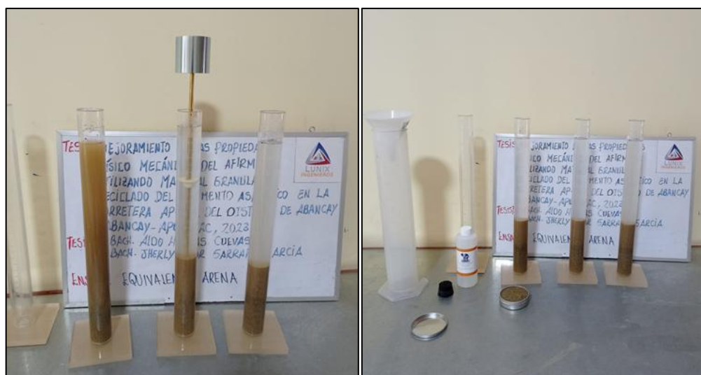
Figura 135 — Ensayo de equivalente de arena
