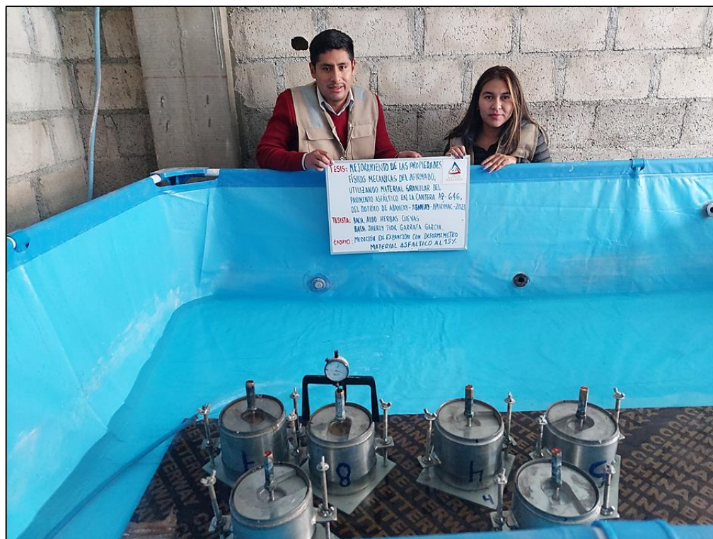
Figura 146 — Inmersión de muestras en un tanque de agua
