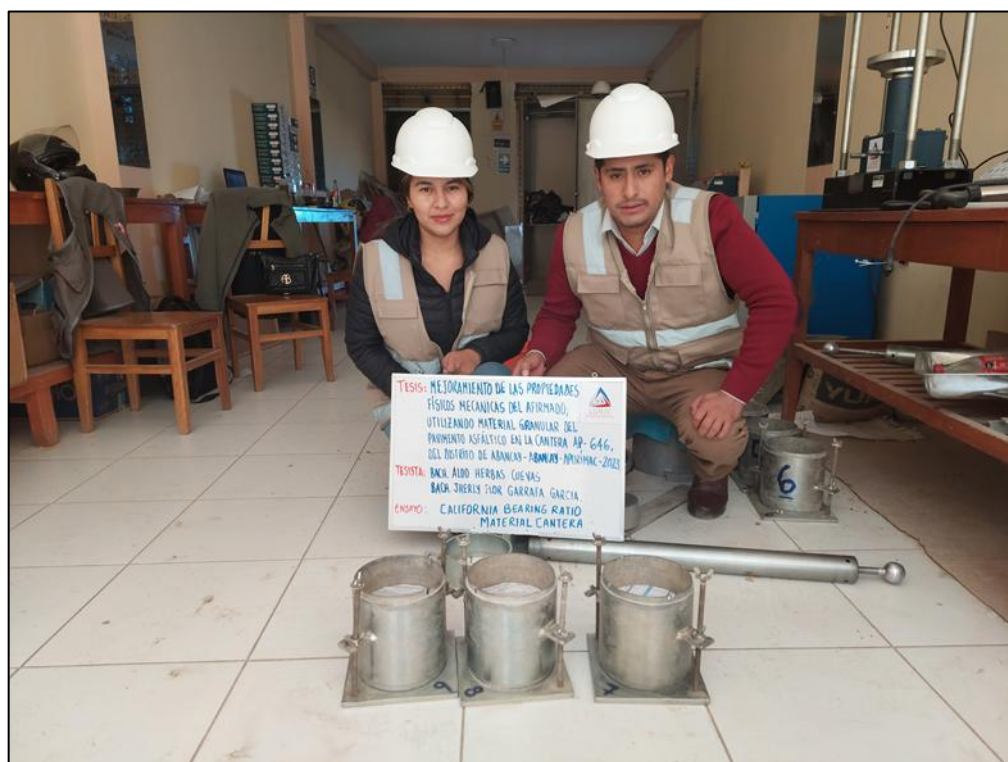
Figura 141 — Compactación de la muestra con adición de RAP al 0 %
