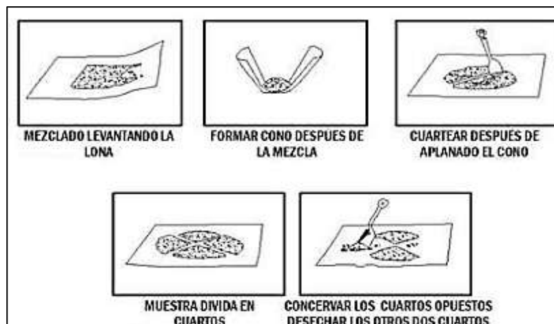
Figura 6 — Cuarteo de muestras sobre una lona
