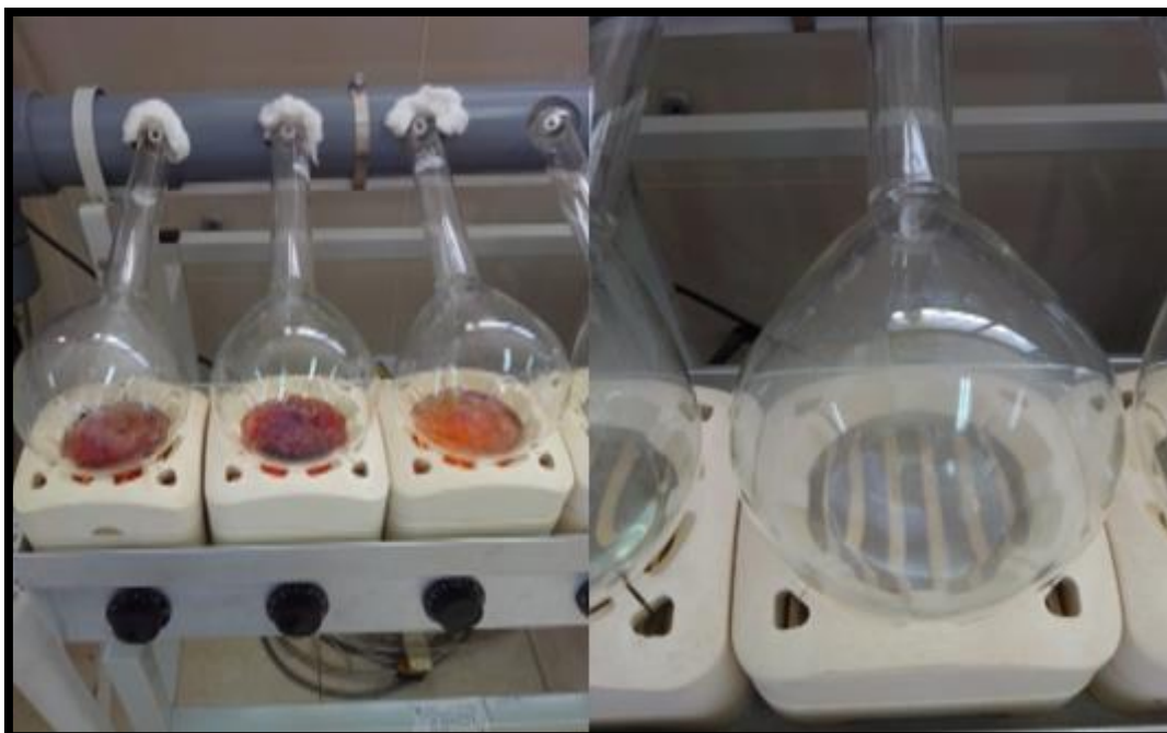
Figura 31 — Digestión intermedia y terminada de las muestras
