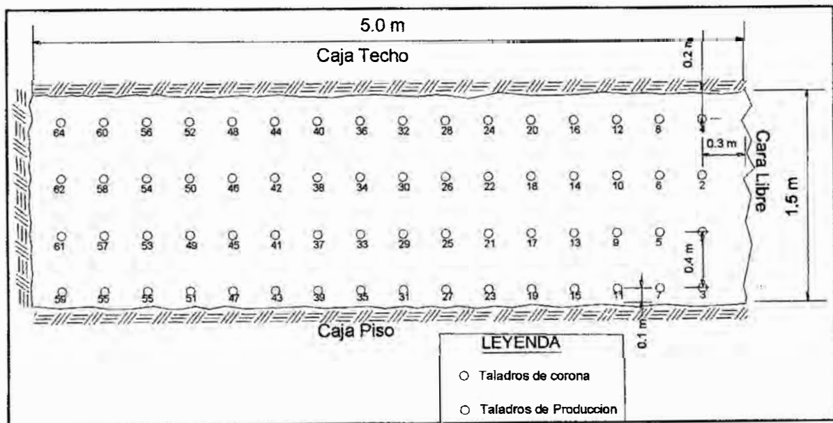
Figura 3.11: Esquema de distribución de los taladros de perforación para roca buena en el método Long Wall Mining (Fuente: Elaboración Propia)
