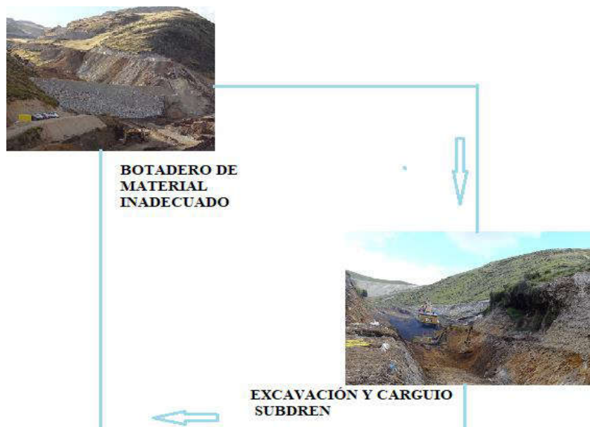
Figura 31. Diagrama de circuito de acarreo de material de corte de subdren a botadero
