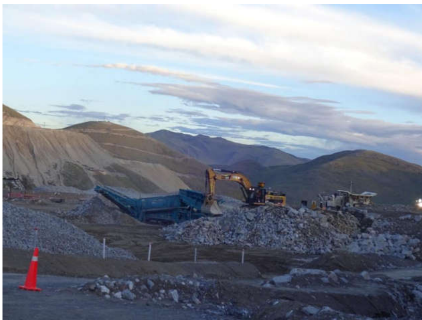
Imagen 2. Excavadora hidráulica de orugas CAT 345 CL
