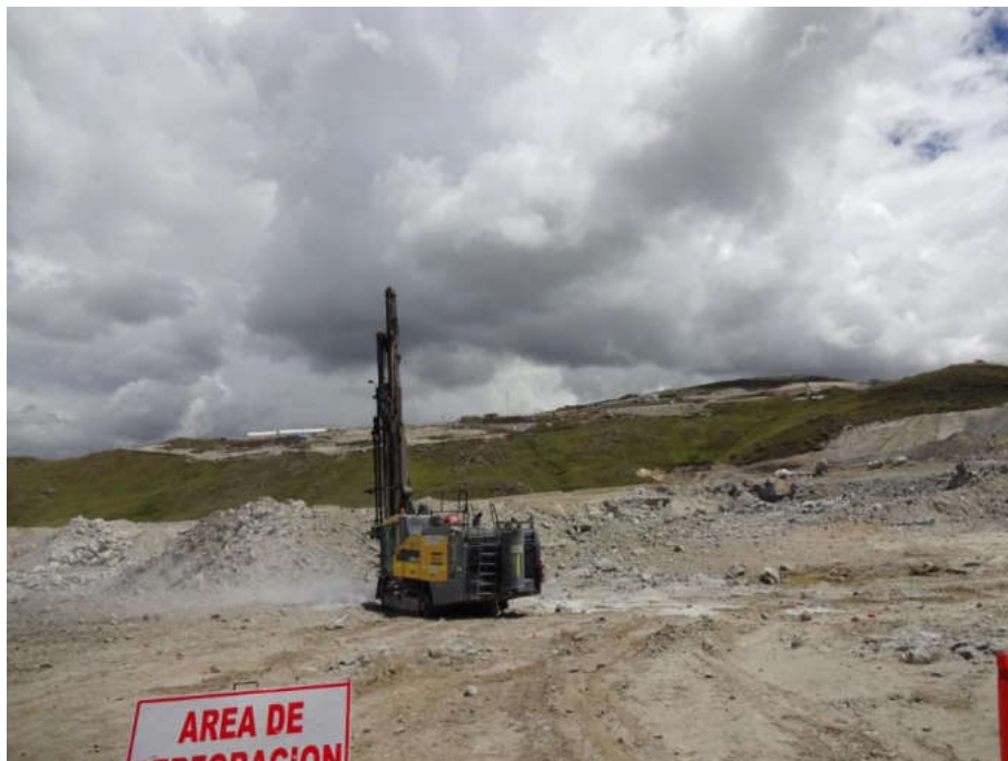
Imagen 7. Perforadora hidráulica Atlas Copco Rock L8
