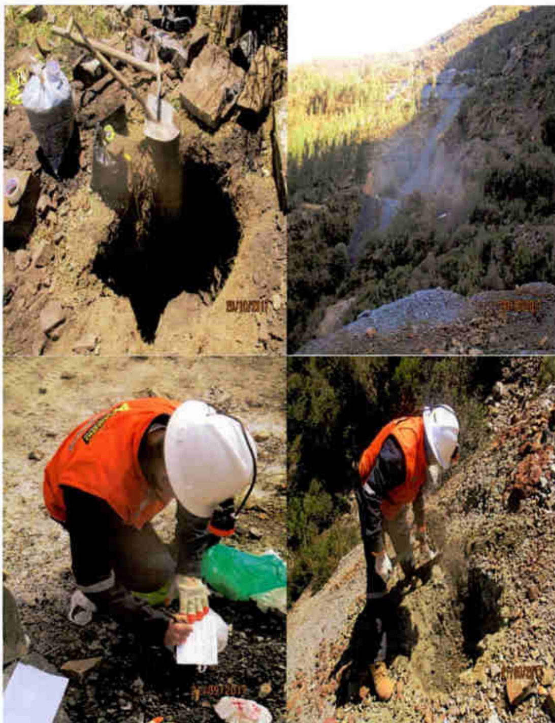
Figura VI.3:(Parte superior) Calicata de muestreo en el punto central y panorama de evacuación indiscriminada de material estéril. : (Parte inferior) : Identificación de muestras y calicata de muestreo del material estéril Fuente: Elaboración propia.
