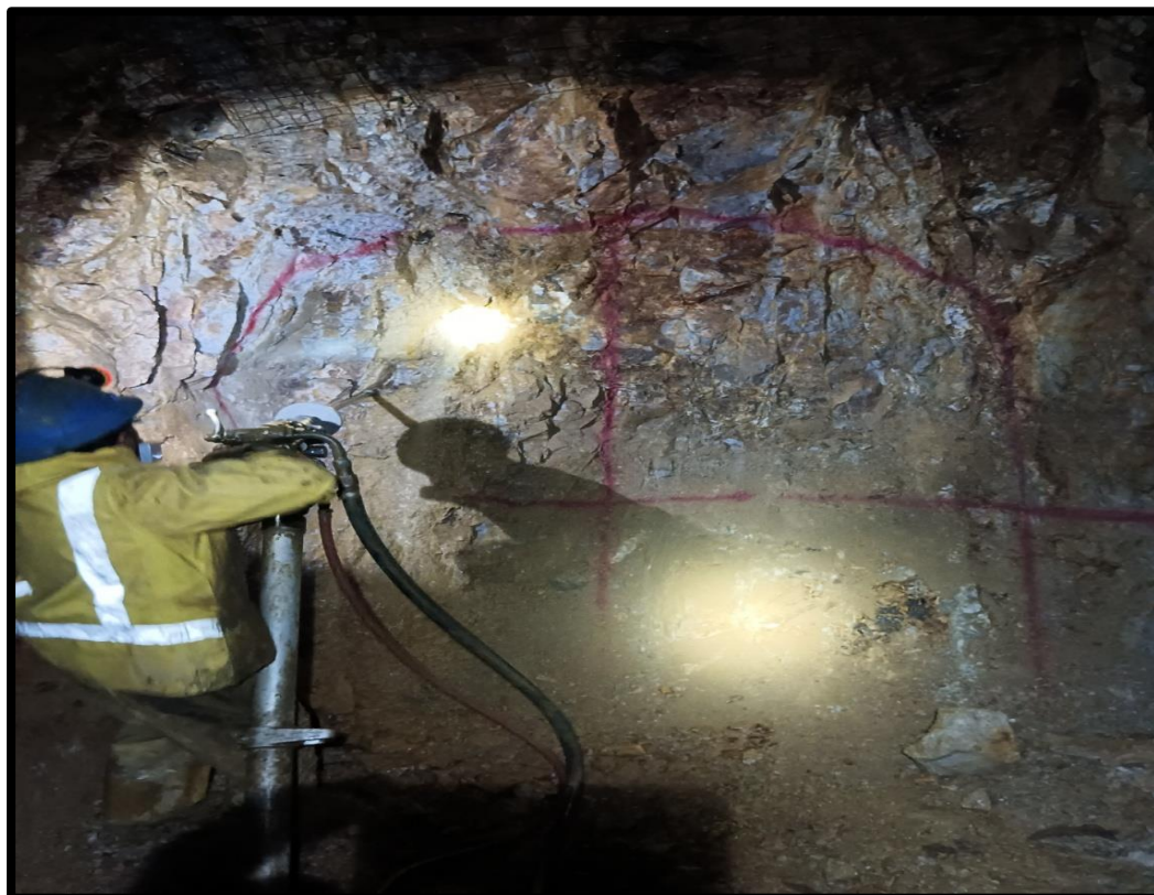
Figura 24 — Perforista realizando la perforación antes del diseño de malla.
