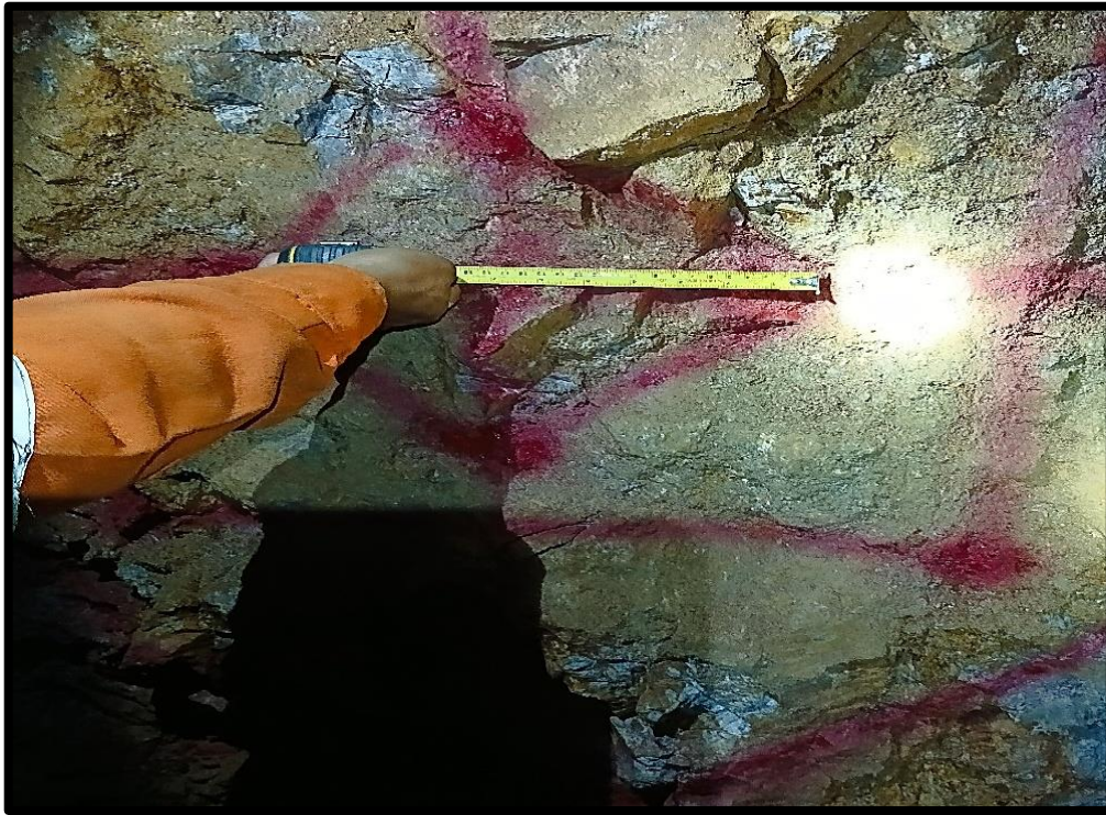
Figura 28 — Realizando la medición del burden y espaciamiento con los trazos.
