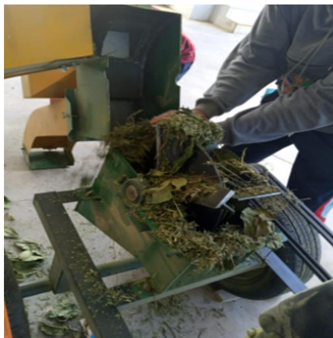
Figura 2. Elaboración de la harina de pisonay con molino tipo martillo
